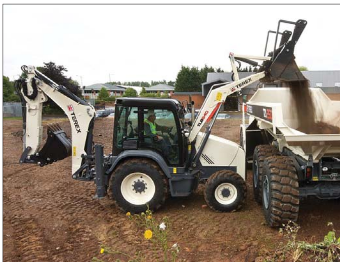
Nową koparko-ładowarkę wyposażono w specjalnie wyprofilowany wysięgnik ładowarkowy. Rozwiązanie to umożliwia efektywny i szybki załadunek pojazdów
