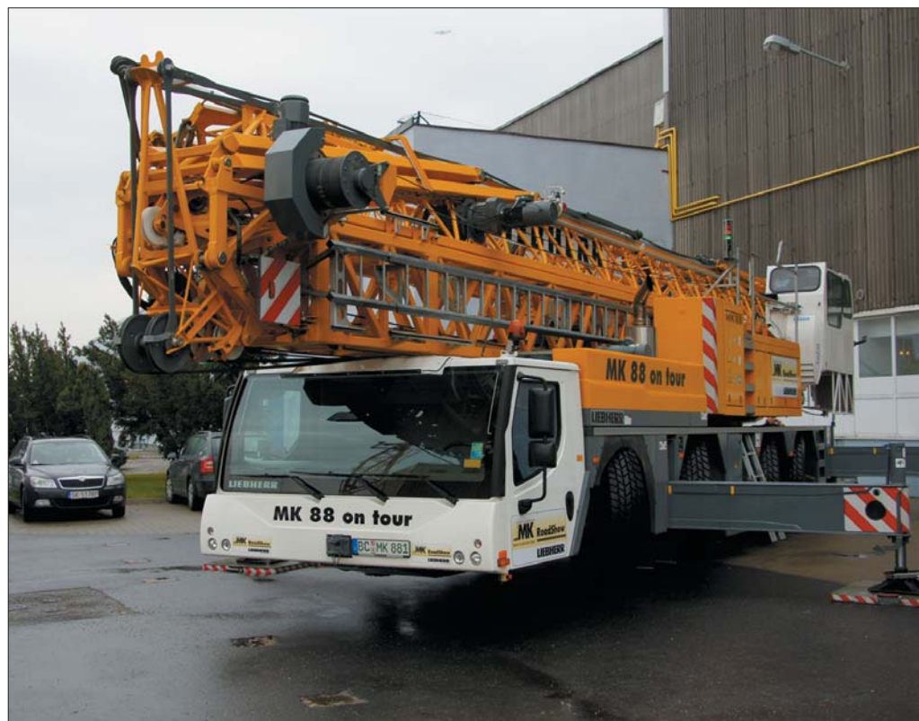
Mobilny żuraw MK 88 cechuje najwyższa mobilność i zwrotność. Osiągnięto ją dzięki przemyślanej konstrukcji podwozia z ograniczoną do niezbędnego minimum liczbą elementów ograniczających manewr skrętu pojazdu
