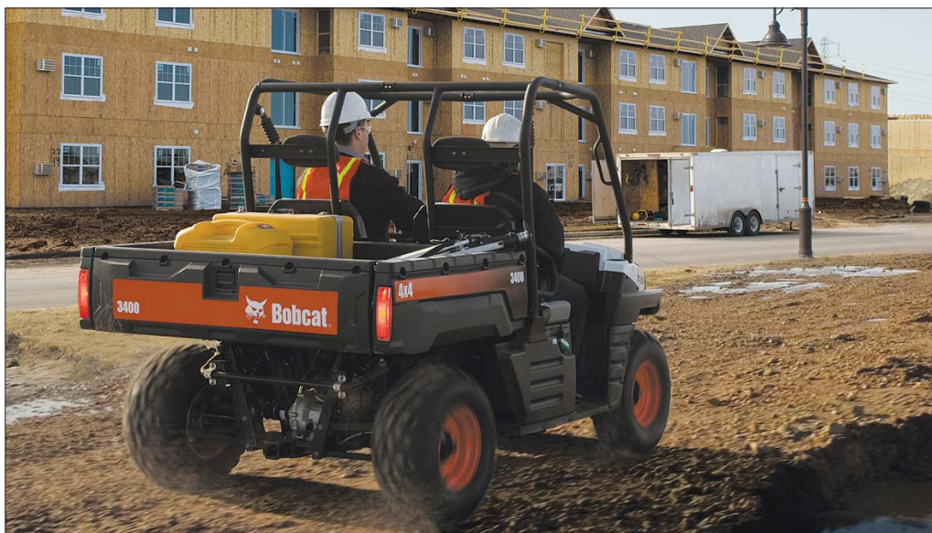
Pojazd może przewieźć 500 kg ładunku w wykonanej z materiałów kompozytowych skrzyni ładunkowej. Jest ona odporna jest na uszkodzenia mechaniczne i nie ulega korozji
