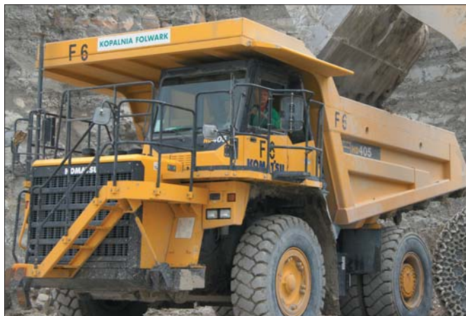
Wozidła eksploatowane w kopalni Folwark są standardowo wyposażone w wagę sygnalizującą operatorowi ładowarki moment pełnego dociążenia pojazdu
