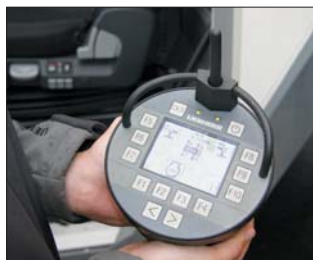
Podstawą bezpiecznej pracy jest wypoziomowanie i zbalansowanie żurawia. Poprawność ustawień można sprawdzić na ekranie
