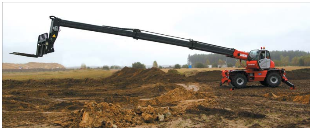
MRT2150 Privilege wyposażona jest w wysięgnik teleskopowy, dzięki któremu jest w stanie podnieść ładunek o ciężarze maksymalnym do pięciu ton na wysokość do dwudziestu jeden metrów
