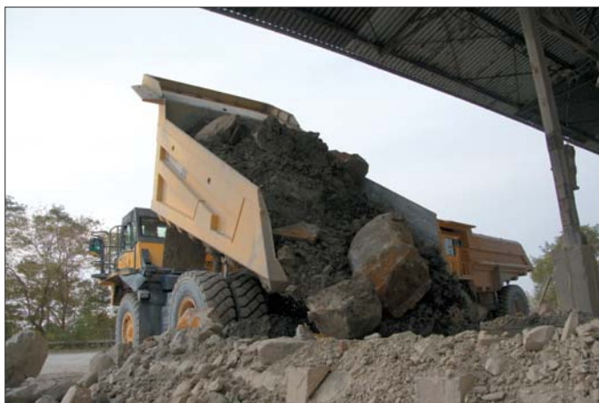
W celu osiągnięcia nominalnego obciążenia maszyny burty w skrzyni ładunkowej zostały podwyższone o dwadzieścia centymetrów
