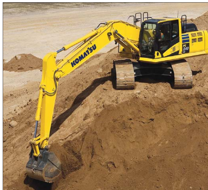
Koparki gąsienicowe Komatsu poddane zostały gruntownej modernizacji wynikającej z konieczności dostosowania ich do aktualnych norm dotyczących emisji spalin...
