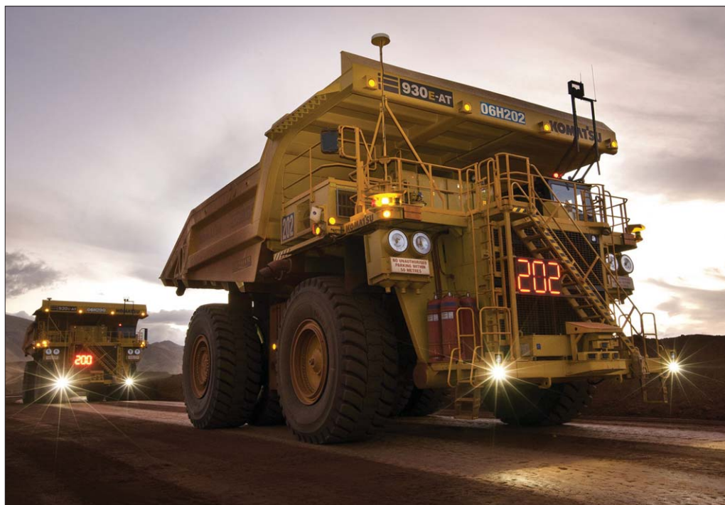
Samosterujące wozidła sztywnoramowe Komatsu przesyłają informacje pochodzące z własnych czujników do centrum sterowania (OC), które je rejestruje, przetwarza i analizuje, a następnie odsyła instrukcje określające kurs i prędkość jazdy
