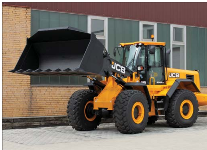
Ładowarka kołowa JCB 456e ZX standardowo wyposażona jest w łyżkę o pojemności 3,5 m 3
