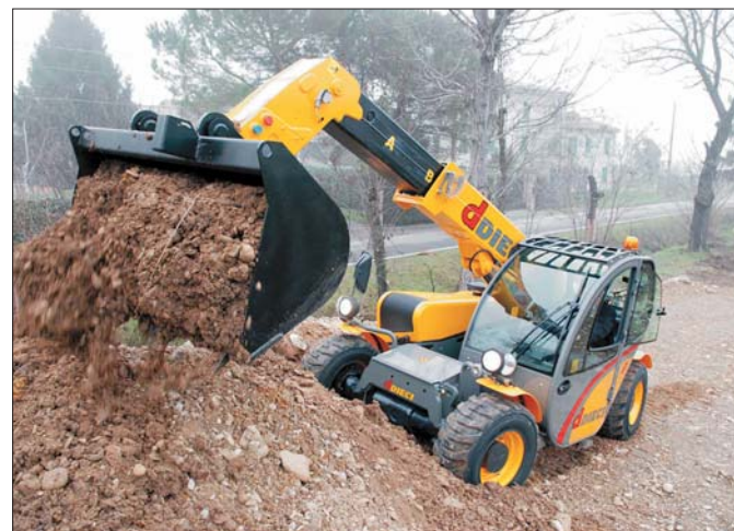
Podstawowy osprzęt podnośników teleskopowych stanowi łyżka
