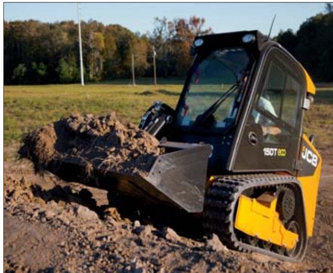
Jako jedyny producent JCB wyposaża swoje miniladowarki w jednoramienny wysięgnik montowany na boku, co znacznie poprawia widoczność z kabiny
