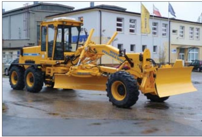
Napęd kół przedniej osi firmy Poclain Hydraulics pełni funkcje pomocnicze podczas pracy w ciężkich warunkach terenowych
