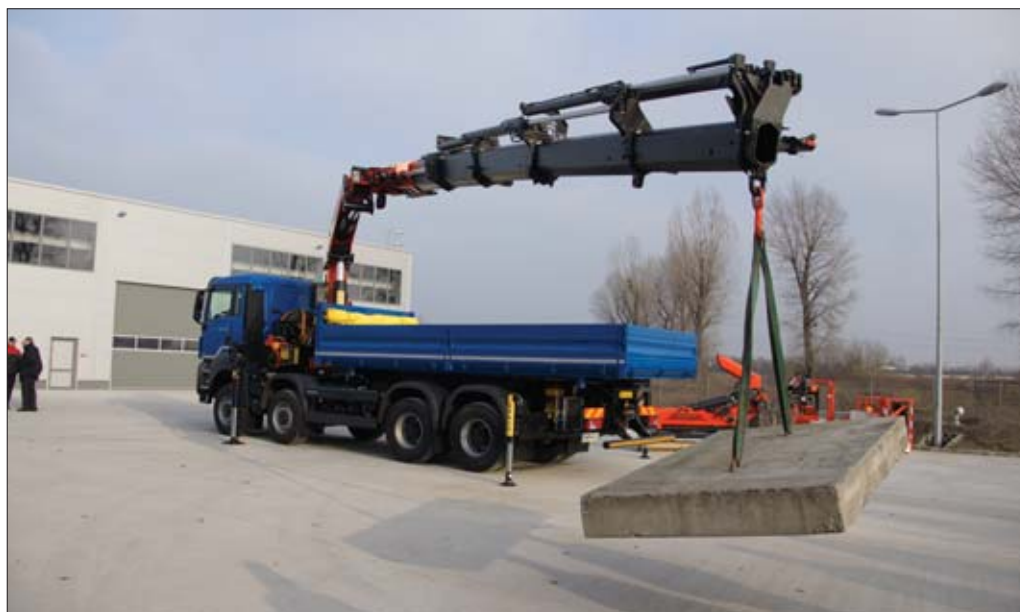
Zastosowanie czujników przemieszczeń rozstawienia podpór umożliwia w pełni dowolne podparcie pojazdu. Dzięki temu możliwe jest wyznaczenie bezpiecznego maksymalnie dopuszczalnego pola pracy żurawia dla dowolnej pozycji podparcia
