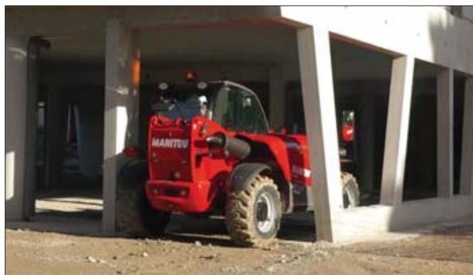
Niewielkie rozmiary i cztery skrętne koła MT 625 sprawiają, że ładowarkę można wykorzystywać w miejscach o bardzo ograniczonej przestrzeni manewrowej
