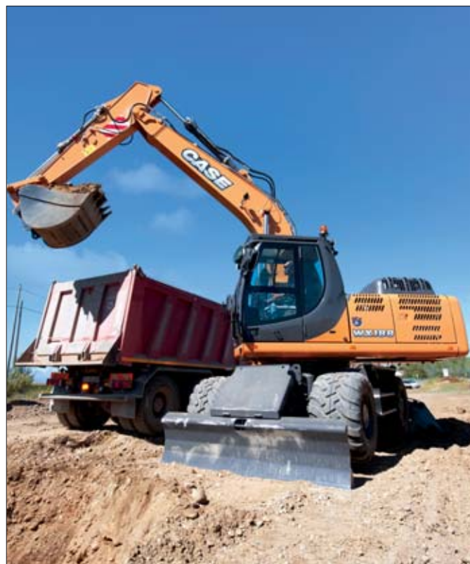
W nowych koparkach kołowych CASE zastosowano zmodernizowane kabiny, nowy panel sterowania i wytrzymałsze podwozie. Pozwoliło to zwiększyć komfort operatora, ułatwić obsługę, naprawy i przeglądy oraz ograniczyć koszty bieżącej eksploatacji
