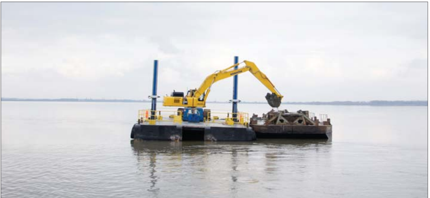
Tak prezentuje się jedna z bardziej nietypowych odkrywek, jakie odwiedziliśmy na przestrzeni ostatnich szesnastu lat. Zadaniem operatora koparki jest usunięcie nadkładu z pokładów żwiru. Warstwa górna jest usuwana, tak by z wydobyciem poradzić mogła sobie pogłębiarka
