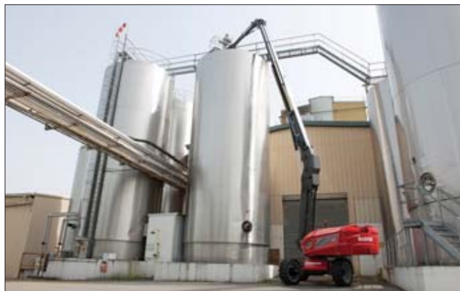
Długie, teleskopowe ramiona pozwalają docierać wszędzie tam, gdzie dostęp jest utrudniony lub dla maszyn innego typu wręcz niemożliwy.
