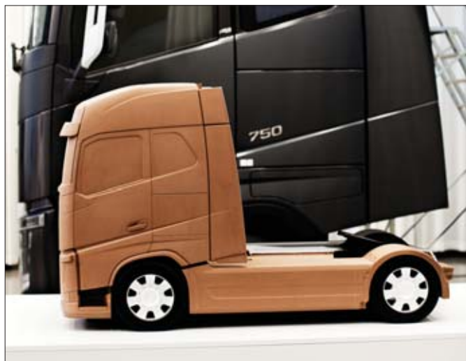
Aby uzyskać perfekcyjny produkt projektanci pracowali z modelami glinianymi, zarówno naturalnej wielkości, jak i w mniejszej skali
