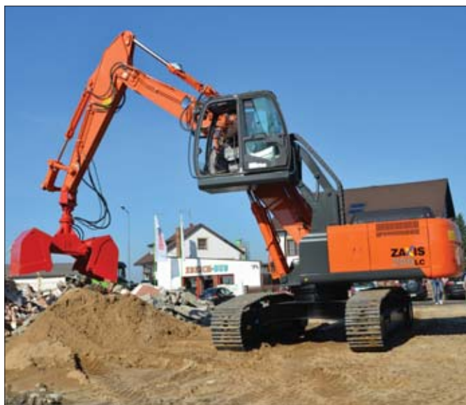
Koparka gąsienicowa Hitachi ZX280LC-3 wyposażona w hydraulicznie podnoszoną kabinę zapewniającą operatorowi optymalną widoczność podczas prac przeładunkowych
