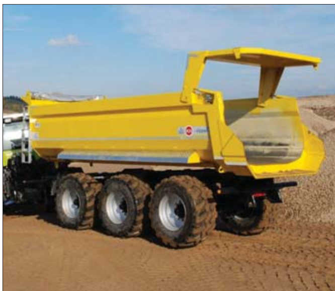
Przyczepa posiada trzy osie BPW o nośności 11 ton każda. Dwie osie skrętne zmniejszają zużycie ogumienia i zwiększają zwrotność pojazdu
