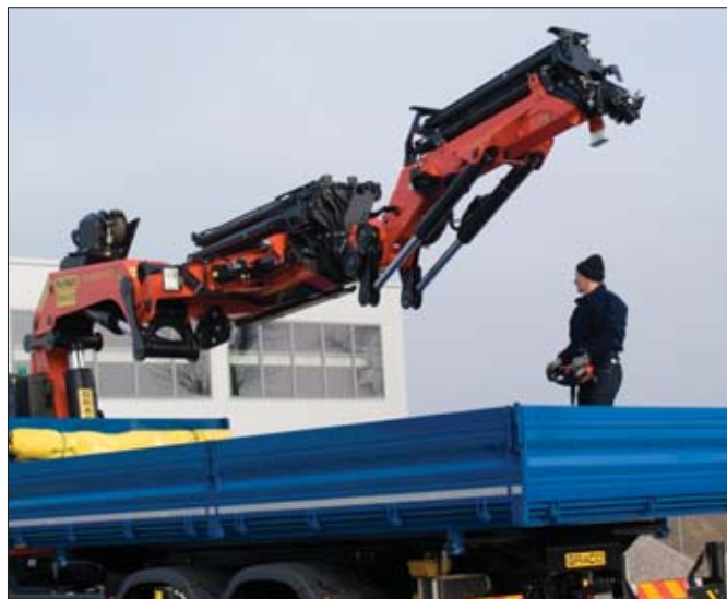
Operator żurawia wyposażonego w układ HPSC może w każdej chwili odczytać aktualny stan podparcia na wyświetlaczu w kabinie lub pulpicie zdalnego sterowania
