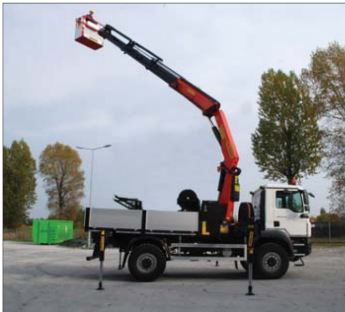
Żuraw w pozycji roboczej z koszem montażowym umożliwiającym bezpieczne wykonywanie prac na wysokości
