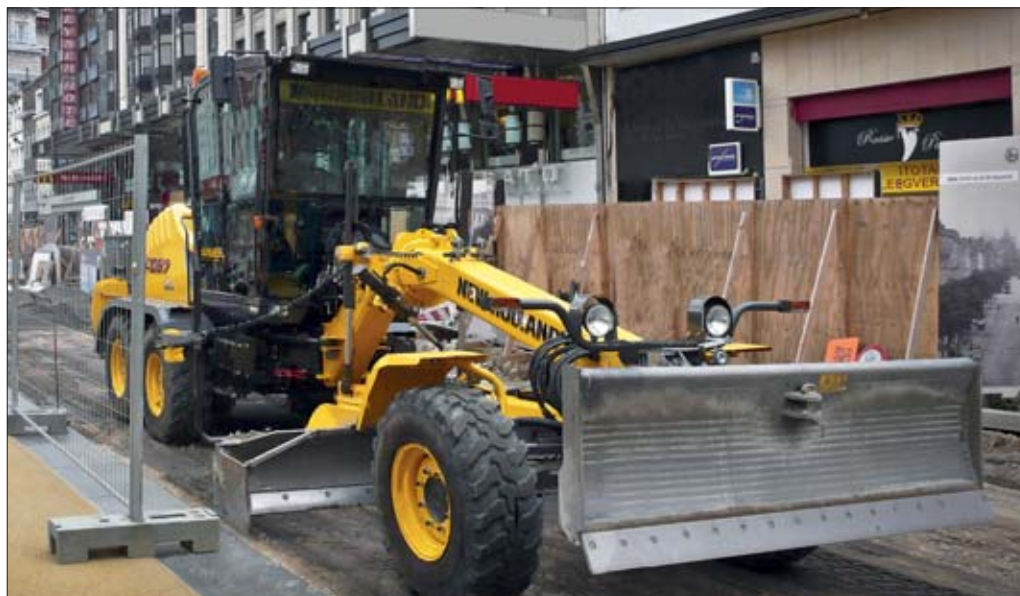
Równiarkę New Holland F106.7 (12 t) zaprojektowano z myślą o wykorzystaniu na małych i średnich placach budowy
