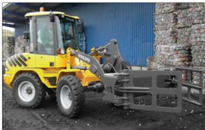
Ładowarka kompaktowa Volvo L30B Pro wyposażona została między innymi w chwytak o specjalnej konstrukcji służący do przemieszczania sprasowanych odpadów
