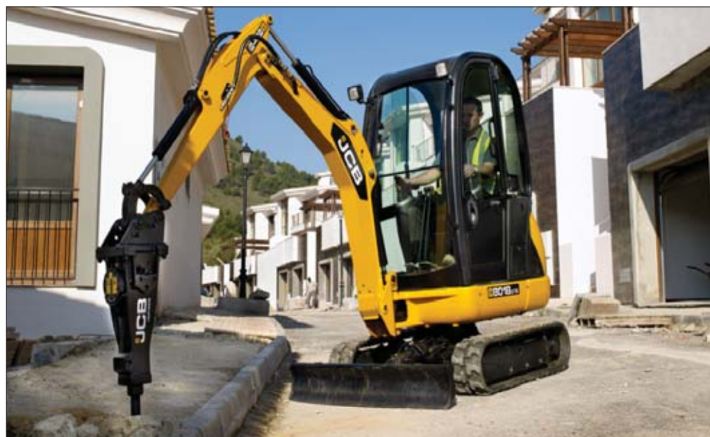
Nowe minikoparki JCB to nie zabawki. Maszyny radzą sobie w różnych zastosowaniach, na przykład podczas prac z użyciem zasilanego z dodatkowego obwodu młota hydraulicznego
