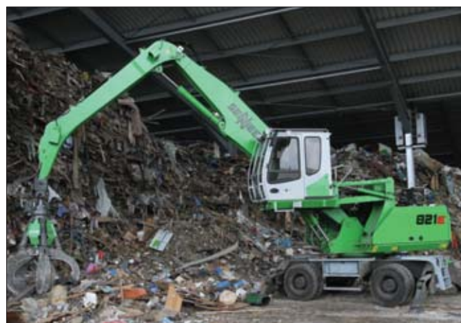
Sennebogen 821 M jest bardzo zwrotny i kompaktowy, dlatego nadaje się idealnie do pracy w mało przestronnej hali, w której zorganizowano prowizoryczne zwałowisko
