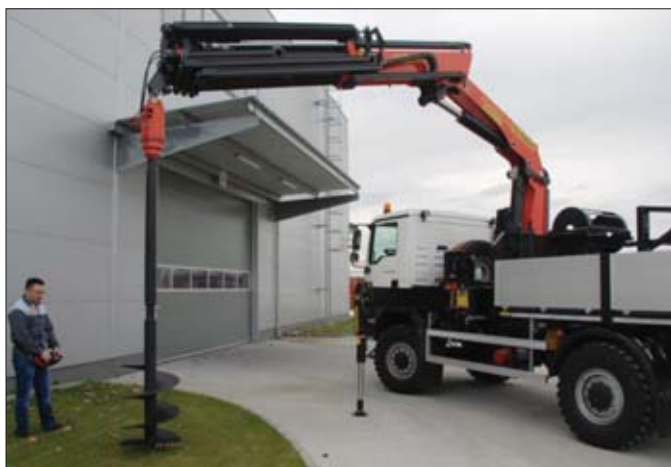
Żuraw w pozycji roboczej ze świdrem ziemnym. Operator wykorzystuje układ zdalnego sterowania drogą radiową
