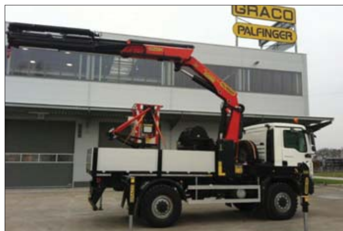
Żuraw Palfinger PK27002-SH w pozycji roboczej z hakiem ładunkowym. Przygotowanie urządzenia do pracy nie zabiera wiele czasu
