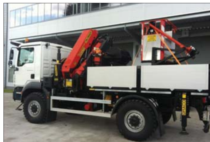
Pojazd dla branży energetycznej na podwoziu MAN TGM 18.250 z zabudową skrzyniową i żurawiem Palfinger w położeniu transportowym
