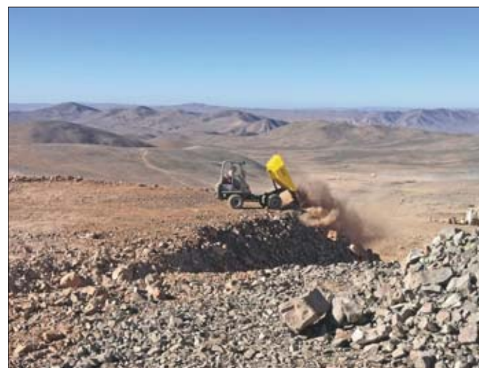
Duży prześwit i hydrostatyczny napęd sprawiają, że wozidło Wacker Neuson 3001 radzi sobie doskonale nawet w najtrudniejszych warunkach terenowych
