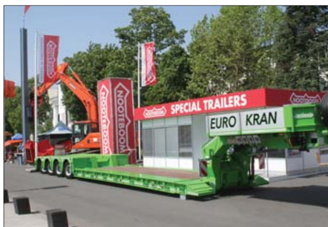
Naczepy tzw. tiefbety zazwyczaj mają odpinaną „łabędzią szyję”, dzięki czemu wjazd samobieźnego sprzętu odbywa się od przodu pojazdu
