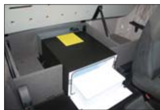
Leżanka jest unoszona i przytrzymywana za pomocą sprężyn gazowych. Kryją się pod nią trzy schowki o regularnym kształcie i dużej pojemności
