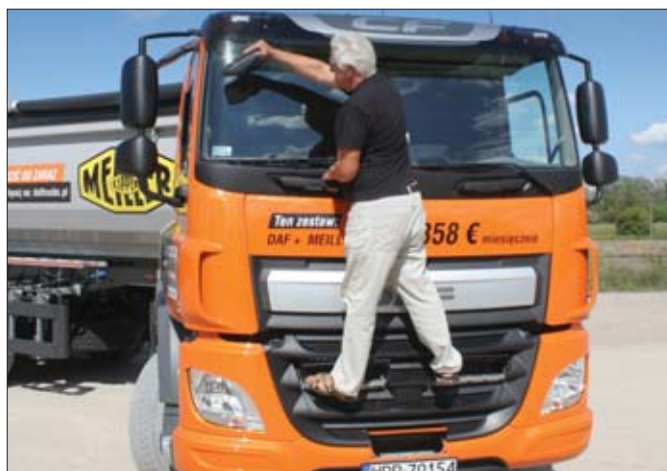
W przedniej atrapie chłodnicy po mistrzowsku wkomponowano rozkładane stopnie wejściowe ułatwiające dostęp do naroży szyby, wycieraczek i lusterka czołowego
