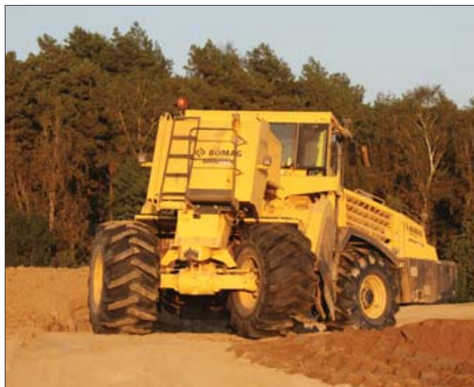
Połączenie tylnej osi skrętnej z przegubową konstrukcją podwozia zapewnia niski promień zawracania, co ułatwia manewrowanie maszyną na ograniczonej przestrzeni
