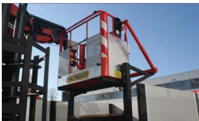
Specjalny stelaż zamontowany na obrotnicy umożliwia jednocześnie przewożenie słupów energetycznych oraz kosza roboczego
