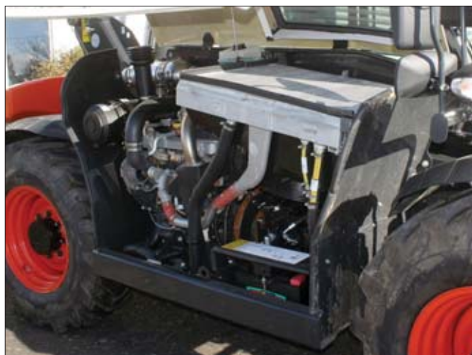
Wysoko umieszczona chłodnica w mniejszym stopniu ulega zanieczyszczeniu, a jeśli już do tego dojdzie, łatwo przywrócić jej nominalną skuteczność poprzez załączenie odwrotnego ciągu wentylatora
