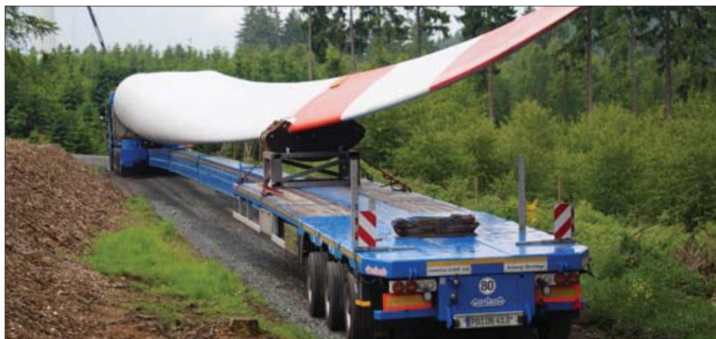
Transport śmigieł elektrowni wiatrowych wymaga specjalnych rozwiązań. Skrętne osie naczepy umożliwiają „narzucenie” tylnego czlonu zestawu, a tym samym dojazd w trudno dostępne miejsca
