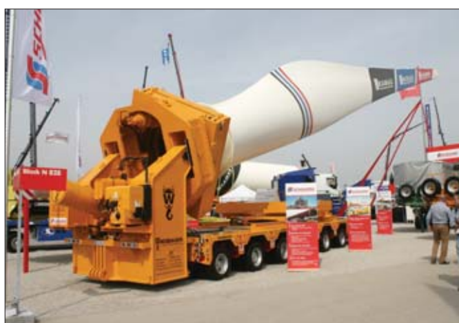
Taki sposób transportu łopat śmigieł elektrowni wiatrowych zapewnia mniejszą długość zestawu i pozwala na łatwe omijanie przeszkód
