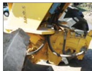
Hydrostatyczny napęd kół nie tylko upraszcza budowę maszyny, ale pozwala też na płynną, bezstopniową regulację prędkości jazdy
