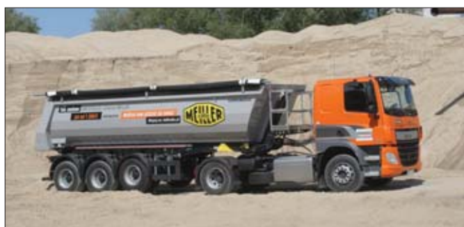
Naczepa F.X. Meiller ma profilowane ściany boczne, górny pas wzmacniający i jest wykonana z wysokojakościowych stali, co gwarantuje niską masę własną, a jednocześnie dużą wytrzymałość konstrukcji
