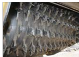
Bęben ma średnicę zewnętrzną 1.416 mm i jest wyposażony w 212 frezów. Operator może regulować jego prędkość w zakresie 104÷140 obr./min
