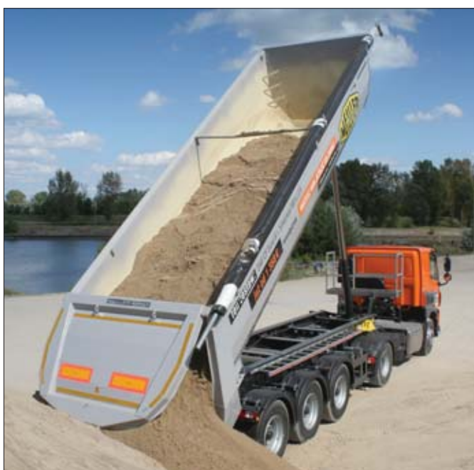
Układ hydrauliczny testowej naczepy został w całości wyprodukowany przez firmę F.X. Meiller, dzięki czemu ma wysoką jakość i łatwiej go serwisować
