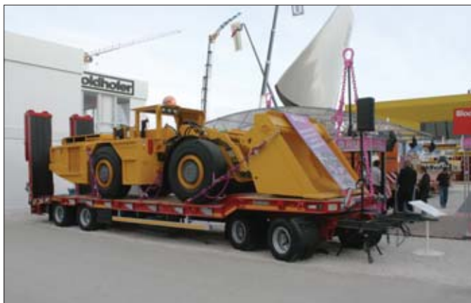
Przyczepy niskopodwoziowe zapewniają duże możliwości transportowe, a jednocześnie mają stosunkowo prostą konstrukcję i niską masę własną
