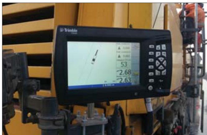
Jednostka sterująca Trimble CB460 wskazuje pozycję bębna w odniesieniu do projektu 3D przygotowanego w oprogramowaniu Business Center-HCE
