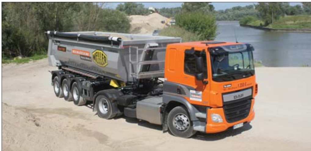
Testowany przez naszą redakcję DAF CF posiadał masę własną 7.133 kg, co przy masie własnej naczepy F.X. Meiller równej 6.500 kg oznacza dopuszczalną ładowność ponad 26.300 kg
