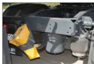
Tylna oś z czteremiechowym sterowanym elektronicznie zawieszeniem pneumatycznym zapewnia znakomite prowadzenie pojazdu
