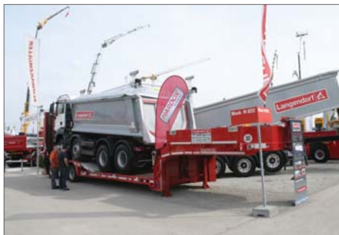
Załadunek maszyny samobieźnej albo pojazdu na naczepę z obniżonym pokładem może się odbywać również od tyłu za pomocą rozkładanych najazdów
