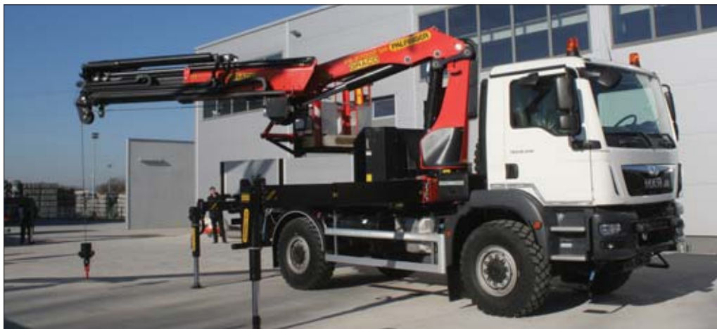
Zaprezentowany podczas „Dnia Otwartego” żuraw Palfinger PK27002-SH wyposażony został między innymi w system kompensacji liny, zapewniający stałą odległość haka od końca wysięgnika
