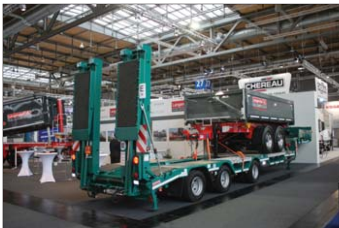
Praktycznym rozwiązaniem stosowanym w naczepach niskopodwoziowych są zagłębienia na koła pozwalające na obniżenie całkowitej wysokości zestawu
