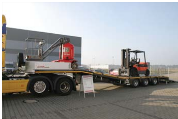
Hydraulicznie podnoszony dolny pokład w naczepie „semi” to bardzo wygodne rozwiązanie przy załadunku platformy umieszczonej nad siodłem ciągnika
