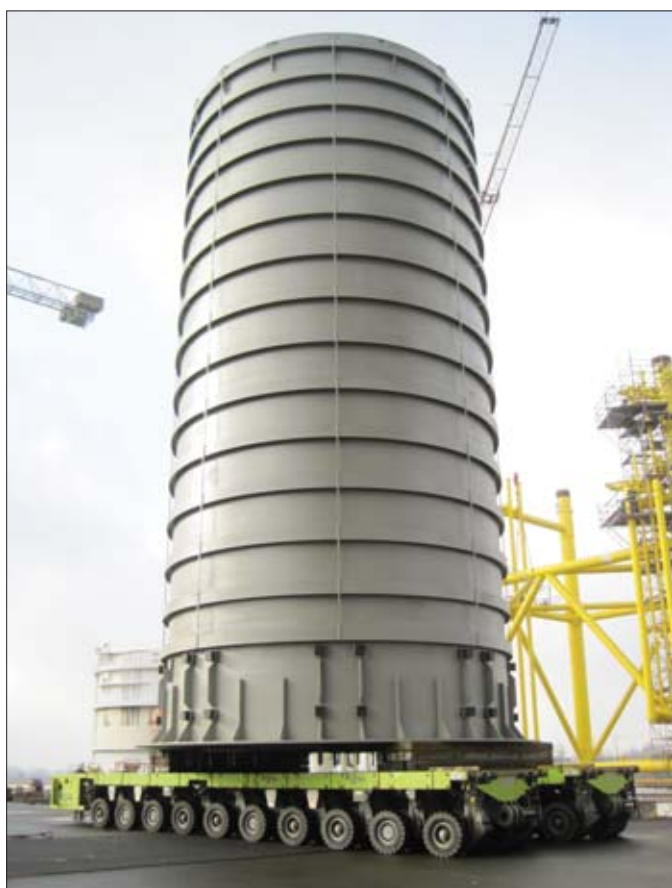
Zestawy modułowe często mają własny napęd, co eliminuje konieczność stosowania ciągnika balastowego i ułatwia manewrowanie
