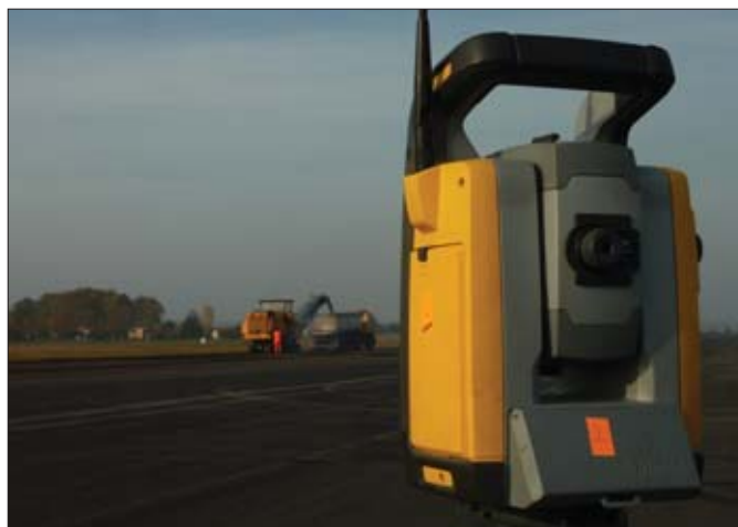
PCS900 wykorzystuje wiodący w branży tachimetr Trimble SPS930 Universal Total Station oraz aktywne lustra instalowane na maszynie
