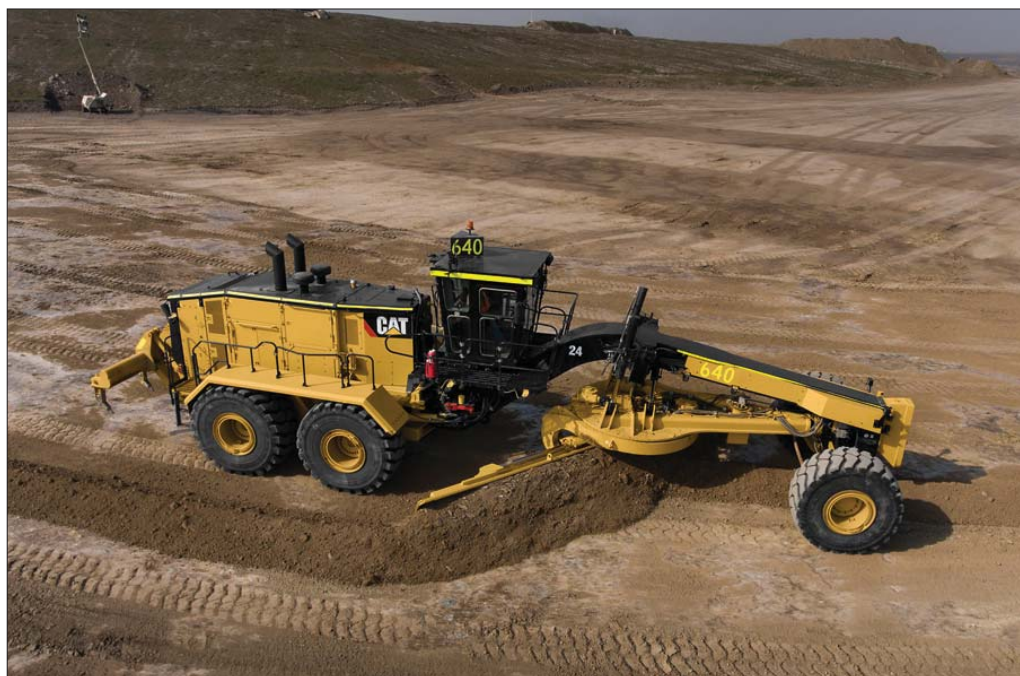
Dzięki technologii MineStar silnik równiarki jest przygotowany do pracy w najtrudniejszych warunkach. Maszyna została standardowo wyposażona w systemy Cat VIMS i Product Link Elite, które umożliwiają monitorowanie parametrów roboczych
