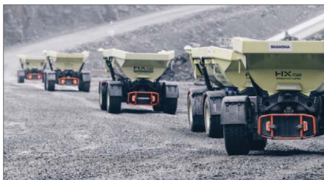
W projekcie Electric Site udział bierze osiem autonomicznych, napędzanych elektrycznie wozideł HX2, które transportują urobek do zespołu kruszarek stacjonarnych
