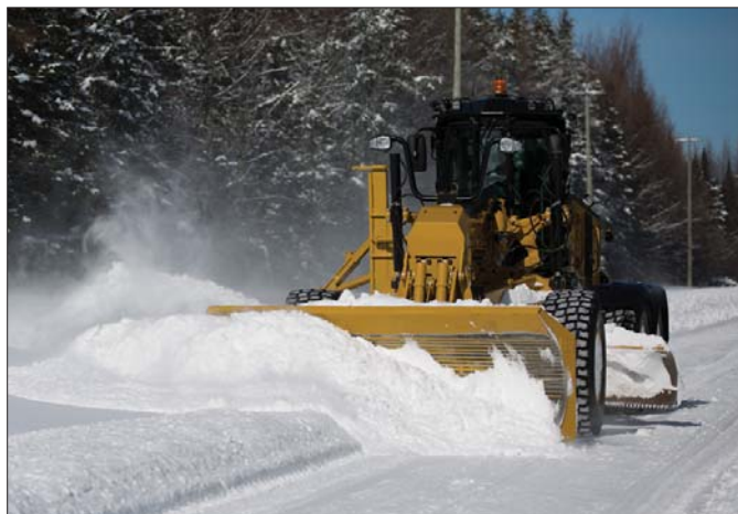
Mniejsze równiarki są bardziej uniwersalne, bo oprócz typowych zastosowań w drogownictwie można je wykorzystywać na przykład do odśnieżania
