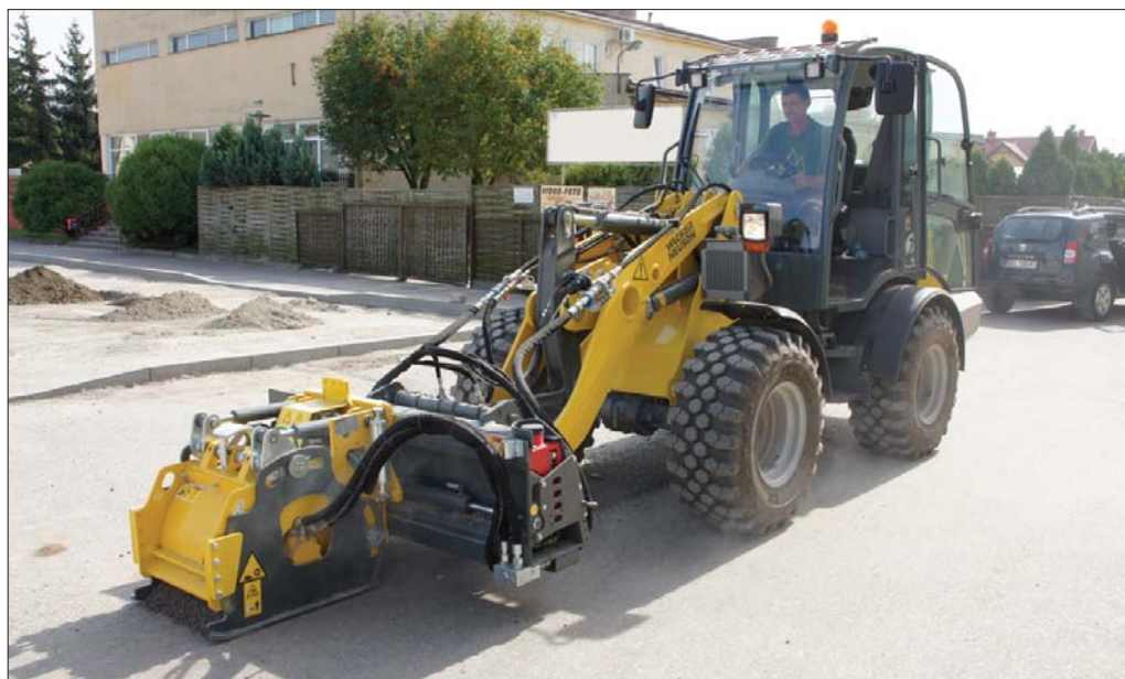
Podłączenie frezarki nie jest skomplikowane i odbywa się błyskawicznie. Operatorowi do całkowitego opanowania prawidłowego i efektywnego sterowania osprzętem roboczym maszyny wystarczy niedługie szkolenie
