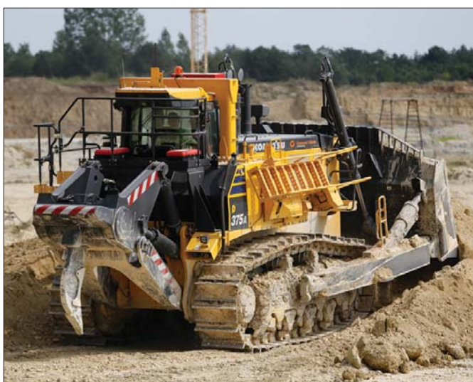
Zastosowanie rolek dopasowujących się do podłoża oraz gaśienic o szerokości 710 milimetrów znacznie ułatwiło maszynie sprawne przemieszczanie się po wyrobisku
