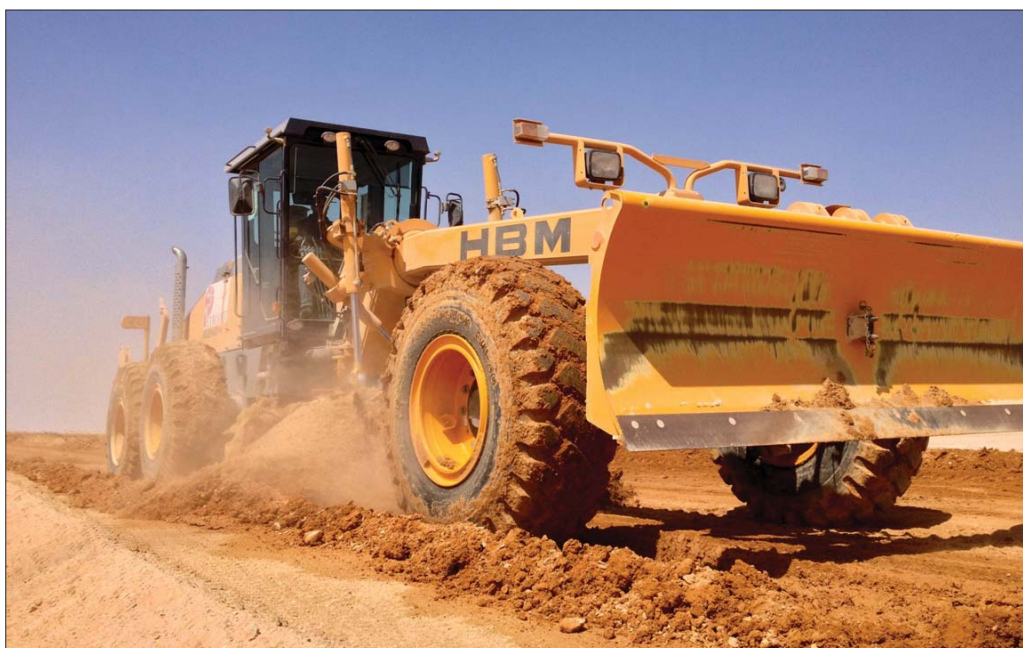
BG 240 to w chwili obecnej największa równiarka w ofercie firmy HBM-Nobas. Całkowity ciężar roboczy tej imponującej efektywności maszyny wynosi dwadzieścia trzy tony, a nacisk na tylną oś siedemnaście ton
