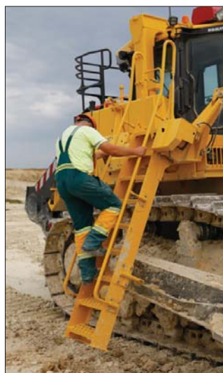
Dwa metry w górę! W bezpiecznym dotarciu do kabiny pomagają operatorowi automatycznie wysuwane schody
