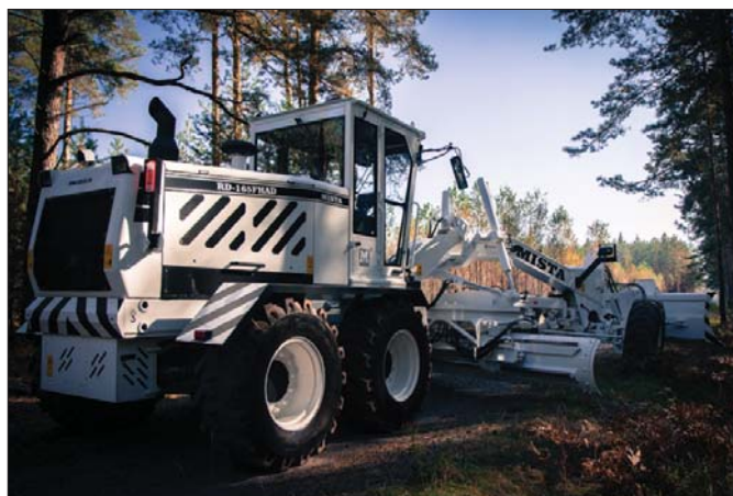
Hydrostatyczny układ napędu jazdy na wszystkie koła jest wprost nieodzowny podczas wykonywania zadań wymagających utrzymania stabilnej prędkości
