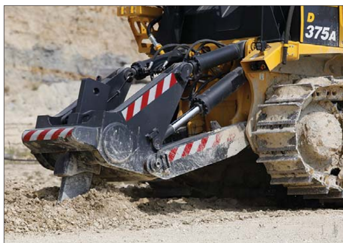
W kopalni odkrywkowej bardzo praktycznym osprzętem jest zrywak o dużej sile urabiania i możliwości bezstopniowego ustawiania kąta pracy
