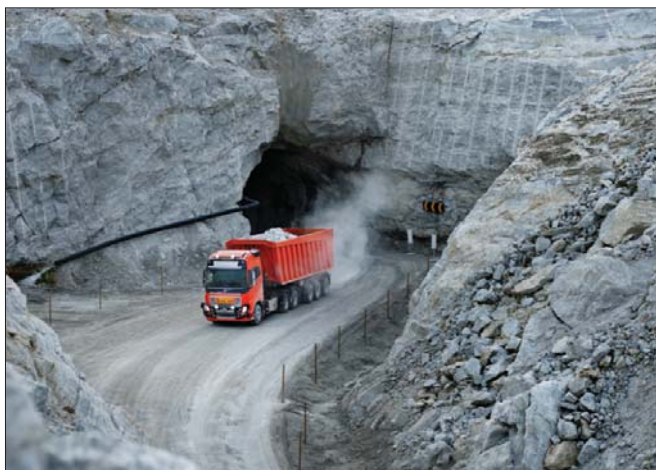
Trasa, którą poruszają się autonomiczne pojazdy, przebiega zarówno przez kopalniane drogi technologiczne, jak i tunele
