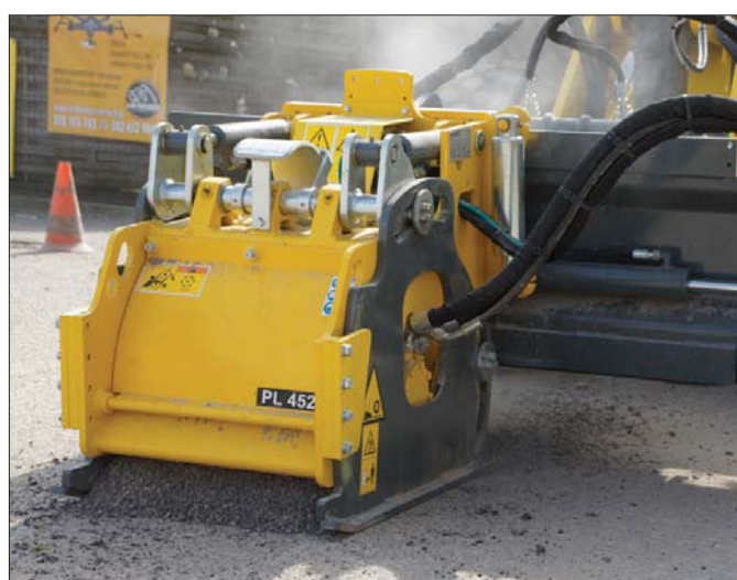
Instalacja frezarki na ładowarce jest niezwykle prosta i szybka. Jeden pracownik upora się z nią dosłownie w ciągu minuty
