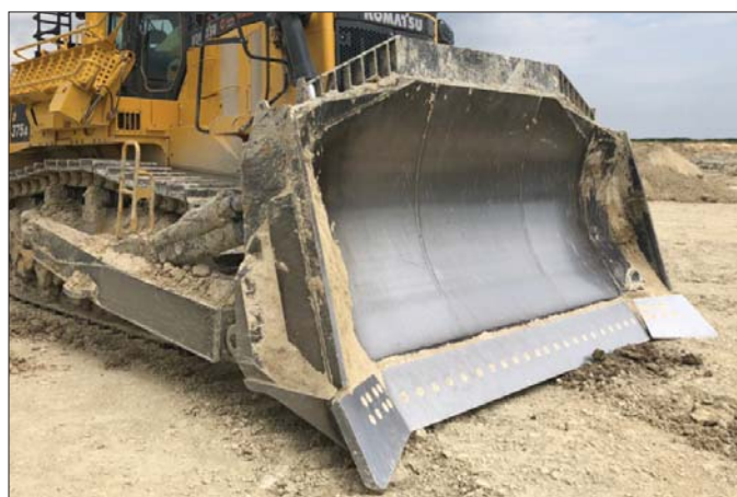
Maszyna wyposażona została w lemiesz typu „Semi U dual Tilt” o pojemności 18,5 metra sześciennego, który doskonale sprawdza się nawet w najtrudniejszych warunkach
