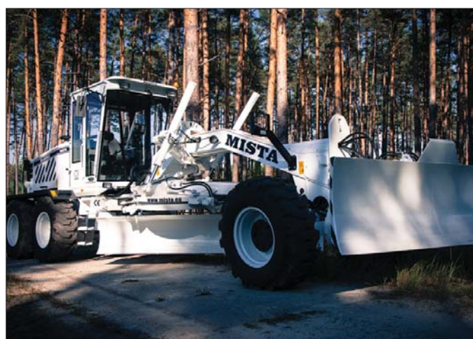
Hydrostatyczny układ napędu jazdy na wszystkie koła jest wprost nieodzowny podczas wykonywania zadań wymagających utrzymania stabilnej prędkości
