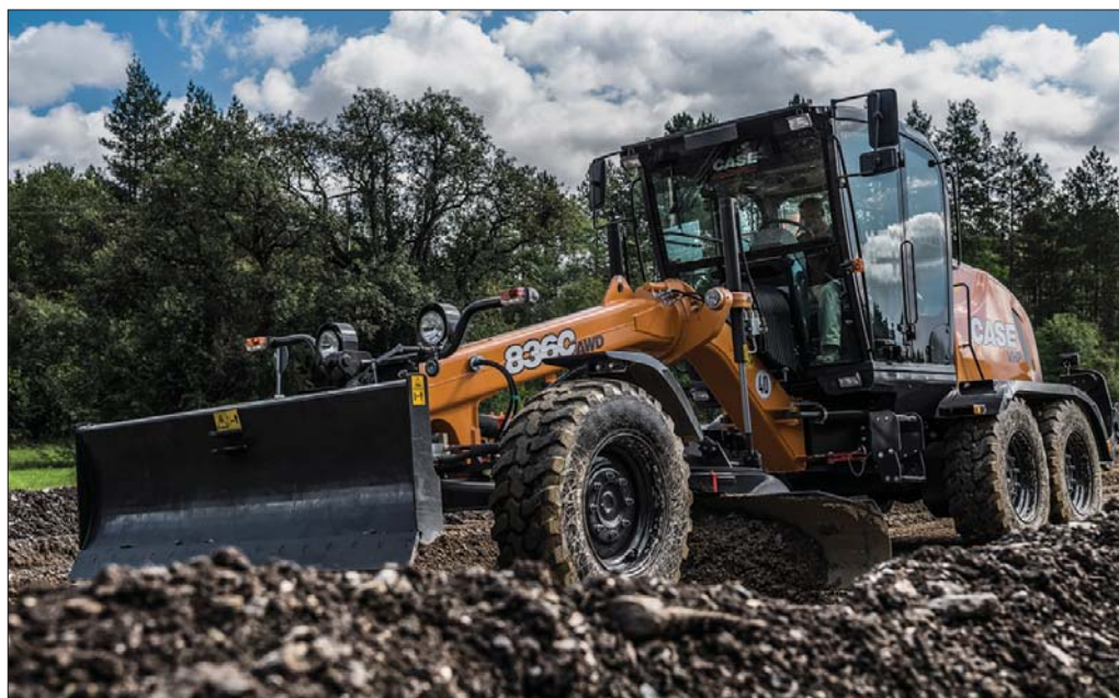
Opracowana przez inżynierów Case CE konstrukcja układu lemiesza środkowego umożliwia jego płynne i precyzyjne działanie. Pierścień obrotu jest wolny od luzów i wytrzymały na ekstremalne obciążenia mechaniczne
