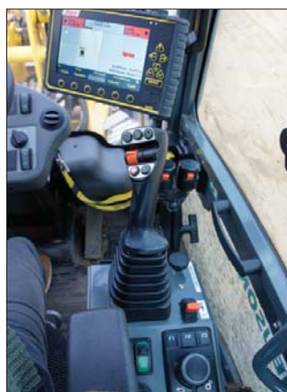
Dżojstik i pulpit sterowniczy jest zintegrowany z wygodnym fotelem. Operator wszelkie informacje o stanie prowadzonych robót śledzi w czasie rzeczywistym na kolorowym wyświetlaczu
