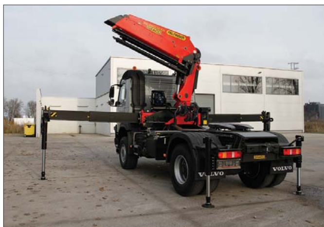
Stateczność pojazdu w czasie pracy żurawia zapewniają dwie pary podpór. Główne są zintegrowane z jego podstawą, a pomocnicze zamontowane na tyłe podwozia
