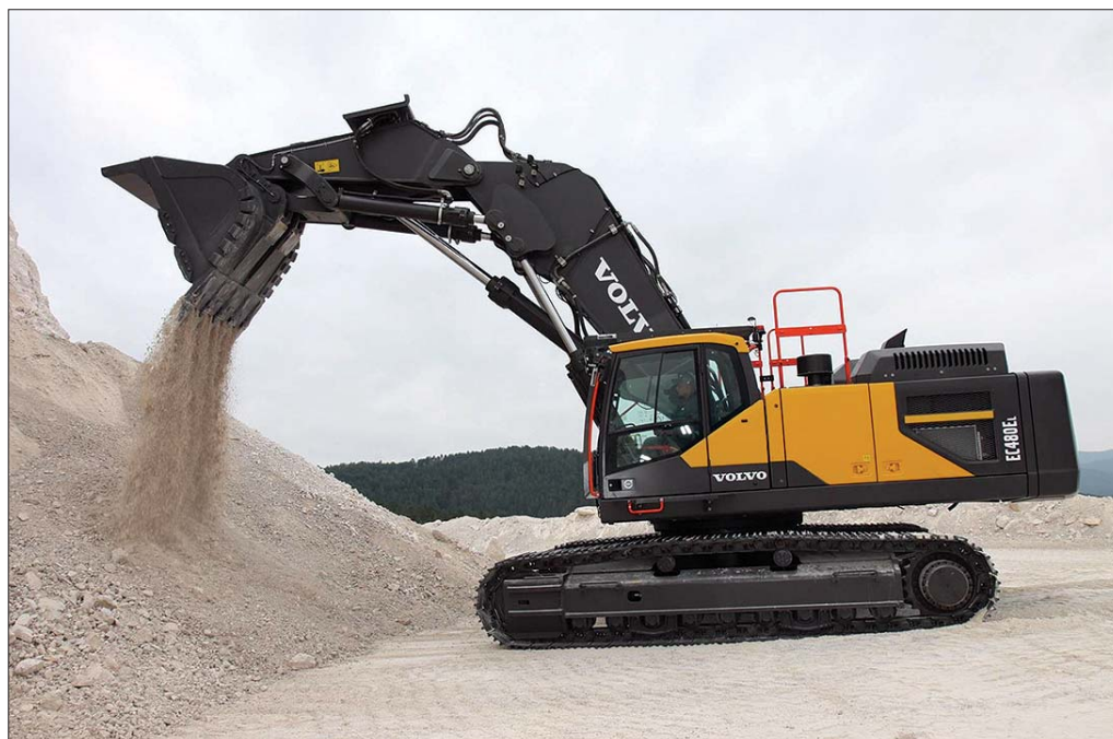
Konstruktorom koparki podsiębierniej EC480EL udało się wykorzystać wszystkie oryginalne podzespoły stosowane przez Volvo CE, w tym siłowniki hydrauliczne, sworznie, tuleje oraz układ połączeń śrubowych
