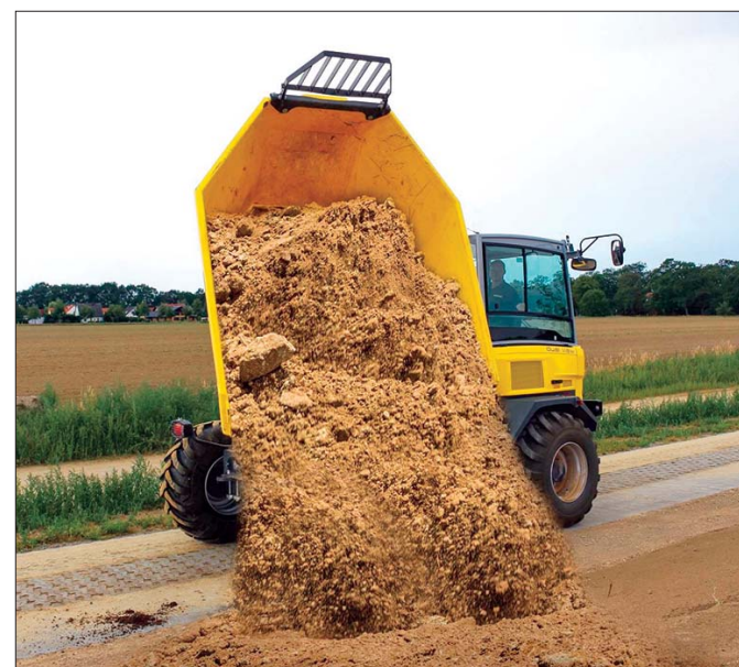
Skrzynię ładunkową można podczas jazdy obrócić na bok, tak by transportowany materiał mógł być w sposób kontrolowany wysypywany na pobocze wzdłuż trasy przejazdu
