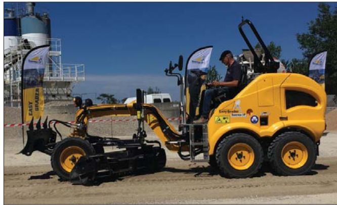
Zastosowany w minirówniarkach Easy Grader napęd tandemowy (6x4) ze sprzęgłem kłowym pozwala wykorzystywać je praktycznie w każdym terenie
