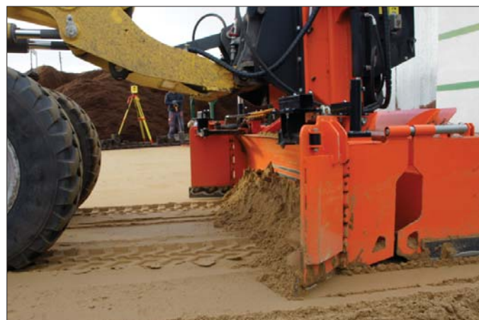
Leica Geosystems dostarcza oraz integruje z maszyną zarówno łąty niwelacyjne, jak i pozostałe elementy pomiarowe
