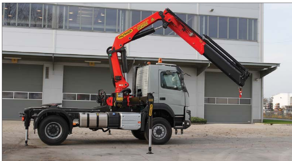
Dobry przykład możliwości produkcyjnych firmy stanowi zabudowa z wyposażonym w bezobsługowy system wysuwu sekcji wysięgnika żurawiem Palfinger typu PK26002-EH na podwoziu ciągnika siodłowego Volvo FMX 460
