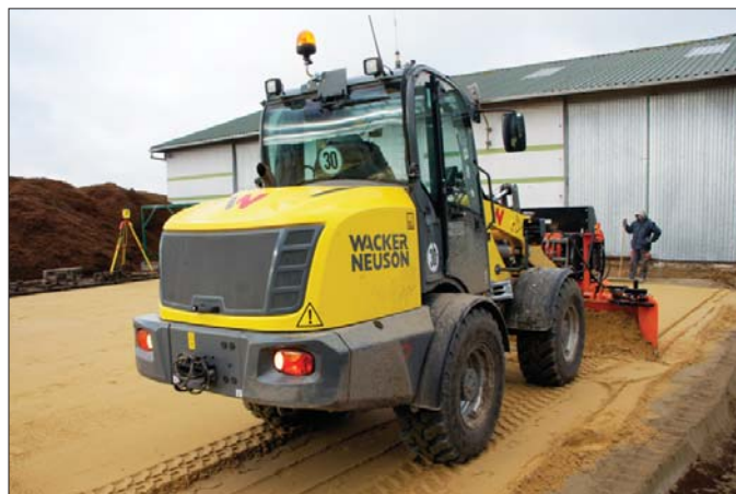
Zainstalowany na ładowarce system Leica usprawnia i przyspiesza pracę. Do uzyskania pożądanej niwelety wystarczy bowiem pojedynczy przejazd maszyny
