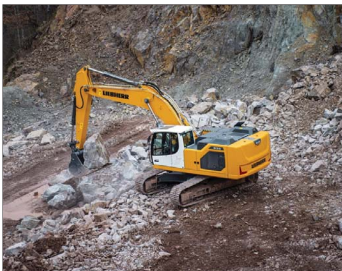
Wszystkie rodzaje podwozia, w które mogą zostać wyposażone nowe koparki gąsienicowe, zbudowane są na planie litery „X”, co zapewnia odpowiednią sztywność konstrukcji
