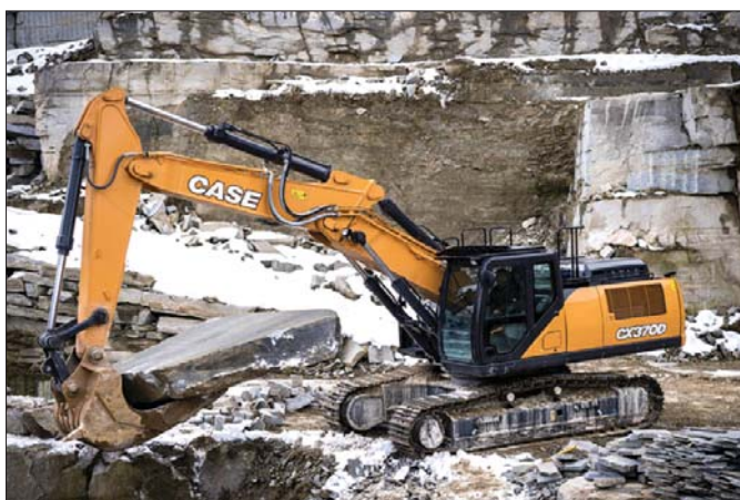
Głównym zadaniem operatora maszyny jest precyzyjne i szybkie przemieszczanie ważących kilkanaście ton bloków skalnych odspajanych od ściany metodą strzałową
