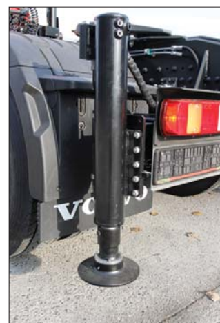
Konstrukcja tylnych podpór umożliwia pracę pojazdu ze zwykłymi naczepami
