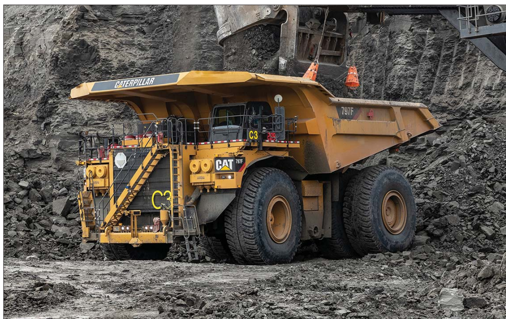
Praktyczne testy eksploatacyjne ciężkiego wozidła górniczego Cat 797F odbywały się w różnych miejscach, w tym w głębokiej odkrywkowej kopalni miedzi, rudy żelaza oraz odkrywki węgla kamiennego
