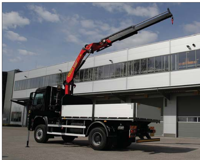
Integralną część zabudowy stanowi żuraw zakabinowy Palfinger PK 13.501K SLD 3 z kolumną obracaną w zakresie 420 stopni
