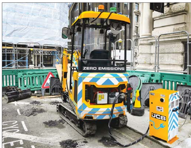
Za pomocą uniwersalnej ładowarki zewnętrznej użytkownik może bez problemu naładować minikoparkę elektryczną JCB 19C-1E w ciągu dwóch i pół godziny
