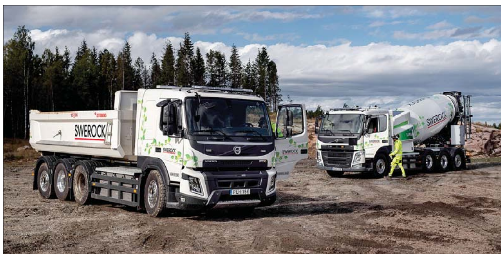
W ramach testów elektryczny samochód ciężarowy Volvo FM zabudowany jako betonmieszarka dostarczał beton, a napędzany elektrycznie pojazd ciężarowy Volvo FMX wyposażony w urządzenie hakowe brał udział w większych projektach infrastrukturalnych
