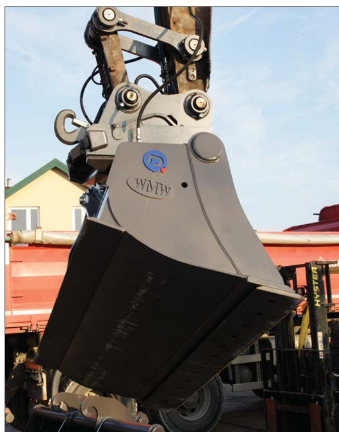
Łyżka skarpowa wraz z głowicą obrotową jest jednym z ciekawszych konstrukcyjnie narzędzi Dekpol Steel kupionym ostatnio przez WMW
