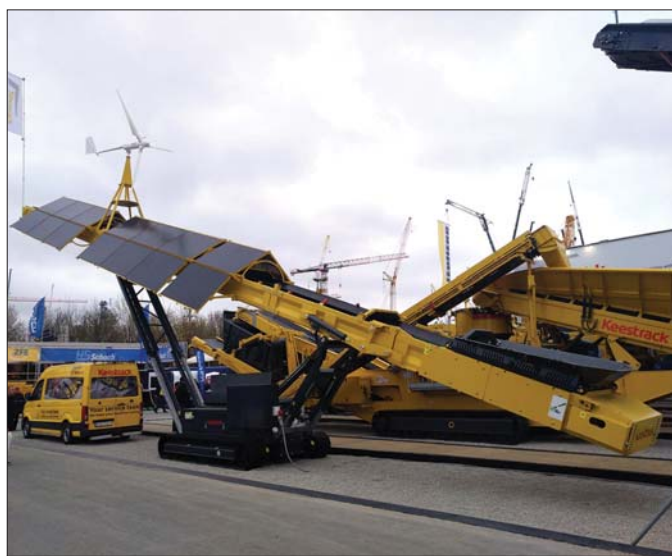
Przenośnik taśmowy Keestrack S5e „Solar” to prawdopodobnie pierwszy na świecie element mobilnego zakładu przesiewająco-kruszącego zasilany energią słoneczną
