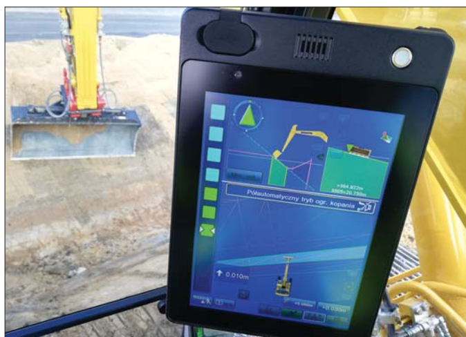
Operator Inteligentnej Koparki Komatsu PC210LCi-11E0 korzystać może z funkcji automatycznego przechyłu łyżki skarpowej
