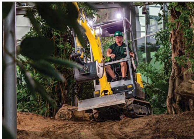
Minikoparka Wacker Neuson EZ17e wykorzystywana była przy nasadzeniach tropikalnej roślinności, służyła także do przenoszenia głazów
