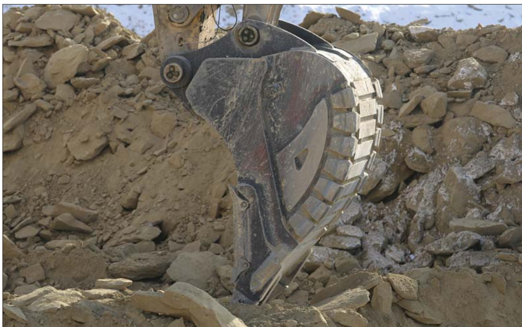
Do budowy narzędzia wykorzystano wyłącznie wysoko wytrzymałościowe gatunki stali z grupy Quard. Ciekawostką stanowi fakt, że trzy zęby łyżki, z których środkowy wysunięty został 25 centymetrów przed skrajne, pochodzą ze spycharki Cat D11
