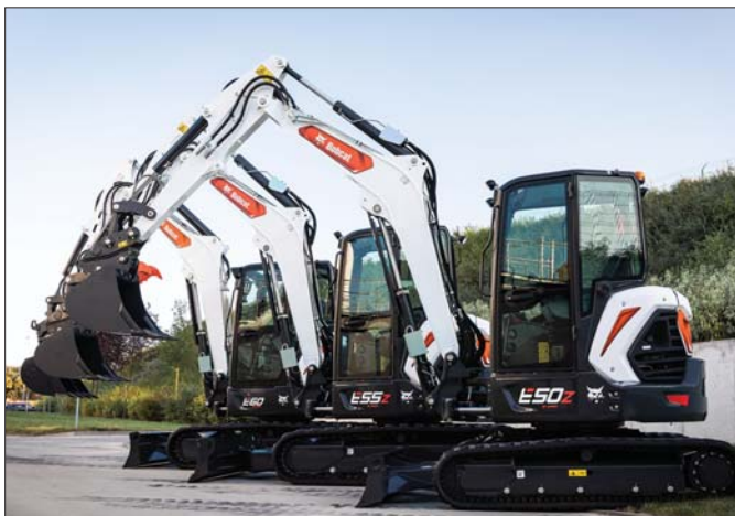
Nowa kabina minikoparek ma bardzo dużą powierzchnię przeszkleń i wąskie słupki, co maksymalnie poprawia widoczność na obszar roboczy wokół maszyny
