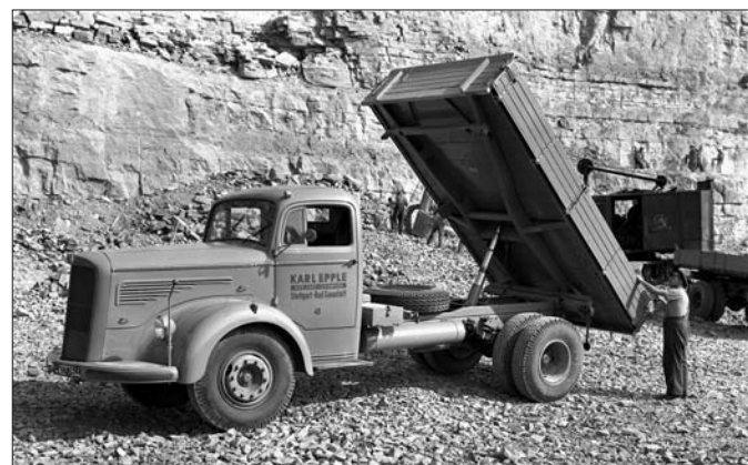
Mercedes-Benz LK 315, model 304 zabudowany jako wywrotka sfotografowany w jednej z niemieckich kopalni surowców skalnych w okolicach Stuttgartu
