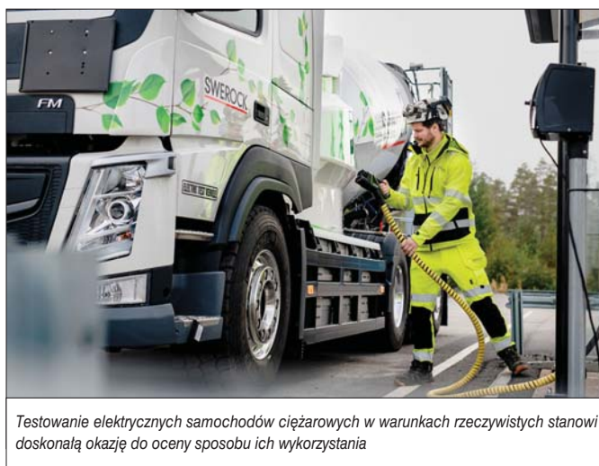
W ramach testów elektryczny samochód ciężarowy Volvo FM zabudowany jako betonmieszarka dostarczał beton, a napędzany elektrycznie pojazd ciężarowy Volvo FMX wyposażony w urządzenie hakowe brał udział w większych projektach infrastrukturalnych
