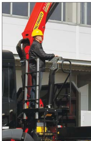
Stanowisko operatora znajduje się w bezpiecznym miejscu za kabiną
