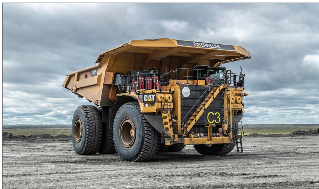
Cat 797F to najlepiej sprzedające się wozidło w klasie 363 ton, charakteryzujące się najwyższą w swojej klasie ładownością oraz prędkością rozwijaną na wzniesieniach o dużym nachyleniu
