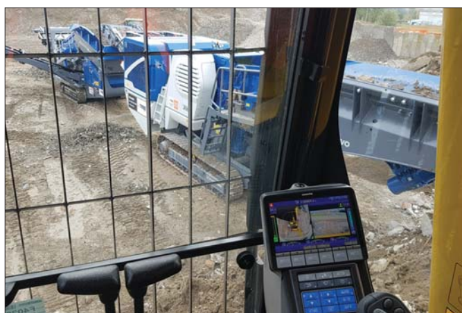
Zarówno mobilny zakład przesiewająco-kruszący, jak i służąca do załadunku koparka mogą być obsługiwane przez tego samego operatora
