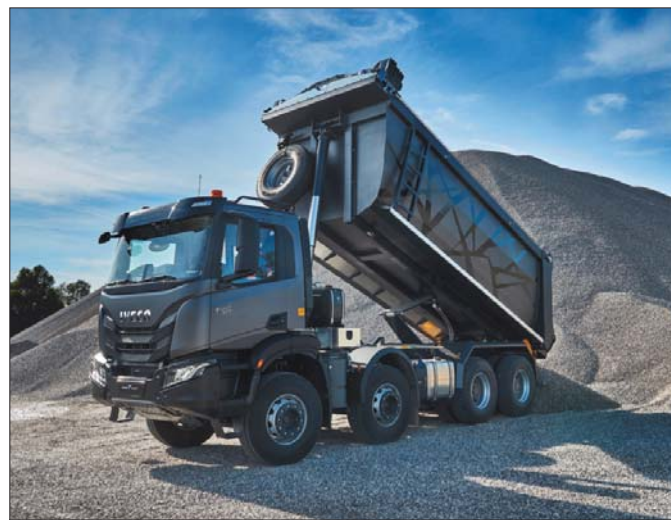
W porównaniu z Trakkerem konstruktorom nowego pojazdu udało się zwiększyć jego ładowność dzięki obniżeniu masy własnej o 325 kilogramów
