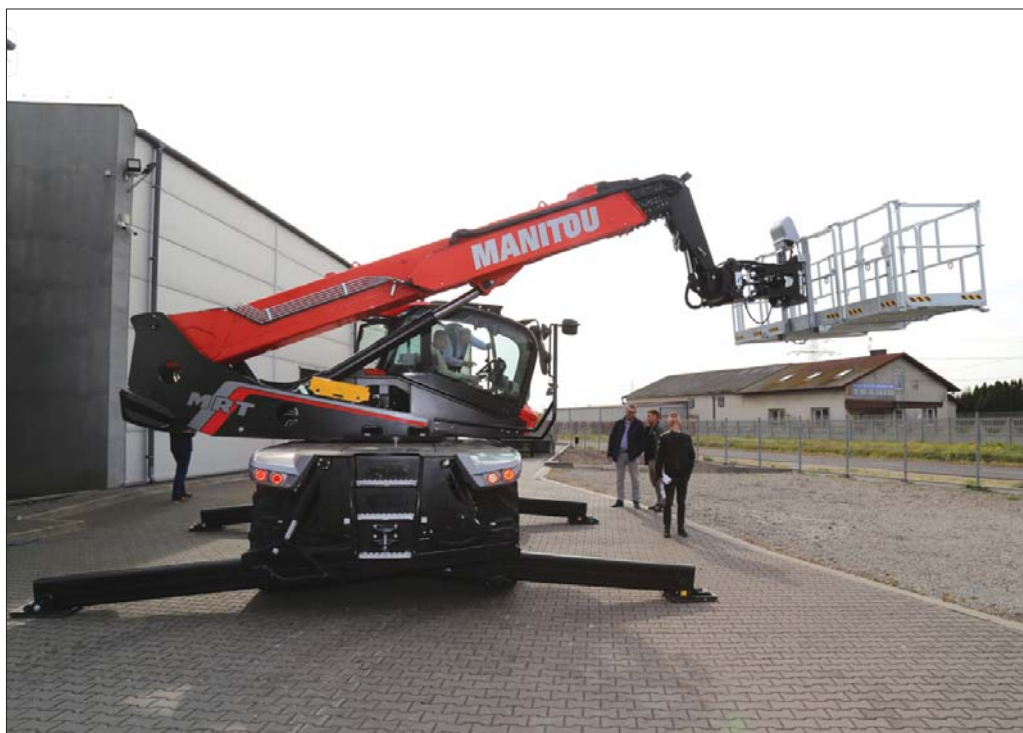
MRT 2260 to potężna obrotowa ładowarka teleskopowa, a w zasadzie trzy maszyny w jednej. Oprócz funkcji ładowarki może być wykorzystywana także jako wciągarka i podnośnik koszowy
