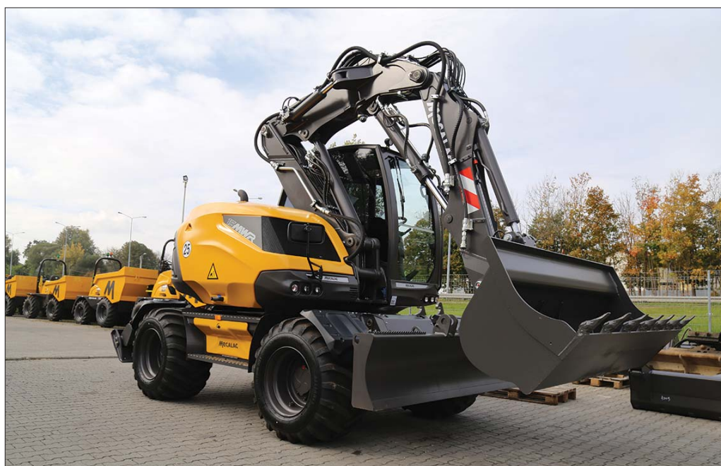
Największym atutem koparek Mecalac jest konstrukcja wysięgnika, pozwalającego na sprawne wykonywanie prac realizowanych z reguły przez znacznie cięższe maszyny oraz w miejscach o ograniczonej przestrzeni
