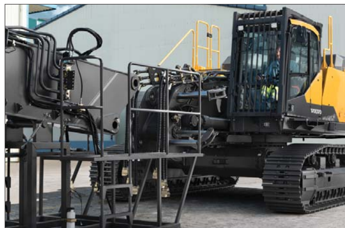
W przegubie modułowym zastosowano hydrauliczny mechanizm blokujący do wymiany wysięgników do pracy na dużej wysokości i standardowego
