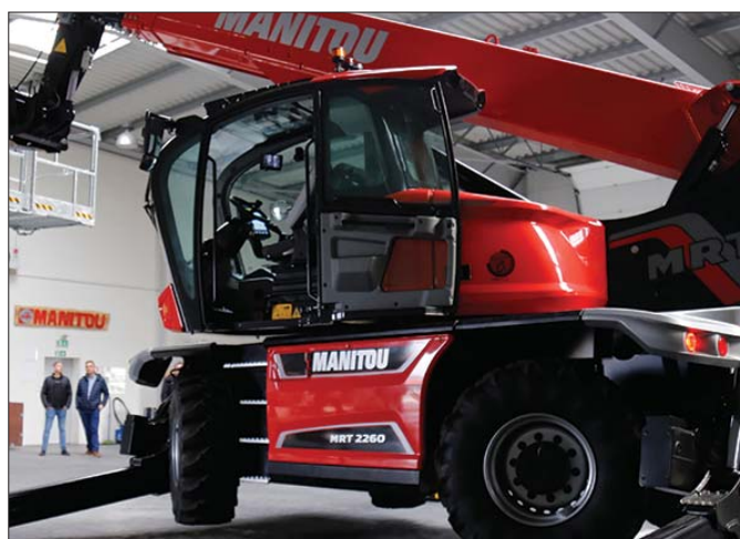
Obrót wieżyczki o 360° i wyjątkowa widoczność z kabiny pozwalają na łatwiejsze wykonywanie operacji bez konieczności przemieszczania maszyny
