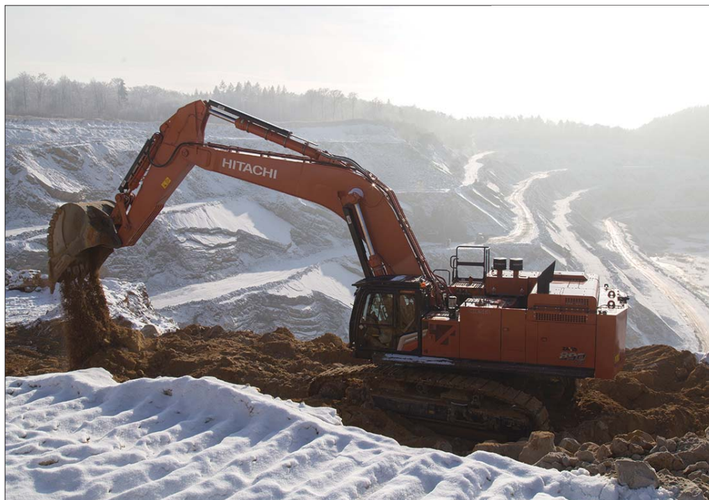
Koparka Zaxis 890 LCH wyróżnia się solidną budową. Wzmocniony wysięgnik i rama ograniczają ryzyko uszkodzeń mechanicznych i sprawiają, że maszyna spisuje się doskonale w miejscach o dużym nachyleniu, na przykład w kamieniołomach
