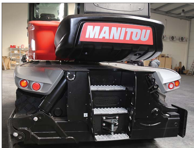
Wykonane z aluminium stopnie mają różną głębokość, co sprawia, że każdy z nich jest wyraźnie widoczny podczas schodzenia
