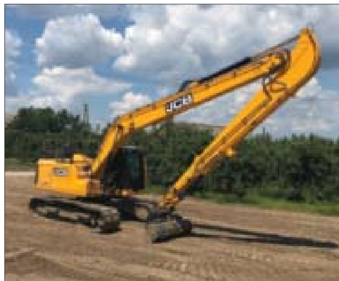
Zakład Usług Wodno-Melioracyjnych i Rekultywacji w Sandomierzu ma pięć „Iksów”, w tym dwa wyposażone w specjalistyczny wysięgnik Long Reach
