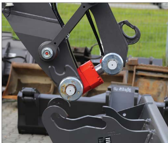
Szybkozłącze Mecalac Connect pozwala błyskawicznie zmienić osprzęt, co ma olbrzymi wpływ na zwiększenie produktywności koparki
