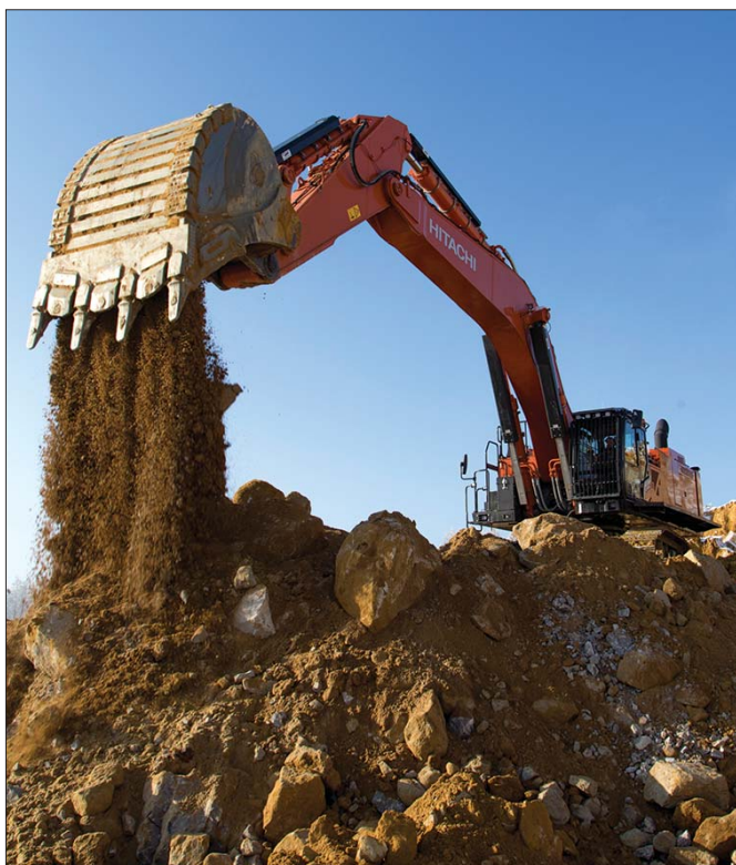
Koparka wyposażona została w specjalną łyżkę Renomag, która w trudnych kopalnianych warunkach okazuje się wprost nie do zdarcia
