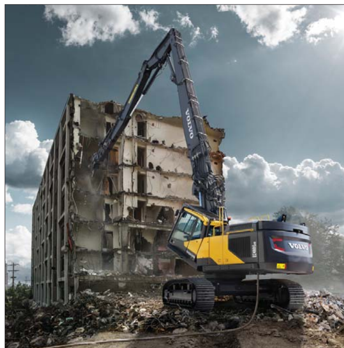
Standardowa kabina odchyła się o trzydzieści stopni, aby poprawić widoczność oraz zmniejszyć zmęczenie operatora przy pracach na dużym zasięgu
