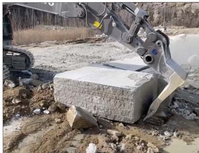
Specjalistyczna łyżka do bloków skalnych Dekpol Steel została zaprojektowana z uwzględnieniem indywidualnych potrzeb kopalni granitu
