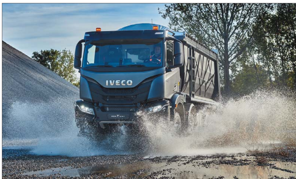
Nowy wzmocniony układ tylnego zawieszenia z podwójnymi osiami optymalizuje masę pojazdu i poprawia skuteczność w terenie, dzięki większemu prześwitowi poprzecznemu i kątowni zejścia
