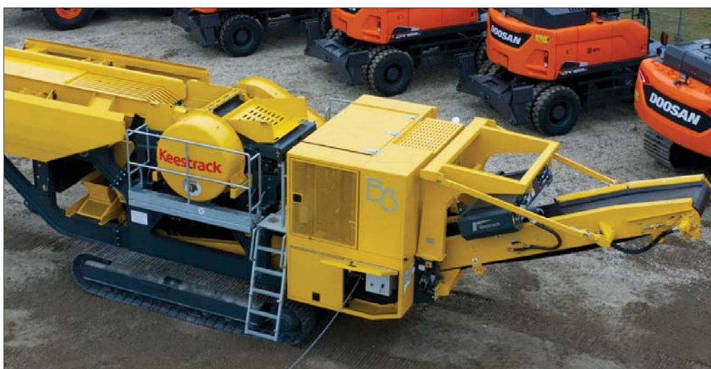
Keestrack B3 to bardzo łatwa w transporcie kruszarka pierwszego stopnia znajdująca zastosowanie zarówno w kopalniach surowców skalnych, jak i na terenach powyburzeniowych czy w żwirowniach
