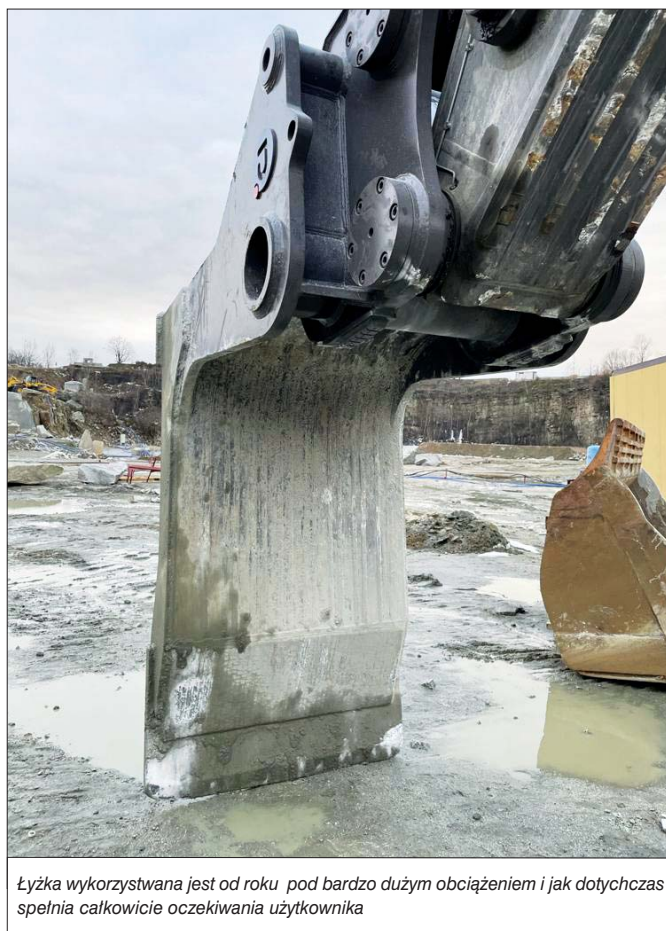
Łyżka do bloków skalnych zbudowana została z najwytrzymalszych materiałów. Jej płyta napawana jest stalą Duroxite, boki wykonano ze stali o zwiększonej odporności na pęknięcie, a osłony mocowania z przodu i tyłu ze stali HX450
