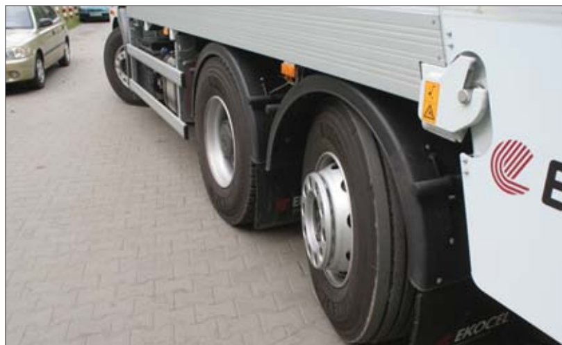
△ Skrętna tylna oś skutecznie „narzuca” tył pojazdu, dzięki czemu znacznie łatwiej manewrować na ograniczonej przestrzeni
