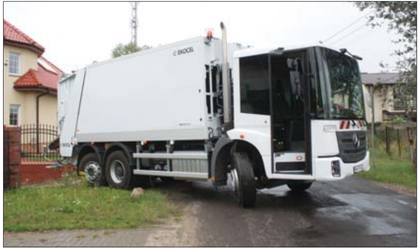
△ Zawieszenie pneumatyczne z regulacją wysokości umożliwia wygodny dojazd do posesji, bez ryzyka uszkodzenia podwozia
