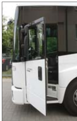
△ W Econicu lusterko wsteczne z lewej strony nadal mocowane jest do kabiny, przez co drzwi nie otwierają się do kąta prostego. Rozwiązanie to nie jest najszybsze, gdy do obsługi pojemników potrzeba również kierowcy
