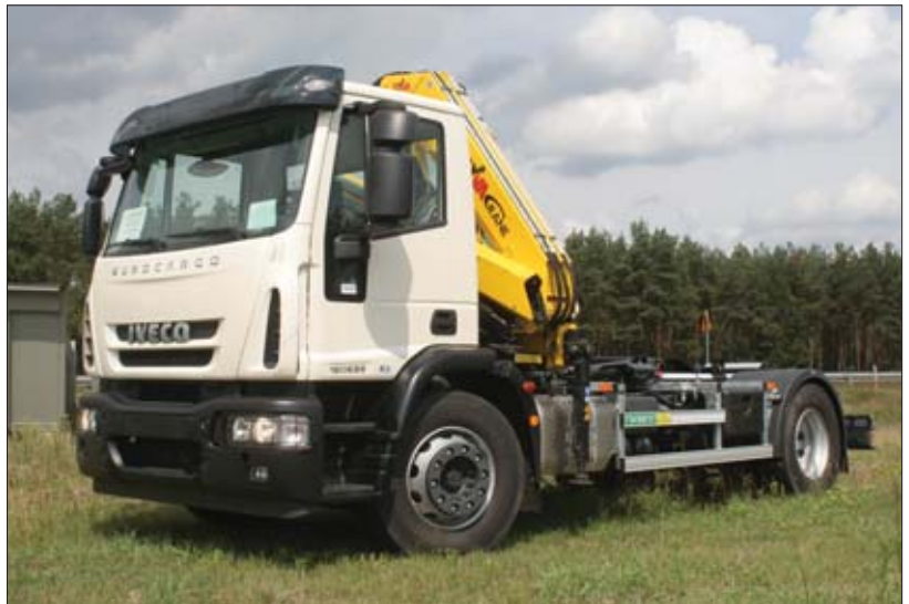
△ Iveco Eurocargo wyposażone w żuraw zakabinowy i urządzenie hakowe to bardzo uniwersalny pojazd. Może być wykorzystywany nie tylko do obsługi kontenerów, ale także opróżniania pojemników dzwonowych stosowanych przy selektywnej zbiórce odpadów
