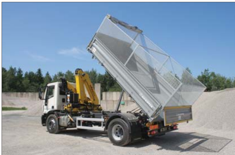
△ Ciekawym rozwiązaniem dla branży komunalnej jest Iveco Eurocargo z żurawiem i wywrotką trójstronną. Prezentowany pojazd ma lekkie nadstawki siatkowe, pozwalające na wygodny transport materiałów objętościowych
