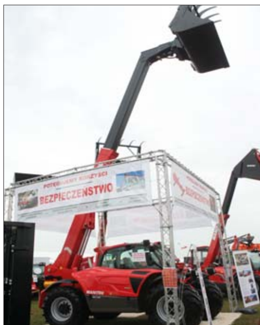
△ Ładowarka MLT 960 została wyposażona w nowoczesny silnik John Deere o mocy 141 KM oraz wydajny układ hydrauliczny zasilany pompą wielotłoczkową
