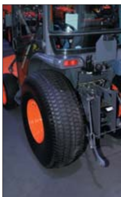
△ Ciągniki STW mogą być wyposażone w różne rodzaje ogumienia. Jedną z propozycji są opony o niskim profilu bieżnika polecane do pracy na podłożach trawiastych
