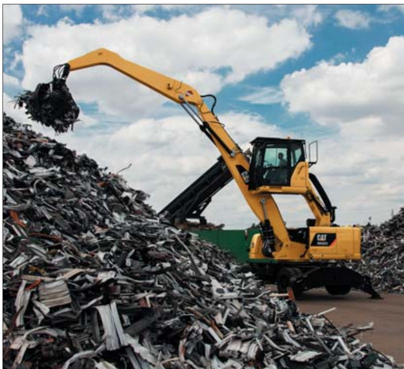
△ Oba modele koparek kołowych wyposażane są w kabinę unoszoną hydraulicznie, zapewniającą znakomitą widoczność obszaru roboczego
