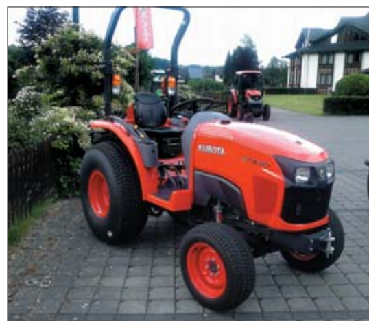
◁ Model STW40 jest dostępny w wersji z ramą ochronną (oznaczenie ROPS) lub kabiną (oznaczenie CAB). Stałowy pałak może być łatwo złożony, co ułatwia transport i przechowywanie ciągnika
