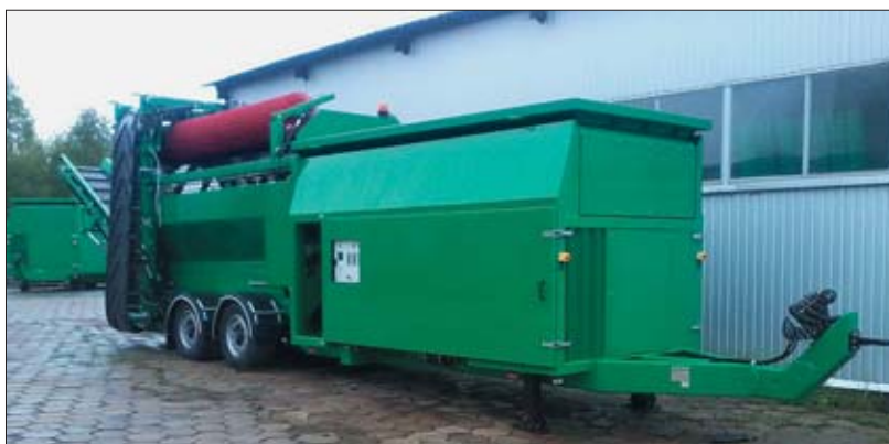
▽ W gamie maszyn produkowanych przez Luxor są przesiewacze bębnowe, dyskowe i wibracyjne. Urządzenia bębnowe występują w wersji stacjonarnej i mobilnej
