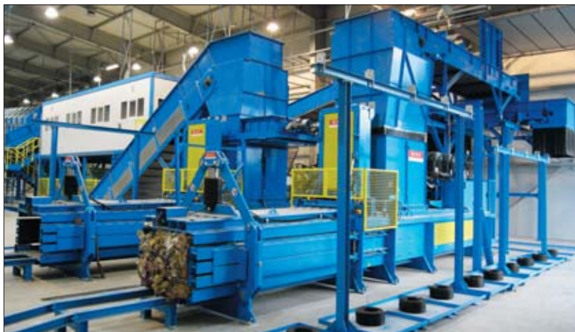
△ Prasy Kanałowe Luxor są przeznaczone do zakładów sortujących duże ilości odpadów, takich jak folie, kartony, butelki PET, tworzywa sztuczne, tekstylia, guma i elementy drewniane
