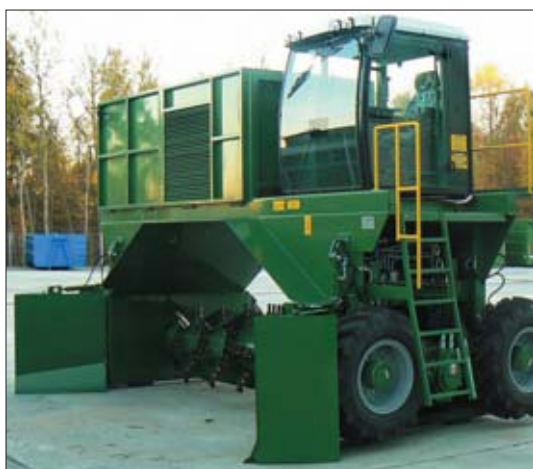
◁ Przerucarki Luxor występują z dwoma rodzajami podwozia – kołowym i gąsienicowym. Ułatwia to dobór maszyny do konkretnych warunków eksploatacji
