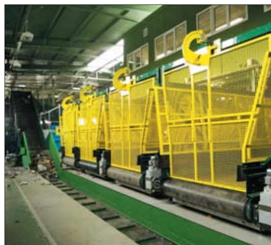
▷ Luxor oferuje kompletne linie sortownicze, w skład których prócz zespołu przenośników wchodzić może wiele urządzeń dodatkowych, jak np. przesiewacze, separatory, rozdrabniarki, prasy, perforatory PET czy rozrywarki worków
