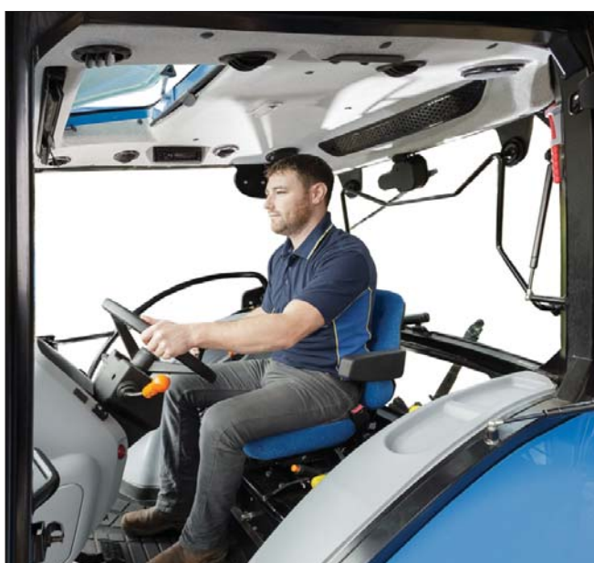
△ Nowa kabina ma ergonomicznie zaprojektowane wnętrze i zapewnia dobrą widoczność dookoła maszyny. A wąskie słupki konstrukcyjne i szerokokątne lustro poprawiają bezpieczeństwo pracy operatora i osób znajdujących się w pobliżu. Warto też dodać, że klimatyzacja jest standardowym wyposażeniem ciągników
