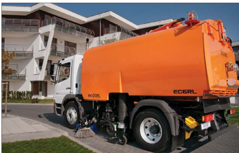
△ Model FAUN VIAJET 6 wyposażony jest w zbiornik na odpady o pojemności 6 metrów sześciennych. Dno zbiornika wykonano ze stali nierdzewnej, a gładkie ściany ułatwiają jego opróżnienie
