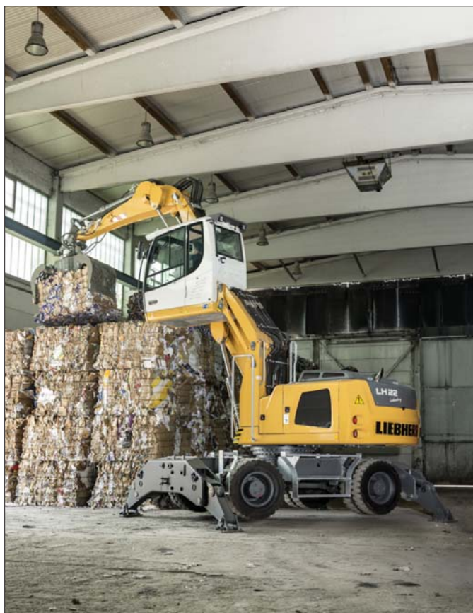
△ Unoszona kabina zapewnia operatorowi doskonałą widoczność i znacznie poprawia precyzję wykonanych prac
