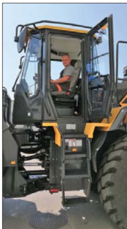
△ Konstruktorzy zadbali także o bezpieczeństwo i wygodę operatora. Służą temu między innymi nowoczesna, komfortowa kabina oraz prowadzące do niej antypoślizgowe stopnie
