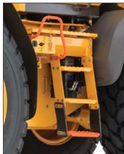
△ Antypoślizgowe stopnie umożliwiają bezpieczne wejście do kabiny
