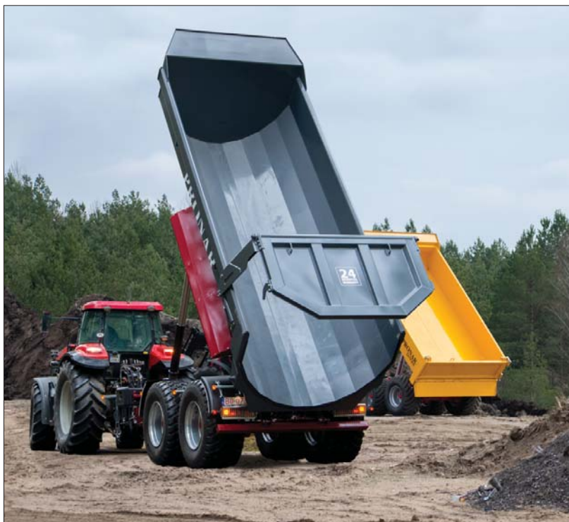
△ Zastosowanie stali Hardox w podłodze i burtach bocznych skrzyń ładunkowych przyczep pozwoliło zwiększyć nie tylko trwałość i wytrzymałość, ale także ładowność
