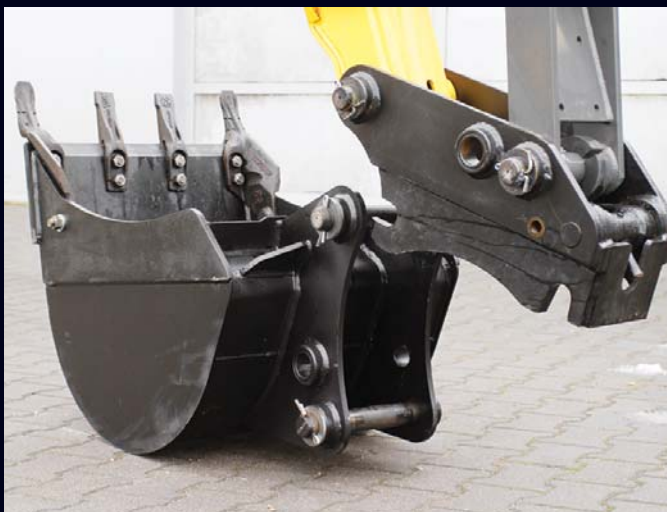
▲ Szybkozłaczę pozwala na szybką wymianę narzędzi roboczych, co znacząco zwiększa produktywność i zakres zastosowań maszyn
