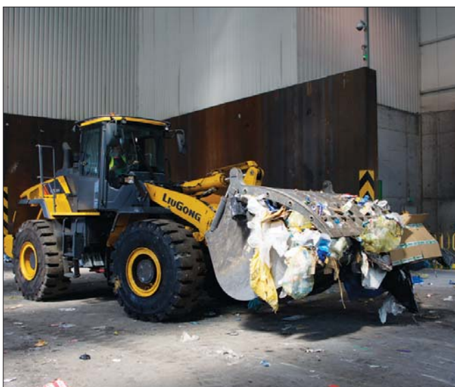
△ Ładowarki LiuGong wyposażone w łyżki z klapą dociskową transportują odpady bezpiecznie i szybko
