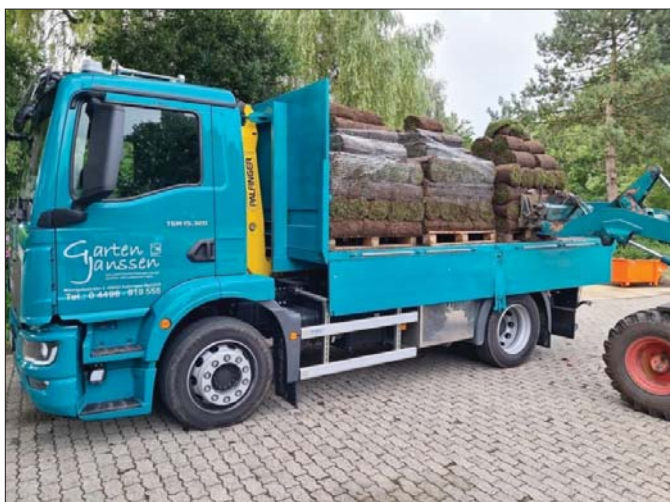
△ Dzięki zastosowaniu specjalistycznych kontenerów pojazd nadaje się również do bocznego załadunku i rozładunku towarów spaletyzowanych i drobny
