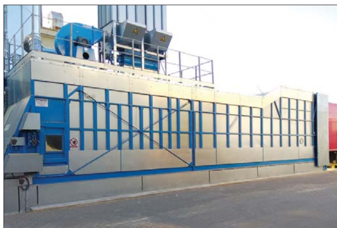
△ W wielu przedsiębiorstwach zajmujących się gospodarką odpadami kluczową rolę odgrywa bufor przeładunkowy z ruchomą podłogą
