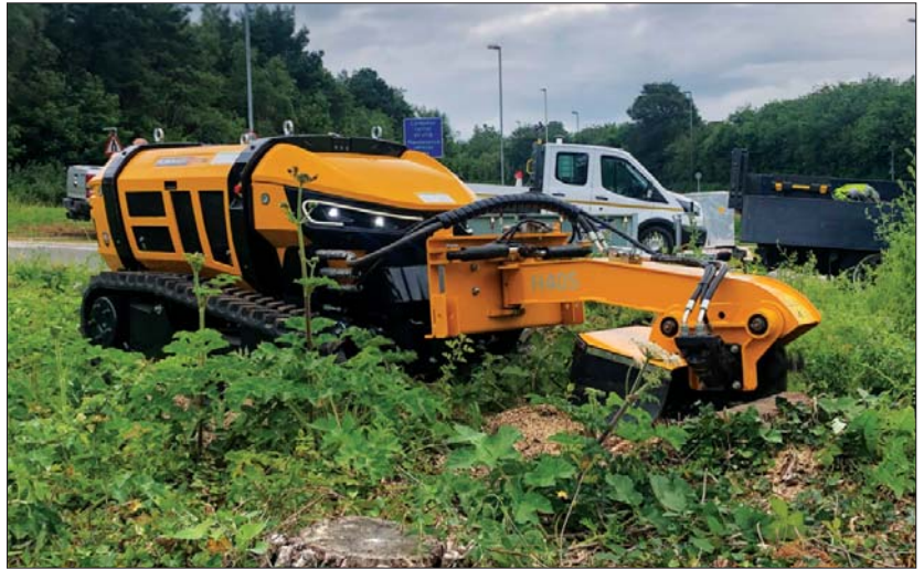
△ Szeroka gama osprzętu, w tym frezarki do pni i rozdrabniacze, sprawia że funkcjonalność ROBOCUT nie ogranicza się jedynie do koszenia trawy i wycinanie krzewów
