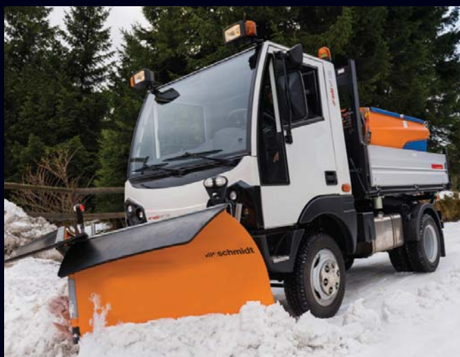
▲ W szerokiej gamie osprzętu znajduje się duży wybór pługów odśnieżnych, które wraz z umocowaną do podwozia posypywarką pozwalają pojazdom skutecznie walczyć ze śniegiem i gołoledzią
