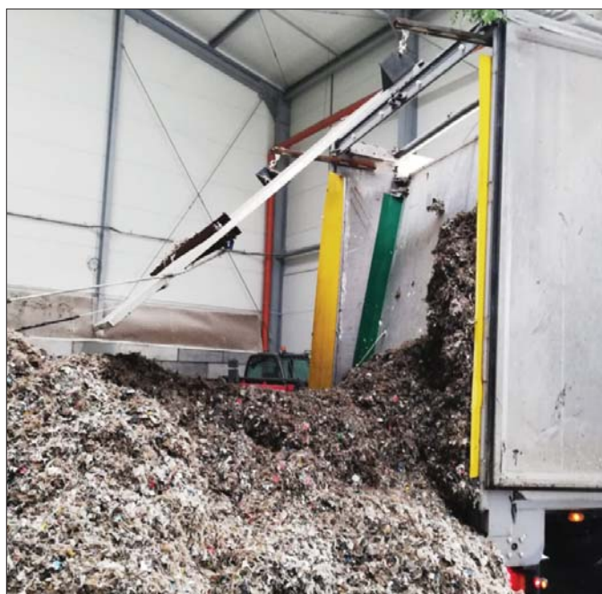
△ Do przygotowania frakcji odpadów przeznaczonych do produkcji paliwa RDF najlepiej wykorzystać ścianę kompresującą PTM
