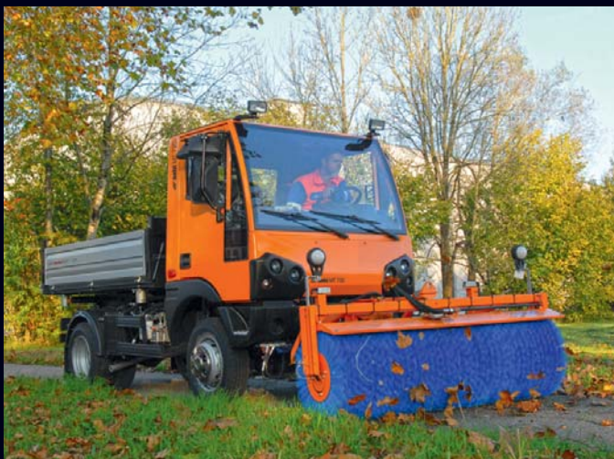
▲ Jak przystało na uniwersalne nośniki narzędzi pojazdy MT mogą pełnić różnorodne funkcje. Wystarczy zamocować profesjonalną szczotkę, a przekształcą się w funkcjonalną zamiatarkę
