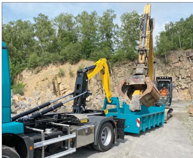
△ Dzięki przemyślanej geometrii zaczepu hakowiec „Power A” zapewnia wyjątkowo płaski kąt wciągania kontenera i ogromną siłę na haku
