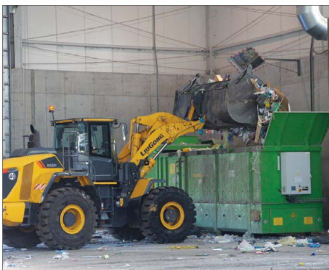
△ Długie ramiona wysięgników umożliwiają maszynom swobodny załadunek kontenerów i skrzyń samochodów
