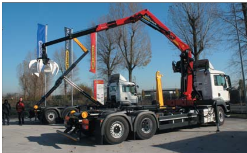
△ Żuraw Epsilon Q150Z96 ma dwa obwoły hydrauliczne, dzięki czemu łączenie ruchów roboczych nie powoduje ograniczenia prędkości ich wykonywania
