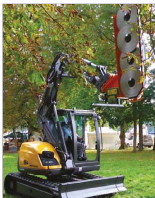
△ Funkcjonalność i zakres zastosowań maszyny zwiększyć można dzięki zastosowaniu specjalistycznych narzędzi roboczych. To umożliwiła prześwietlanie koron wysokich drzew
