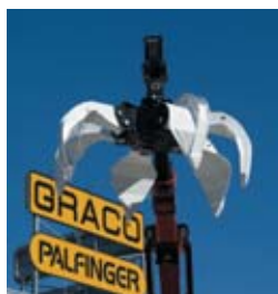
△ Chwytnik wielopalczasty zamontowany na rotatorze ułatwia prawidłowe rozmieszczenie ładunku w kontenerze
