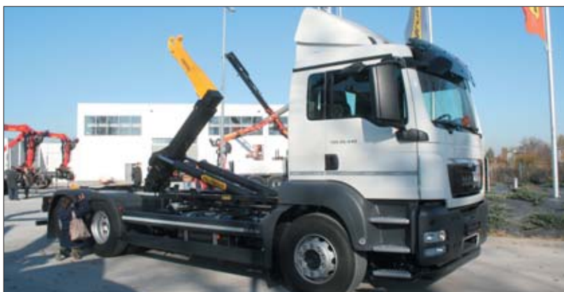
▽ Urządzenie hakowe jest zamontowane do podwozia tylko za pomocą połączeń śrubowych, co gwarantuje odpowiednią elastyczność konstrukcji i eliminuje problemy związane z pęknięciami spawów
