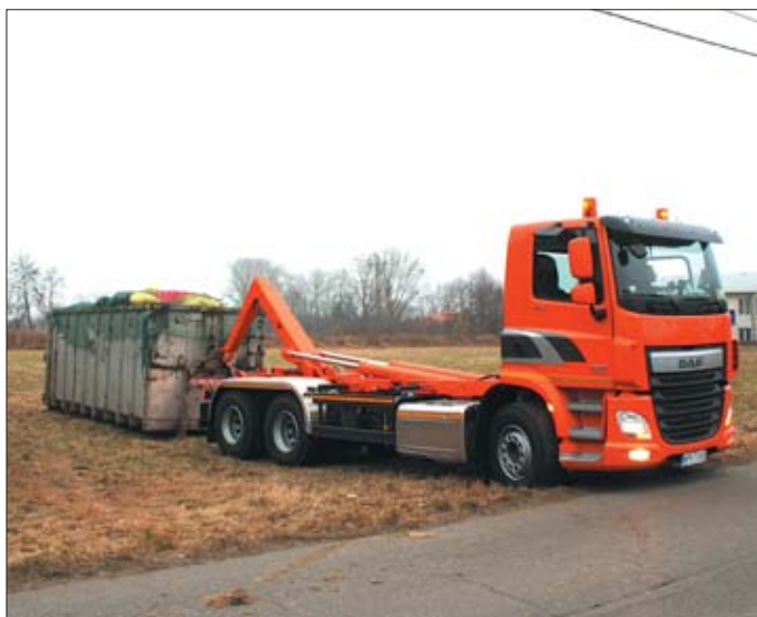
△ Zdarza się, że z braku miejsca czy w obawie przed możliwością uszkodzenia rolkami kostki brukowej trzeba decydować się na wjazd w „ryzykowny” teren, a wówczas najłatwiej docenić komplet blokad mechanizmów różnicowych zespolonej osi napędowej
