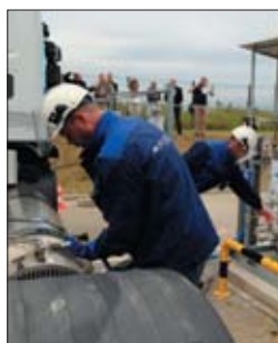
△ Pracownicy stacji muszą być ubrani w odzież antystatyczną, specjalne rękawice i kaski z osłonami twarzy. W Holandii tankowanie LNG mogą przeprowadzać sami kierowcy, ale tylko odpowiednio przeszkoleni i wyposażeni w stosowne ubrania ochronne
