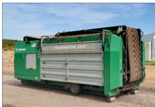
◁ Uniwersalny rozdrabniacz wstępny Terminator 3400 to jedna z najstarszych maszyn Komptech pracujących w Sobuczynie. Ma on hydraulicznie opuszczane koła, które pozwalają na łatwą zmianę miejsca pracy, bez konieczności angażowania pojazdu z zabudową hakową
