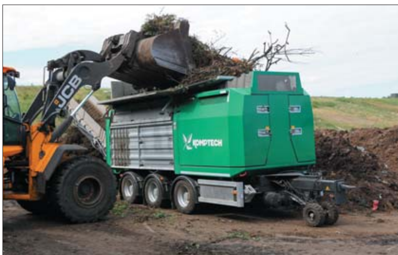
△ Rozdrabniacz do biomasy Crambo 5000 doskonale radzi sobie nawet grubymi gałęziami czy karpami. Jego elementy robocze pracują ze znacznie niższą prędkością obrotową niż w rękawkach, dzięki czemu są odporne na wtrącenia, takie jak np. kamienie
