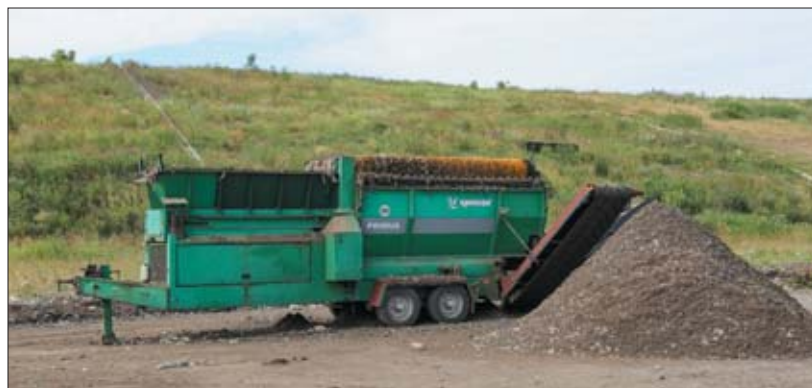
△ Mimo wielu lat intensywnej eksploatacji, przesiewacz bębnowy Primus wciąż jest „na chodzie”. Znajduje zastosowanie np. w sytuacji większego obłożenia przesiewacza Mustang
