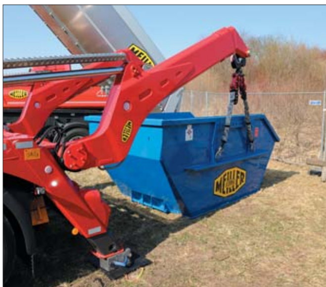
△ Elementy zabudów Meiller-Kipper poddawane największym obciążeniom tworzą zamknięte profile wykonane ze stali o wysokiej wytrzymałości
