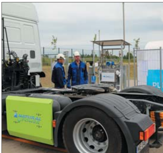
◁ Stralisy przekazane do testy do firmy IKEA mają jeszcze zbiorniki CNG, ale Iveco pracuje już nad pojazdami zasilanymi wyłącznie LNG. Dzięki dwóm zbiornikom na metan w postaci ciekłej będą dysponowały zasięgiem przekraczającym 1000 km
