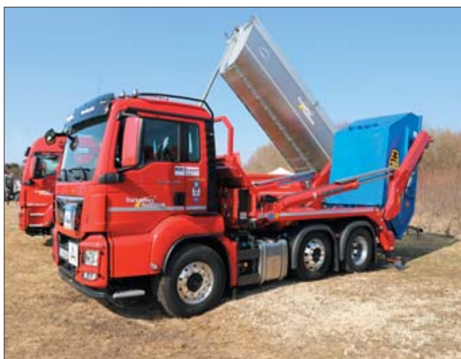
△ W przedniej części zabudowy bramowej Meiller-Kipper montowana jest masywna rama, która zabezpiecza kabinę pojazdu przed uszkodzeniem. Silowniki hydrauliczne są osłonięte nakładkami z ryflowanej blachy aluminiowej
