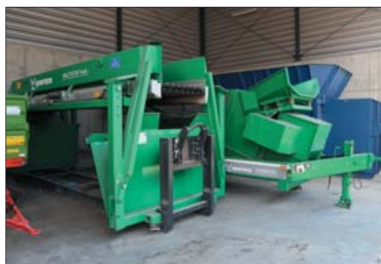
△ Mimo wielu lat intensywnej eksploatacji, przesiewacz bębnowy Primus wciąż jest „na chodzie”. Znajduje zastosowanie np. w sytuacji większego obłożenia przesiewacza Mustang
