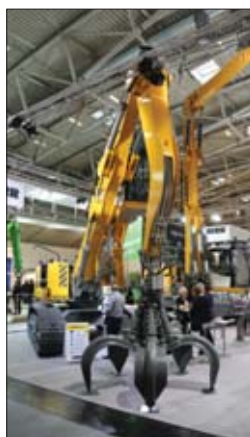
△ W prezentowanych maszynach przeładunkowych zastosowano ten sam model chwytaka pięciopalcowego Liebherr GM65 o pojemności 0,6 m 3
