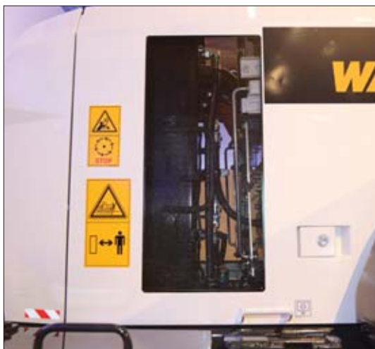
◁ Ładowarki Komatsu przeznaczone do pracy z odpadami mają pokrywy silnika z wlotami powietrza w postaci gęstej siatki
