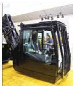
△ Przy maksymalnym podniesieniu kabiny w modelu MH3037 linia wzroku operatora znajduje się na wysokości około 5,5 metra. Czas jej podnoszenia wynosi osiem, opuszczania dziesięć sekund
