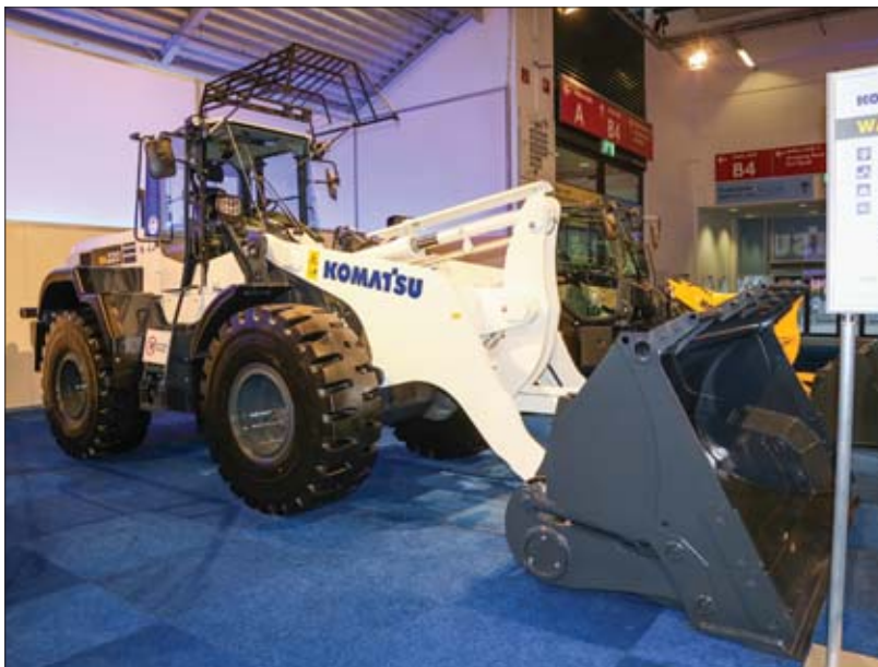
△ Ekspozycyjna ładowarka Komatsu WA320-7 została wyposażona w komplet oświetlenia, obejmującego z przodu sześć, a z tyłu cztery efektywne światła robocze. Siłownik obrotu łyżki zabezpieczony został solidną, stalową osłoną
