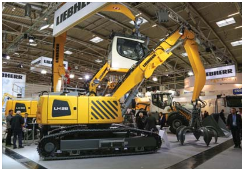
△ Koparka do prac przeładunkowych LH 26 CE Industry ma podwozie z gąsienicami rozstawionymi na szerokość 2.400 mm, co zapewnia odpowiednią stabilność, pozwalając tym samym na pełne wykorzystanie osiągniętego układu hydraulicznego
