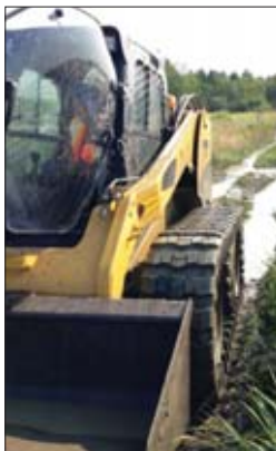
△ Maszyna wyposażona w gąsienice Camso OTT HXD z łatwością porusza się w błocie, grząskim gruncie czy nawet w kopnym śniegu
