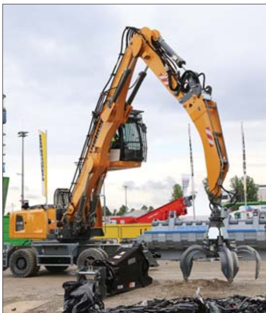
△ W prezentowanych maszynach przeładunkowych zastosowano ten sam model chwytaka pięciopalcowego Liebherr GM65 o pojemności 0,6 m 3
