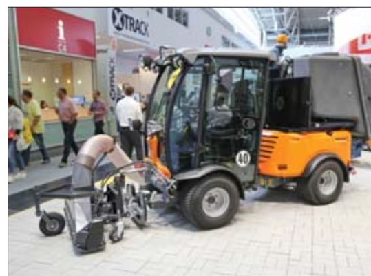
▷ Maszyna Kärcher MIC 70 ma dopuszczalną masę całkowitą 3,5 tony, a jej masa własna (bez osprzętu) wynosi zaledwie 1,8 tony
