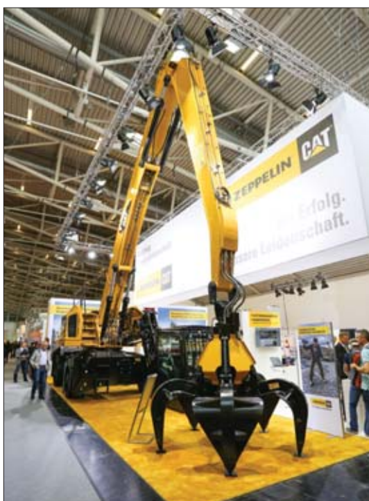
△ Przy maksymalnym podniesieniu kabiny w modelu MH3037 linia wzroku operatora znajduje się na wysokości około 5,5 metra. Czas jej podnoszenia wynosi osiem, opuszczania dziesięć sekund
