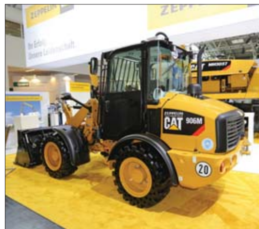
▷ Nisko umieszczoną kabinę ładowarki Cat 906M w dolnej części zabezpieczono osłonami z gęstej siatki doskonale chroniącymi ją przed odpadami, jakie mogą wydostać się spod kół maszyny
