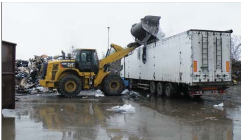
△ Zaletą ładowarki 950M jest możliwość bezpośredniego załadunku samochodów nawet z wysokimi burtami skrzyni ładunkowej
