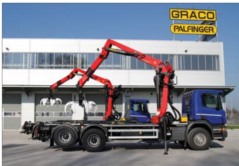
▽ Trzyosiowa Scania doskonale sprawdza się jako podwozie do zabudowy pod urządzenia wykorzystywane w szeroko pojętym sektorze komunalnym
