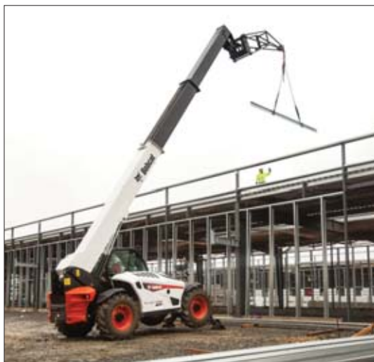
◀ Inteligentny układ sterowania SHS pozwala na dostosowanie prędkości ruchu wysięgnika do rodzaju wykonywanej pracy
