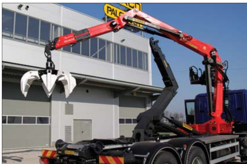
△ Połączenie w jednej zabudowie hakowca i żurawia zakabinowego znacznie zwiększa możliwości wykorzystania pojazdu
