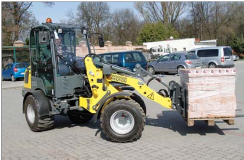
△ Mimo kompaktowych rozmiarów, ładowarka kołowa WL28 dysponuje imponującą mocą. Maksymalny udźwig 1,9 tony umożliwia bezproblemowy transport, np. palety załadunkowej ośmioma warstwami kostki brukowej
