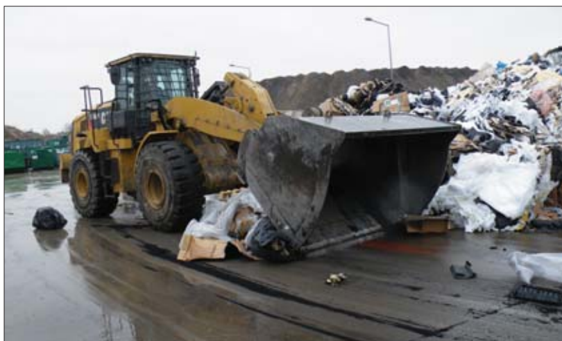
△ Załadunek ułatwia szeroka gardziel i odpowiednio profilowane płyty boczne łyżki
