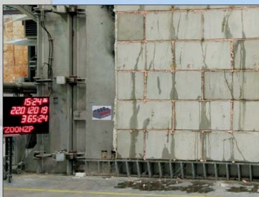
△ Zbudowana z prefabrykatów BetBlok System ściana przez ponad sześć godzin wytrzymała działanie temperatury przekraczającej 1.200 stopni Celsjusza. Dzięki temu produkt zyskał aprobatę Instytutu Techniki Budowlanej i takie ściany legitymują się certyfikatem REI 360
