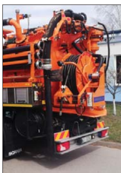
△ Nowy samochód wyposażony jest w kasetę z wężem ssącym o długości 16 metrów
