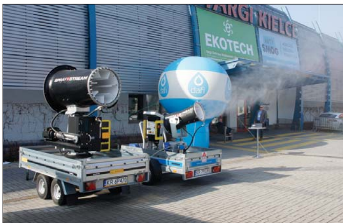
▲ Na zewnątrz hal ekspozycyjnych zwiedzający mogli zobaczyć pokaz eliminacji zapylenia i odorów przy zastosowaniu mgły wodnej
