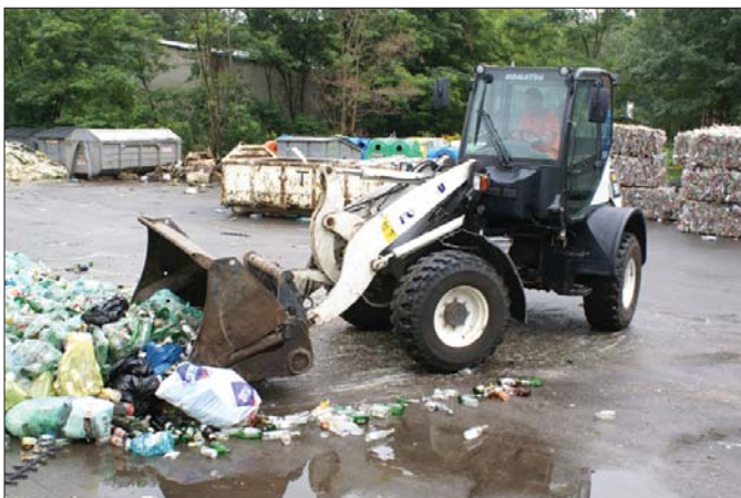
△ By wydłużyć żywotność ogumienia maszyn pracujących w sortowniach odpadów, warto zastosować wypełnienia elastomerem
