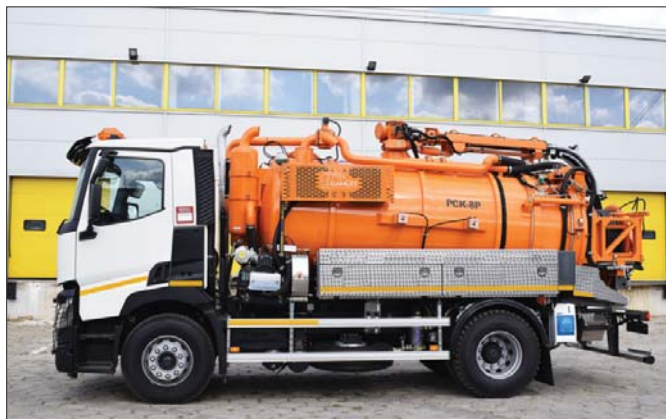
△ Wśród szerokiej gamy pojazdów produkowanych przez spółkę GAMON uznaniem cieszą się zabudowy przeznaczone do udrażniania kanałów z możliwością odsysania nieczystości
