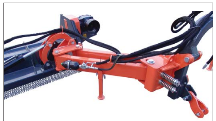
△ Zabezpieczenie sprężynowe pantografu kosiarki KTBC chroni go przed uszkodzeniami podczas uderzenia
