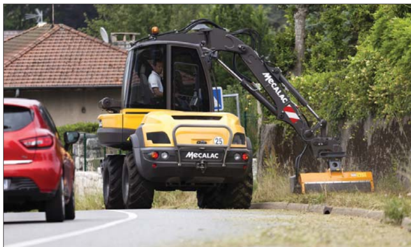
△ Długie ramię modelu 12MTX ▽ po połączeniu z kosiarką umożliwia skuteczne koszenie poboczy drogowych. Można też stworzyć zgrany tandem z zagęszczarką płytową
