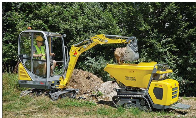
△ Duży wpływ na bezpieczeństwo oraz mniejszą uciążliwość pracy ma największa w tej klasie maszyn kabina. Przestronna i wygodna posiada dodatkową przestrzeń na nogi i głowę, a regulowany fotel oraz możliwość obsługi dźwigni stopami zapewnia idealną pozycję każdemu operatorowi
