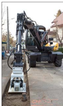
△ Długie ramię modelu 12MTX ▽ po połączeniu z kosiarką umożliwia skuteczne koszenie poboczy drogowych. Można też stworzyć zgrany tandem z zagęszczarką płytową
