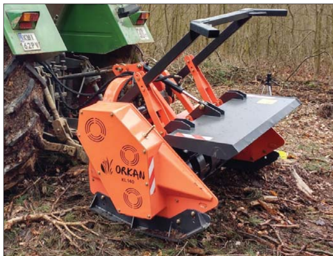
△ Kosiarki ORKAN serii leśnej można używać do niszczenia zarośli oraz pozostałości leśnych o grubości do 20 cm
