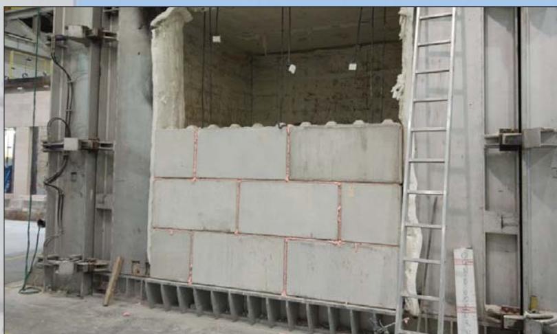
△ Zbudowana z prefabrykatów BetBlok System ściana przez ponad sześć godzin wytrzymała działanie temperatury przekraczającej 1.200 stopni Celsjusza. Dzięki temu produkt zyskał aprobatę Instytutu Techniki Budowlanej i takie ściany legitymują się certyfikatem REI 360
