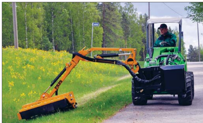
△ Kosiarka na ramieniu hydraulicznym umożliwia bezpieczne i efektywne koszenie poboczy, skarp oraz przydrożnych rowów
