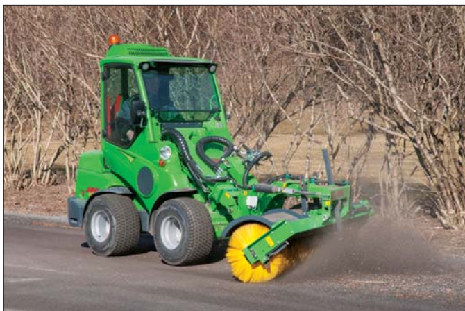
△ SERAFIN P.U.H. Andrzej Serafin ma w ofercie szczotki obrotowe, które dzięki regulowanej sile docisku do podłoża skutecznie oczyszczą każdą nawierzchnię
