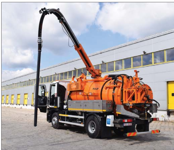
△ Interesującą propozycją jest model PCK 8 z ruchomą przegrodą. Umożliwia to w zależności od potrzeb regulowanie objętości komory wody czystej i osadu
