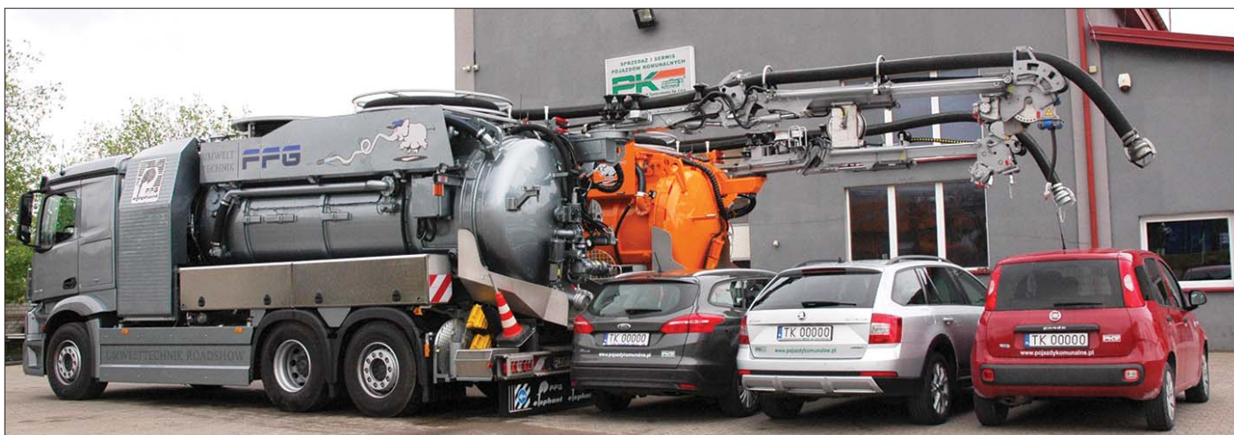
△ Długie ramię wysięgnika ułatwia pracę w miejscach trudno dostępnych. Wysięgnik FFG może też unosić ciężar o masie do 500 kg
