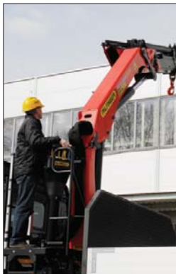
△ Stanowisko obsługującego żuraw znajduje się w bezpiecznym miejscu za kabiną pojazdu
