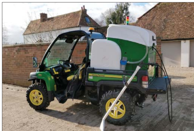
△ Dzięki wymiennym lancom urządzenie można wykorzystywać do czyszczenia różnorodnych elementów miejskiej infrastruktury
