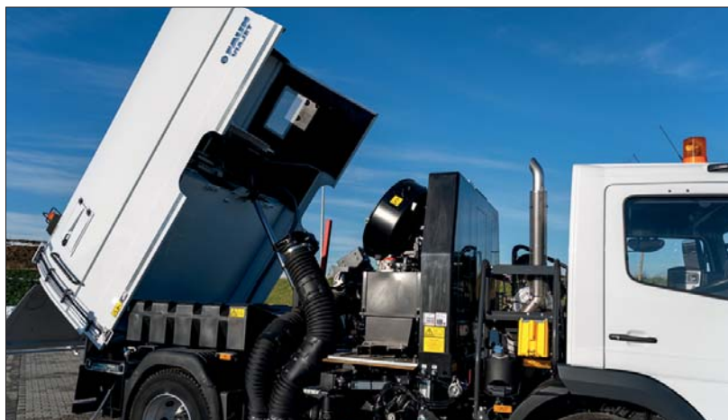
△ FAUN VIAJET 6 to zamiatarka ze zbiornikiem na zmiotki o pojemności sześciu metrów sześciennych
