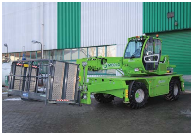
△ W łatwy sposób, bo jednym przyciskiem, operator ładowarki Merlo 50.21S może aktywować system pozwalający przechylić kabinę do 20 stopni w pionie
