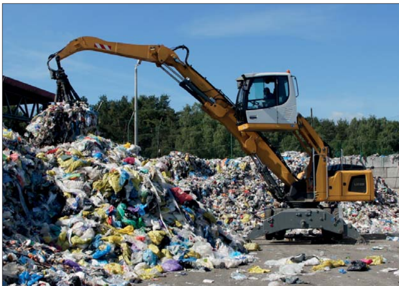
△ Wersja z unoszoną kabiną umożliwia operatorowi wstępną selekcję odpadów
