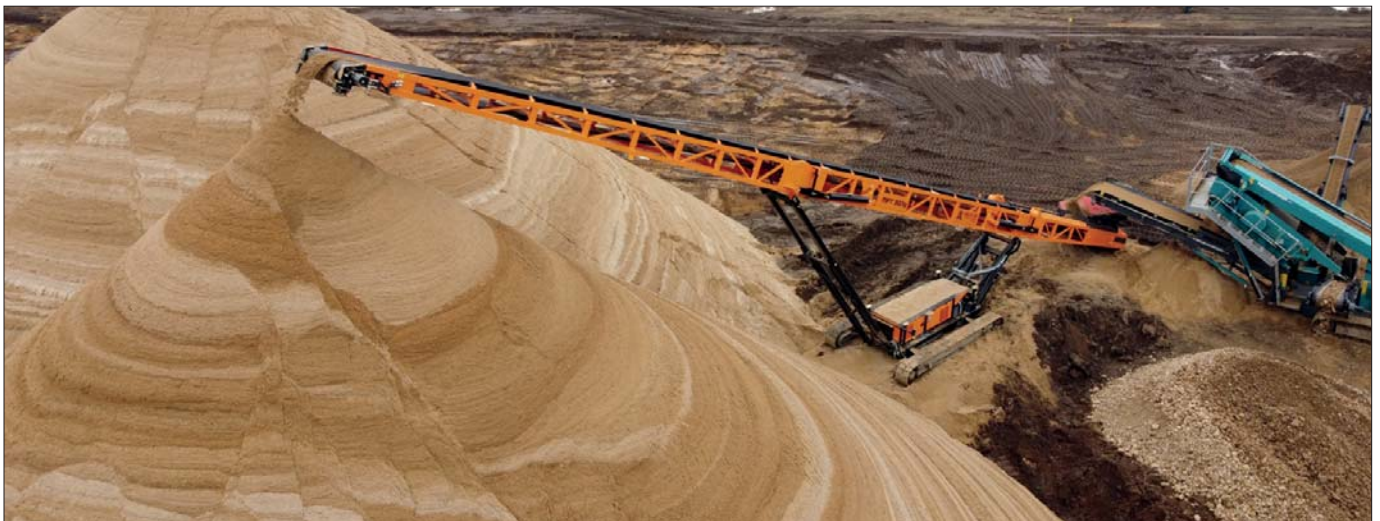
△ Model MPT 30/lg jest najdłuższym mobilnym przenośnikiem taśmowym produkowanym w fabrykach Pronaru. Umożliwia usypywanie przyzmy o wysokości maksymalnej 13 metrów
