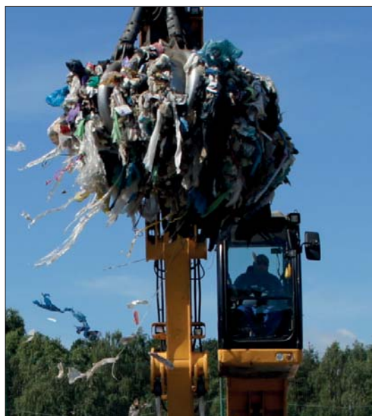
◁ Maszyna z chwytakiem doskonale sprawdza się w przemieszczaniu odpadów RDF oraz trakcji zielonej
