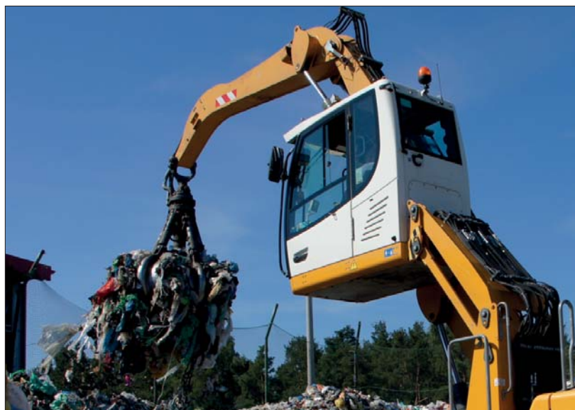
▽ Kabina operatora umożliwia kontrolę całego obszaru, a poza tym zapewnia komfortowe warunki pracy
