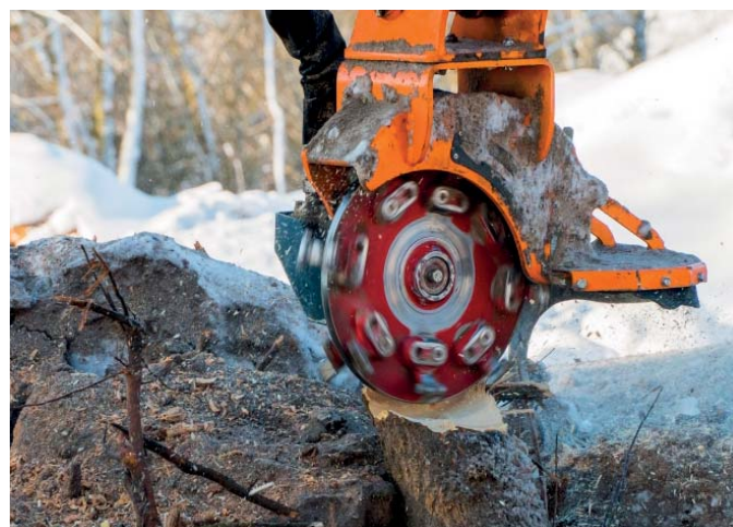
△ Głowica GF040K to także nowa propozycja Pronaru. Wykorzystywana jest głównie do frezowania pni ściętych drzew
