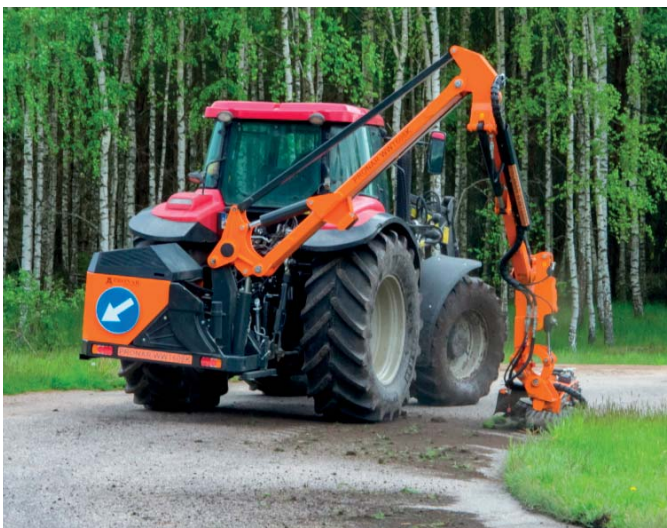
△ Zasięg roboczy, który z głowicą przekracza osiem metrów, umożliwia nowym wysięgnikom efektywne wykonywanie różnorodnych zadań związanych z utrzymaniem dróg
