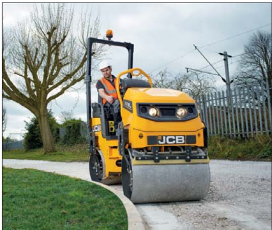
◁ Zarówno usytuowanie fotela, jak i kształt walca umożliwiają operatorowi doskonałą kontrolę obszaru roboczego
