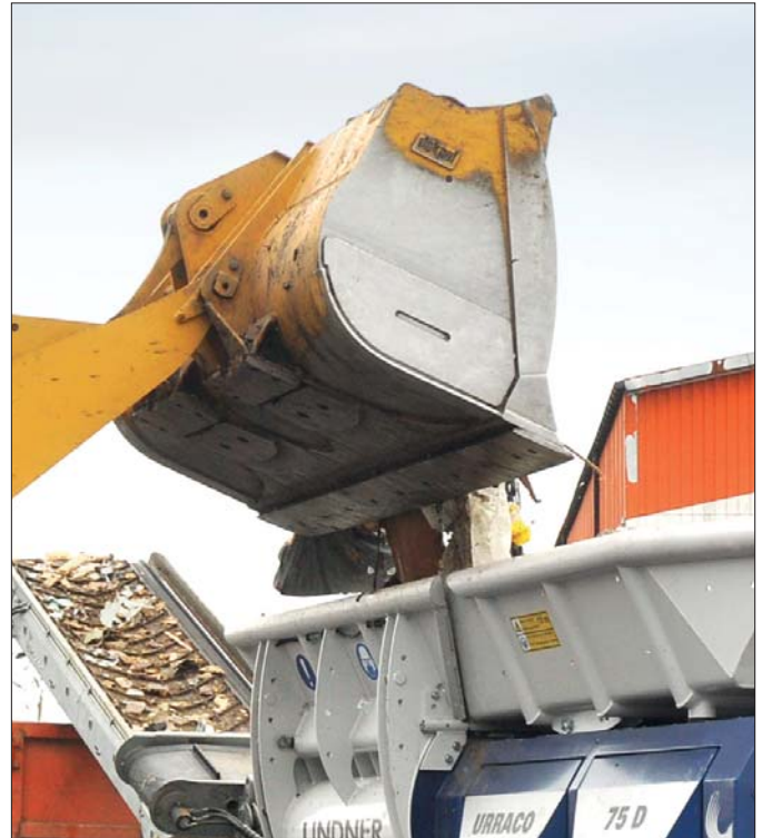
△ Mimo przetracowanych 17.000 mth łyżki Dekpolu nie mają żadnych widocznych śladów zużycia
