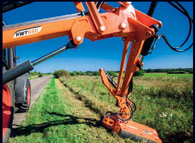
▲ Maksymalny zasięg ramienia KWT 651 przekracza 6,5 metra co umożliwia skuteczne koszenie całego pasa przydrożnej zieleni
