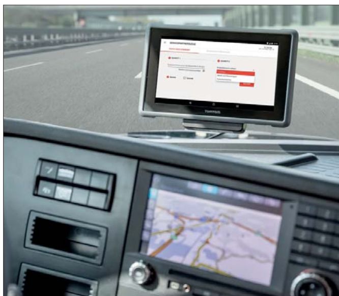
△ System telematyczny umożliwia zachowanie kontroli nad czasem użytkowania i śledzenie poziomu bezpieczeństwa floty
