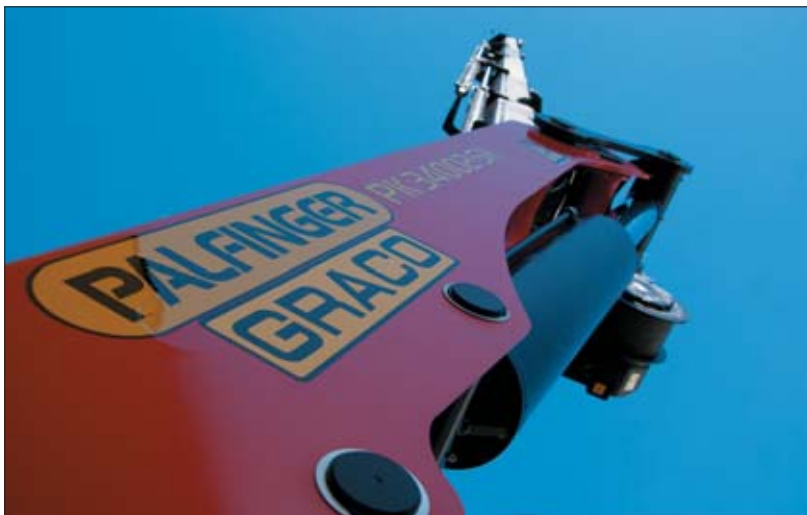
△ Żuraw Palfinger PK 34002-SH ma pięć sekcji wysuwanych hydraulicznie i maksymalny wysięg 14,4 m, przy którym zapewnia udźwig 1.800 kg
