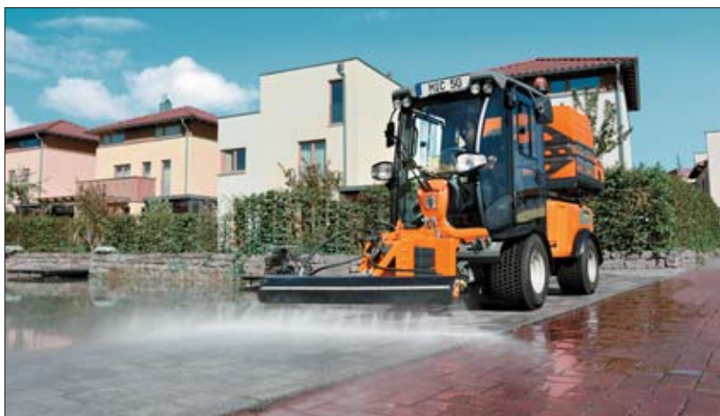
△ Nośnik MIC 50 może być wyposażony w listwę z dyszami wysokociśnieniowymi, które zapewniają wydajne, skuteczne mycie powierzchni betonowych, asfaltowych czy kostki brukowej
