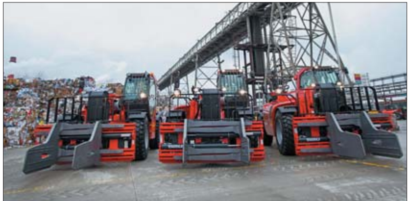
△ Najnowsze ładowarki teleskopowe Manitou pracujące w ostrołęckim zakładzie Stora Enso to modele MHT 10120 o udźwigu 12 ton
