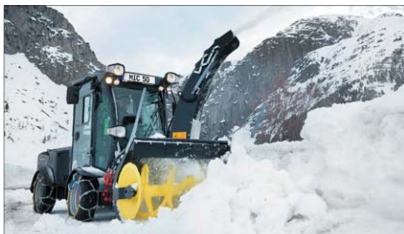
△ Pług wirnikowy to jedno z wielu narzędzi roboczych, jakie mogą być zamontowane na maszynie MIC 50. Przy jego wykorzystaniu możliwe jest dokładne odśnieżanie drogi bez tworzenia bocznych zasp
