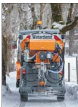
△ Niewielka szerokość maszyny MC 130 sprawia, że może być ona wykorzystywana na drogach i alejkach niedostępnych dla większych pojazdów
