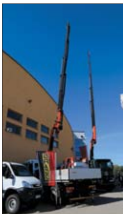
△ System Load Sensing uruchamia pompę hydrauliczną tylko wtedy, gdy wychylana jest dźwignia sterująca rozdzielacza odpowiadająca za realizację konkretnego ruchu roboczego. Silnik pojazdu przez większość czasu załączenia przystawki odbioru mocy nie jest więc obciążony, bo pompa pracuje tylko w trybie gotowości (tzw. Standby)
