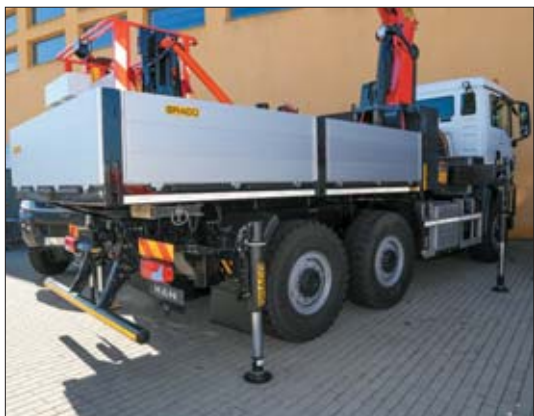
△ System Load Sensing uruchamia pompę hydrauliczną tylko wtedy, gdy wychylana jest dźwignia sterująca rozdzielacza odpowiadająca za realizację konkretnego ruchu roboczego. Silnik pojazdu przez większość czasu załączenia przystawki odbioru mocy nie jest więc obciążony, bo pompa pracuje tylko w trybie gotowości (tzw. Standby)
