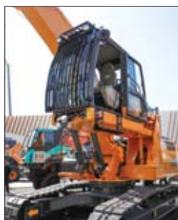
△ Konstrukcja mechanizmu podnoszenia zapewnia odpowiednią stabilność kabiny nawet w najwyższym położeniu, pozwalając na pełne wykorzystanie możliwości koparki
