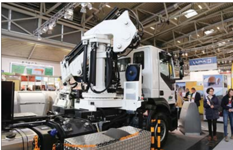
△ Teleskopowany maszt ma solidną podstawę obrotową, umożliwiającą bezpieczną obsługę pojemników o różnej wielkości i masie
