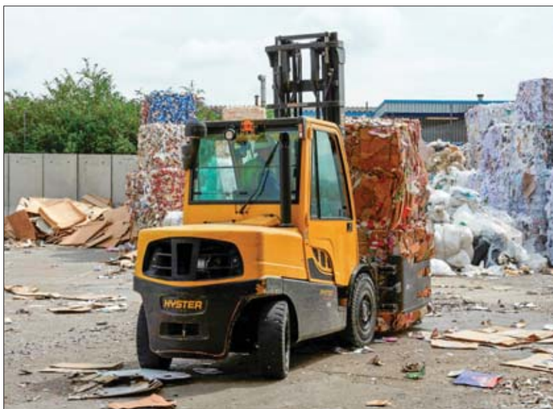
△ W wózku Hyster Cool Truck powietrze jest zasysane do silnika poprzez wstępny filtr zamontowany za kabiną w jej górnej części, a więc miejscu, gdzie jest najmniej lotnych zanieczyszczeń
