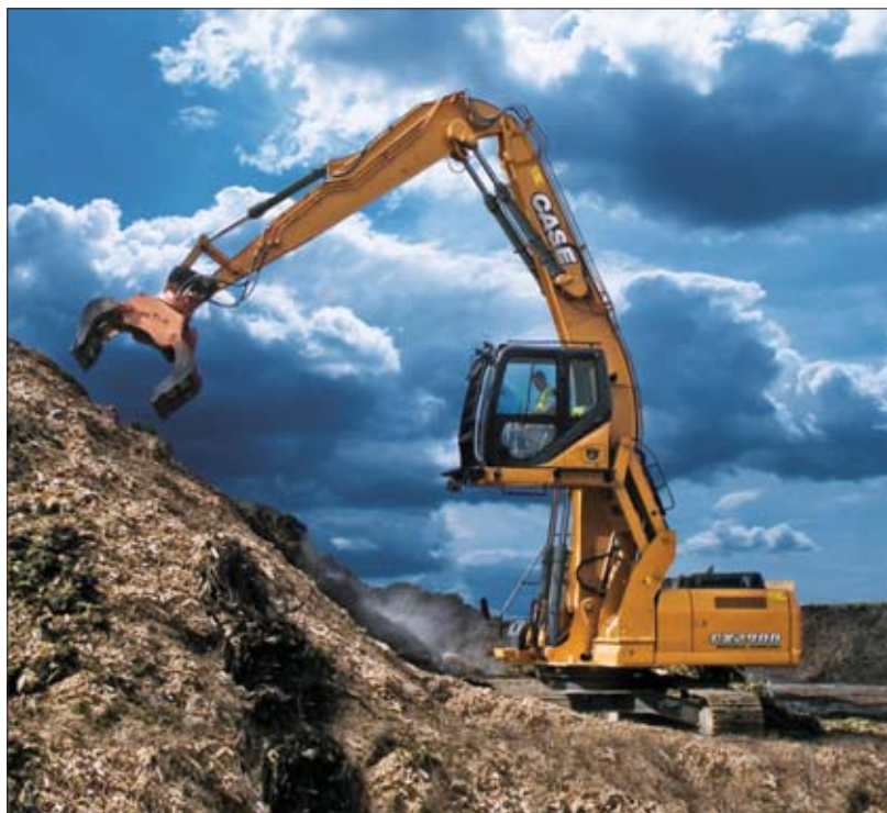
△ Przy zasięgu równym 9 m, koparka do prac przeładunkowych Case CX290D Material Handling dysponuje udźwigiem wynoszącym blisko 6.200 kg
