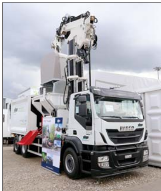
▷ Dzięki zastosowaniu teleskopowanego masztu składowanie do pozycji transportowej urządzenia opróżniającego pojemniki jest znacznie szybsze i prostsze, niż przy zastosowaniu tradycyjnego żurawia. Na zdjęciu pojazd zaprezentowany przez firmę VDL Translift
