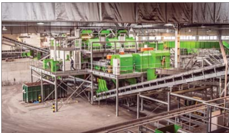
△ ZU w Szadółkach wyposażony jest w nowoczesną sortownię odpadów. Znajdujące się w niej urządzenia, w tym specjalistyczne separatory, pozwalają odzyskać surowiec, który następnie trafia do ponownego wykorzystania
