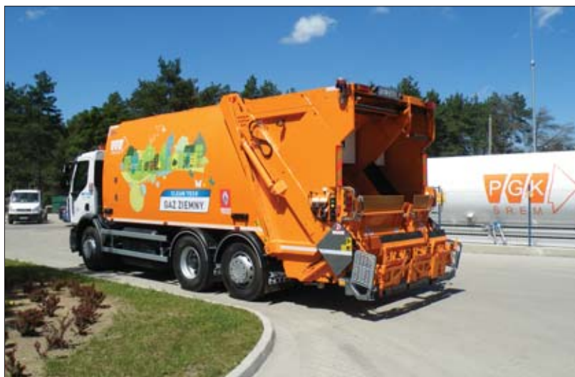
△ Przekazany w Śremie samochód występuje w konfiguracji 6x2, ma napęd na drugą oś oraz wleczoną skrętną trzecią oś, co w istotny sposób polepsza jego zdolności manewrowe
