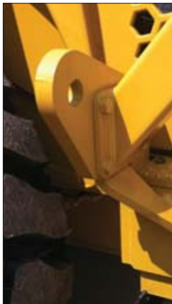
△ Ładowarka wyposażona jest w specjalny uchwyt, który ułatwia bezpieczny transport maszyny do wnętrza statku
