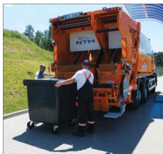
△ Przekazany w Śremie samochód występuje w konfiguracji 6x2, ma napęd na drugą oś oraz wleczoną skrętną trzecią oś, co w istotny sposób polepsza jego zdolności manewrowe
