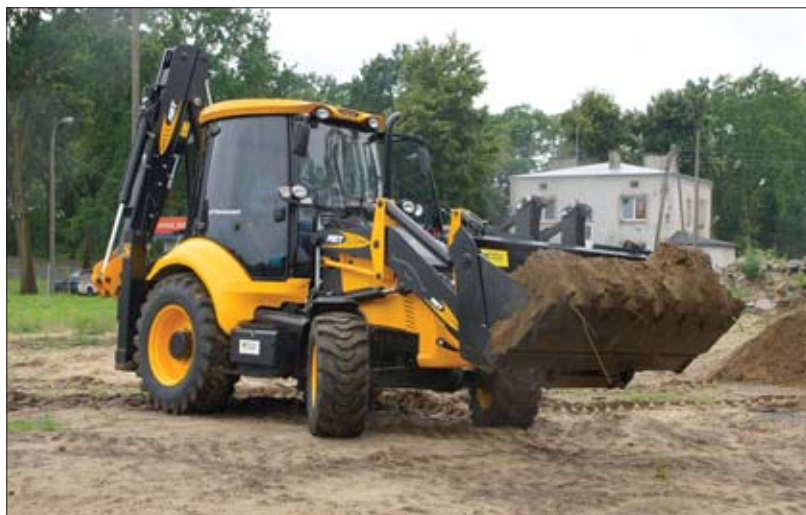
△ Zaletą koparko-ładowarki MST 642 są stosunkowo duże koła przednie. Takie rozwiązanie zapewnia lepszą trakcję podczas przemieszczania się w trudnym terenie
