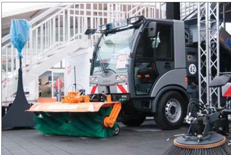
△ Szczotka walcowa ma za za- danie usunięcie wszystkich zanieczyszczeń, które znaj- dują się na trasie zmiatarki
