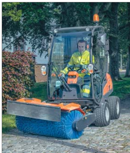
◁ Kompaktowe zmiatarki moż- na stosować nawet w miej- scach niedostępnych dla in- nych maszyn. Stosując odpo- wiedni osprzęt z powodze- niem oczyszczają powierzch- nię o różnorodnej strukturze
