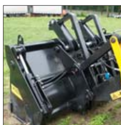
△ Szybkozłączące z przodu pozwala błyskawicznie odpiąć łyżkę ładowarkową
