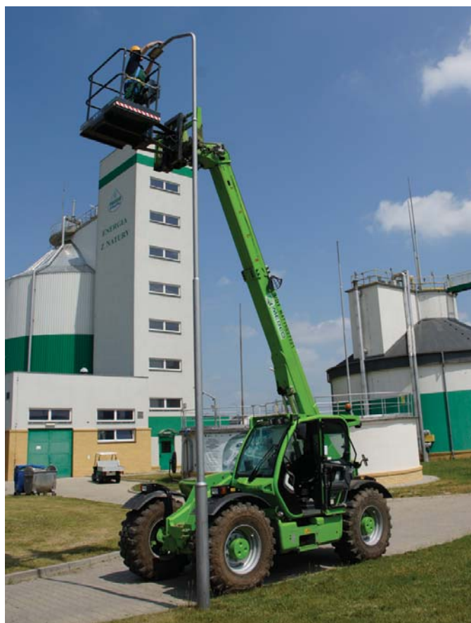
△ Dzięki zaawansowanym systemom stabilizacyjnym, brak podpór nie przeszkadza operatorowi bezpiecznie pracować w koszu roboczym
