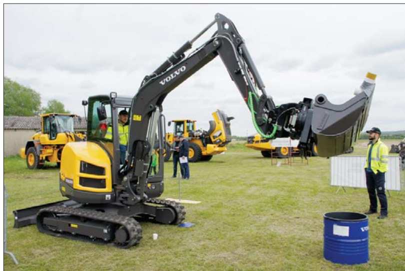
▽ W tym roku do konkursowych zmagani wybrano koparkę gąsienicową Volvo EC 35D. Maszyna z racji kompaktowych wymiarów i znaczących osiągnięć cieszy się dużym uznaniem firm pracujących w ograniczonych przestrzeniach, na przykład osiedlach mieszkaniowych oraz ciągach komunikacyjnych
