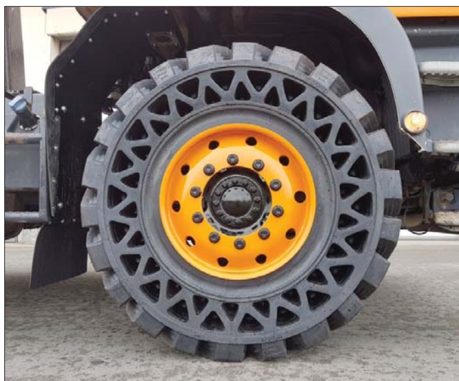
△ Opony SolidAir ze specjalnie zaprojektowanymi otworami w ścianie bocznej pozwalają osiągnąć komfort jazdy porównywalny do uzyskiwanego przy zastosowaniu opony pneumatycznej, zachować odpowiednią stabilność oraz ograniczyć zużycie elementów przenoszenia napędu pojazdu
