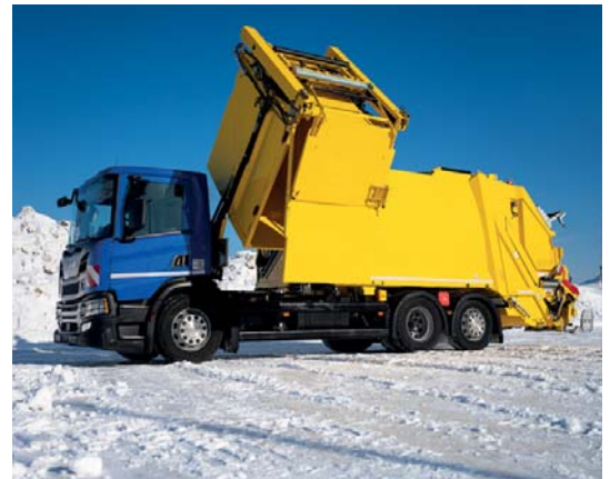
▷ Dodatkowa komora opróżniana jest przez operatora, za pomocą jednego przełącznika, a cały proces odbywa się automatycznie
