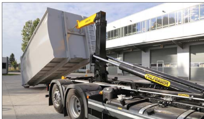
△ Przykładami rozwiązań zwiększających efektywność pracy są system łagodnego układania kontenera do pozycji transportowej Soft Stop oraz rama o „stałej” wysokości, gwarantująca niskie położenie środka ciężkości załadowanego pojazdu.
