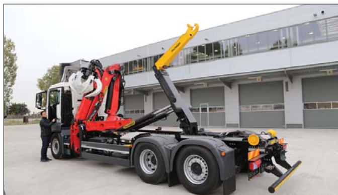
▷ Bardzo często ramię załadownicze jest montowane na jednym podwoziu razem z np. żurawiem do złomu. Na zdjęciu obok MAN TGS 28.440 z zamontowanym żuraw Epsilon typu Q150Z96 oraz urządzeniem hakowym Palfinger T20
