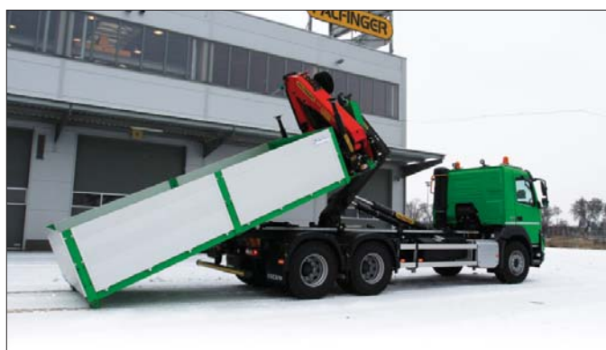
△ Unikatowym rozwiązaniem jest zamontowanie żurawia Palfinger PK23001-Eh nie bezpośrednio na podwoziu, a na specjalnym kontenerze
