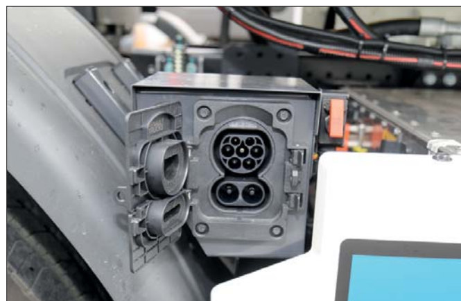
△ Gniazdo ładowania jest umieszczone po lewej stronie pojazdu. Kierowca ma do niego łatwy dostęp, co sprawia, że może błyskawicznie rozpocząć proces ładowania wpinając do gniazda odpowiednią wtyczkę
