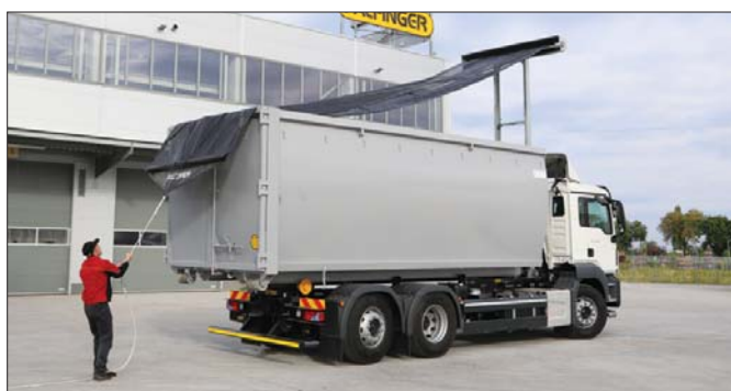
△ Palcover to unikatowa konstrukcja opracowana przez firmę Palfinger składająca się z potrójnie teleskopowanego masztu, zakończonego rolką z nawiniętą siatką. Całość jest umieszczona poprzecznie tuż za kabiną i zajmuje niewiele miejsca. Przy zastosowaniu tego systemu nie trzeba „zarzucać” siatki na kontener, a uniesienie jej za pomocą masztu eliminuje ryzyko uszkodzeń spowodowanych ostrymi odpadami wystającymi poza obrys skrzyni
