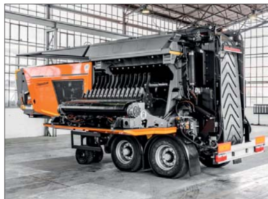
▷ Wielką zaletą modelu Inventhor Type 6 jest całkowicie otwierana ściana boczna komory rozdrabniającej, co radykalnie upraszcza i zwiększa bezpieczeństwo podczas wymiany zębów rozdrabniających, a także przy wszelkich czynnościach serwisowych i konserwacyjnych
