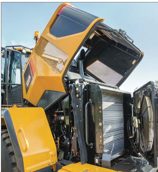
△ Szeroko odchylana pokrywa daje nieskrępowany dostęp do niewralgicznych komponentów, co ułatwia wykonanie prac konserwacyjnych i serwisowych
