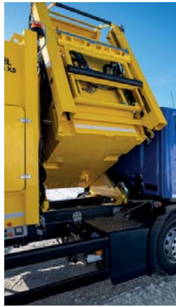
△ Warto pamiętać, że montaż dodatkowej komory za kabiną pojazdu możliwy jest także w przypadku śmieciarki jednokomorowej
