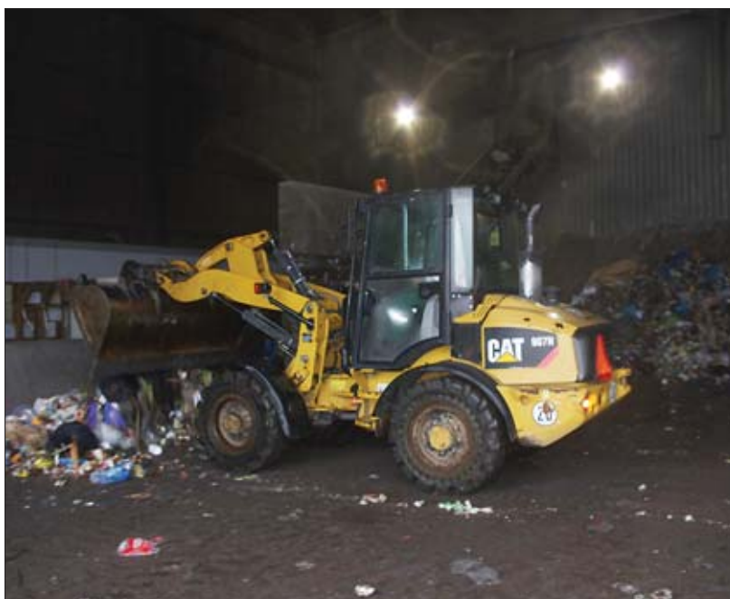
△ Ładowarka Cat 907H przy załadunku odpadów na taśmociąg jest szybka i efektywna, a kompaktowe rozmiary ułatwiają poruszanie się jej na małej powierzchni
