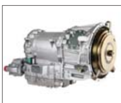
▽ W pełni automatyczna skrzynia biegów Allison serii 3000 przeznaczona jest do współpracy z silnikami o mocy do 336 kW (450 KM). Oferuje maksymalnie siedem przełożeń, w tym dwa nadbiegi
