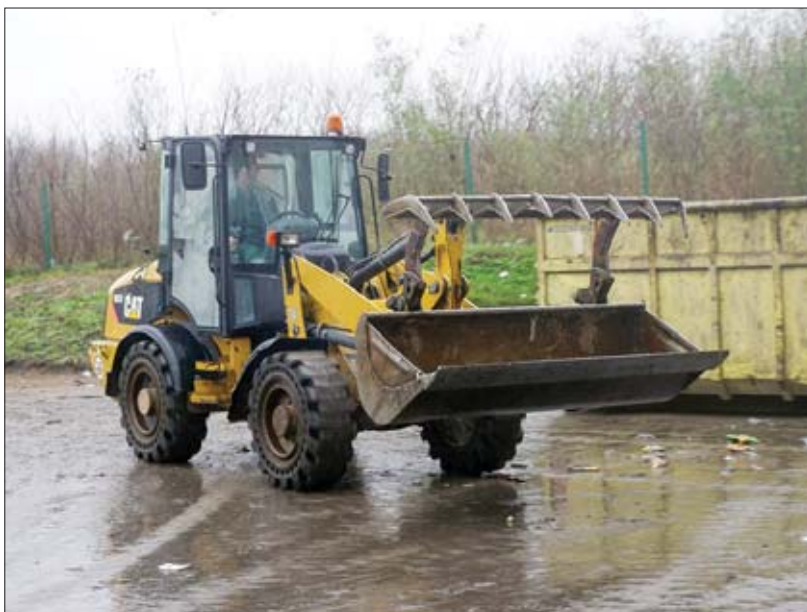
△ Ładowarka przegubowa została wyposażona w łyżkę z hydraulicznym zabezpieczeniem przewożonego ładunku, dodatkowo zwiększającym objętość narzędzia roboczego
