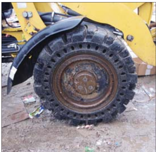
◀ Pełne opony w ładowarce Cat 907H to najlepsze rozwiązanie do pracy w trudnych warunkach. Nie sprawdziły się opony pneumatyczne i piankowe
