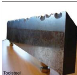
Porównanie noży ze stali narzędziowej i stali Hardox® po 48 godzinach pracy
