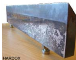
Porównanie noży ze stali narzędziowej i stali Hardox® po 48 godzinach pracy
