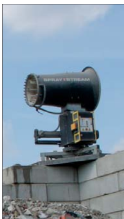
△ Zamontowany na komorze nawilżacz rozpylając wodną kurtynę ogranicza rozprze- strzanie się pyłu
