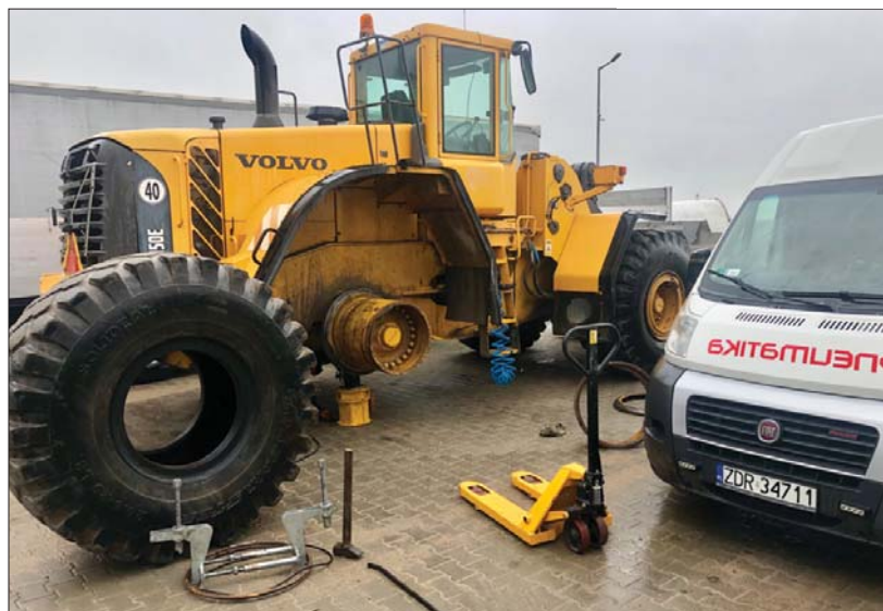
▷ Prasa umożliwia wymianę zniszczonych, pełnych opon super elastycznych o rozmiarze od 8 do 24 cali. W dodatku radzi sobie ze wszystkimi rodzajami pełnych opon, bez względu na rodzaj materiału, z którego są zrobione
