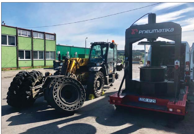
△ Prasa Pneumatika pozwala zaoszczędzić na kosztownym transporcie kół do stacjonarnego serwisu
