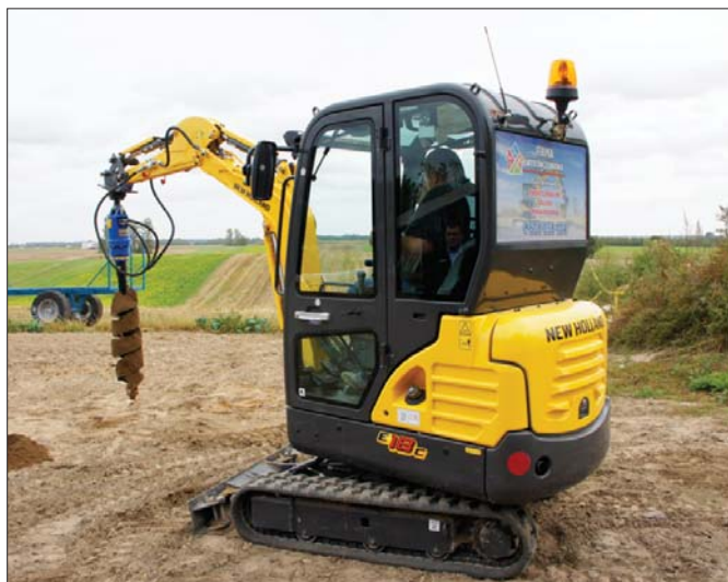
△ Do minikoparek New Holland istnieje cała gama dodatkowego osprzętu roboczego, który pozwala na wykorzystanie tych maszyn w wielu zastosowaniach
