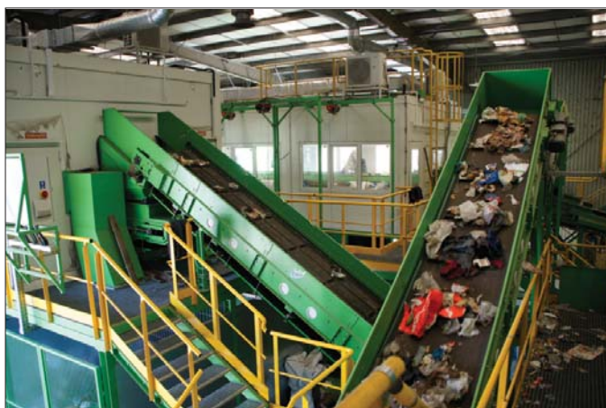
△ Separator BALLISTOR jest w stanie w jednym ciągu produkcyjnym, automatycznie rozdzielić materiał na frakcje dwuwymiarową, trójwymiarową oraz podsitową
