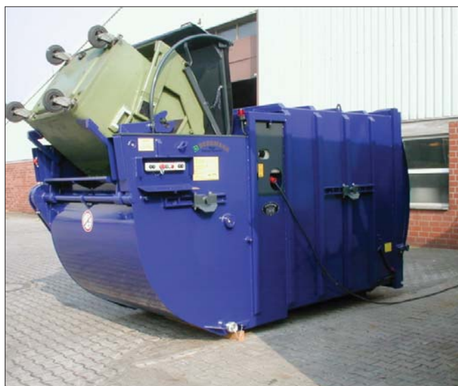
△ Załadunek prasokontenerów może odbywać się ręcznie lub przez wywrotnicę
