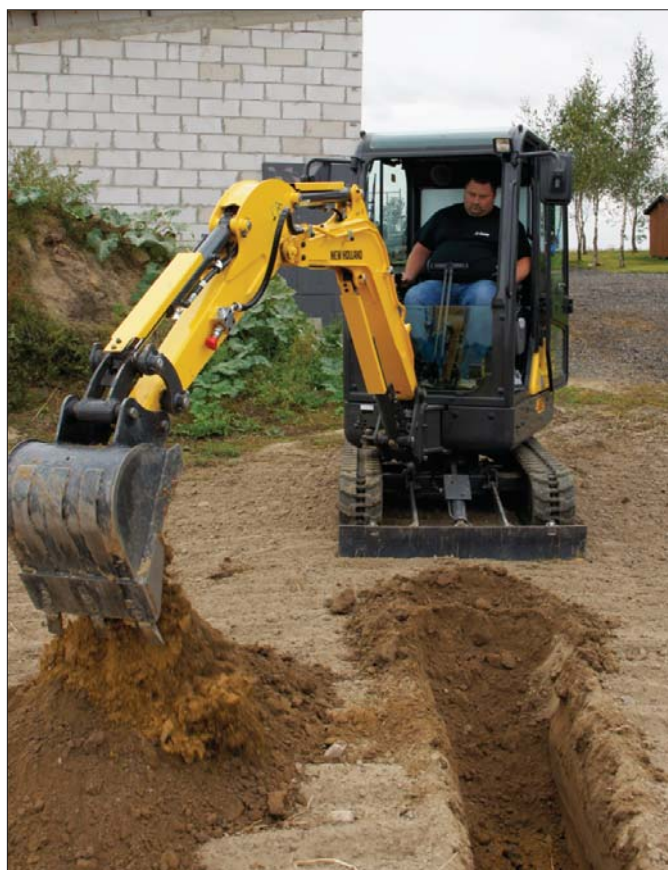
△ Poza kabiną różnice pomiędzy wersją B i C widoczne są także w sposobie rozmieszczenia przewodów hydraulicznych zasilających napęd. W modelach serii B są nieosłonięte, a w C zostały umieszczone wewnątrz ramy podwozia
