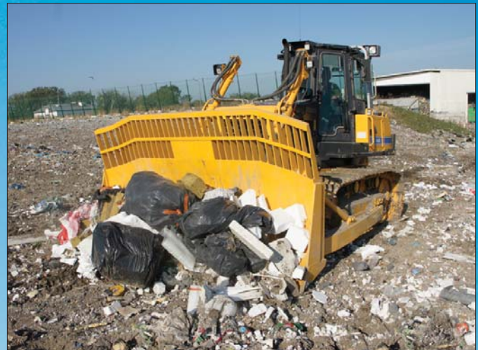
▲ Ażurowa nadstawka lemieszka jest dostępna w standardowej specyfikacji spycharek Dressta kierowanych do pracy na składowiskach odpadów
