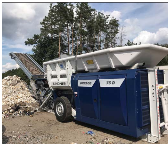
△ Mobilne rozdrabniacze Lindnera mają możliwość dopasowania parametrów roboczych do różnego rodzaju przetwarzanych materiałów
