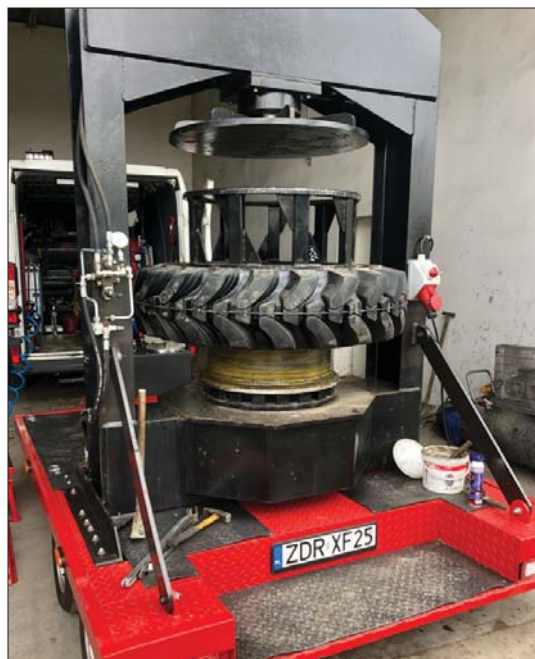
◁ Autorski projekt prasy daje możliwość wymiany opon o rozmiarze 24 cali
