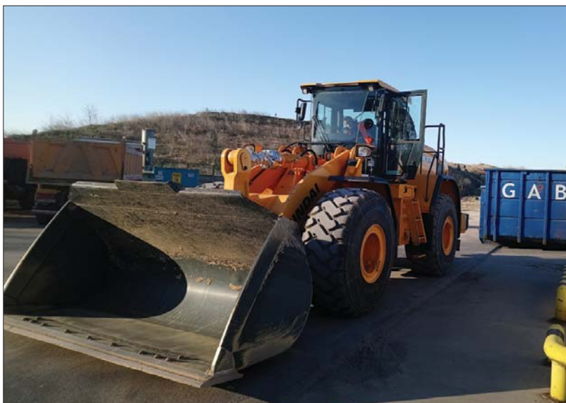
▽ Ładowarka HL970 może być wyposażona w łyżkę o pojemności sięgającej nawet pięciu metrów sześciennych
