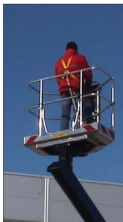
△ Kosz ma udźwig 250 kilogramów, co w pełni wystarcza do w pełni bezpiecznej pracy jednej osoby i transportowania niezbędnych narzędzi
