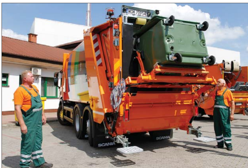
△ Obsługujący śmieciarkę Medium XL-SiB mogą ustawiać położenie ramion dopasowując je do rozmiaru pojemnika
