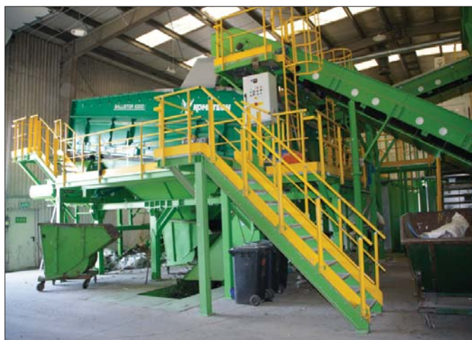
△ Separator balistyczny BALLISTOR był brakującym ogniwem linii do selekcji materiałów pochodzących ze strumienia odpadów komunalnych
