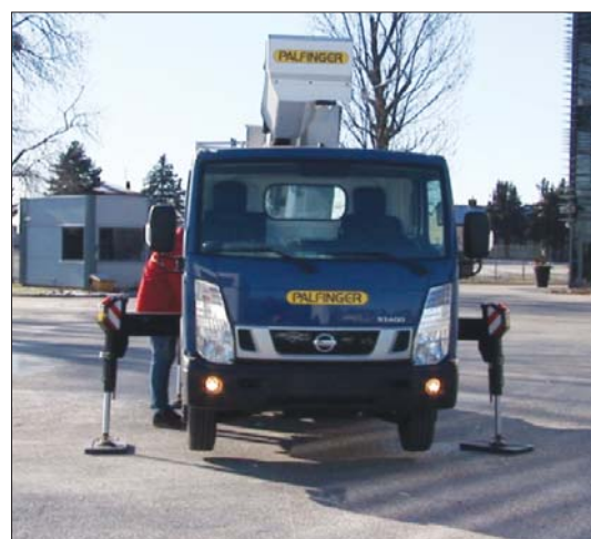
△ Wysięgnik podnośnika składa się w kształt trójkąta, co pozwala w znaczącym stopniu zmniejszyć całkowitą długość pojazdu. W pozycji transportowej wynosi ona tylko 5,39 metra
