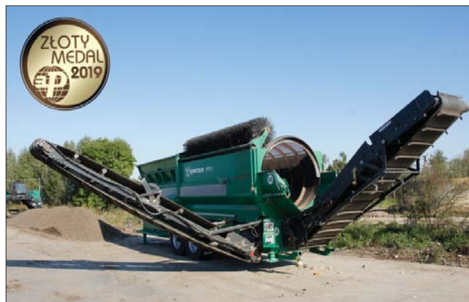
△ Mobilne sito bębnowe pracuje w zakładzie utylizacyjnym pod Łęczną od ponad roku. Tak jak i pozostałe maszyny Komptechu jest niezawodne i ekonomiczne
