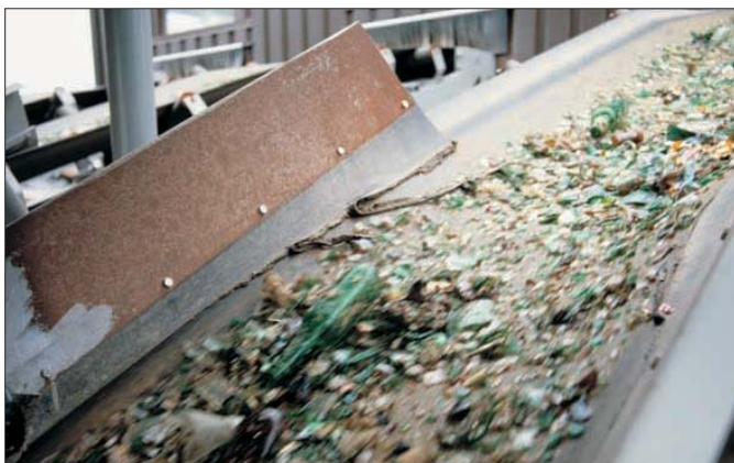
△ W sortowniach odpadów oraz zakładach recyklingowych sprawdzają się tylko taśmy najwyższej jakości
