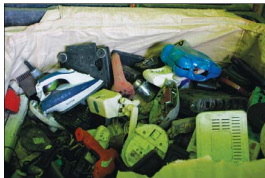
▷ Pracownicy Zakładu Zagospodarowania odpadów w Marszowie ze strumienia odpadów ręcznie wybierają te elementy, które zawierają w sobie cenne metale nieżelazne. Są to najczęściej kable, ale też elektroniczne i elektroniczne przedmioty codziennego użytku. Dopiero tak wyselekcjonowane elementy trafiają na linię do recyklingu kabli
