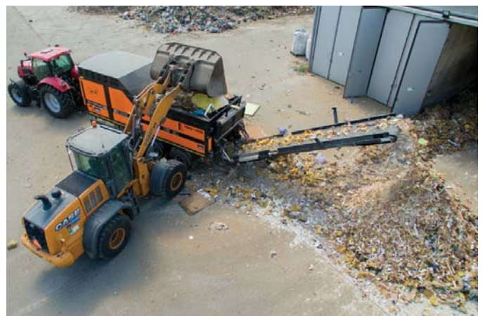
△ Kosze nasypowe mobilnych rozdrabniaczy Pronaru są dostosowane do parametrów różnej wielkości ładowarek
