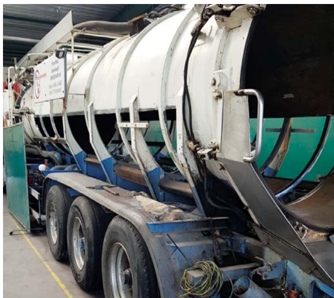
△ Zaplecze serwisowe Grupy STOKOTA umożliwia przeprowadzanie różnego rodzaju prac, między innymi wymianę poszycia zbiornika
