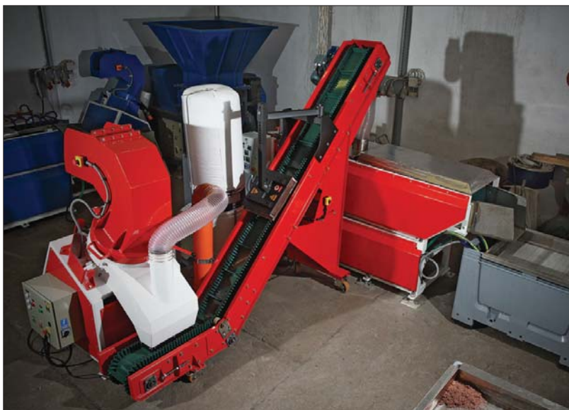
△ Linia do recyklingu kabli składa się z młyna rozdrabniającego, transportera taśmowego i separatora wodnego
