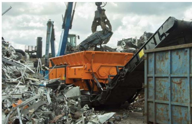
△ Rozdrabniacze Pronaru radzą sobie również z nietypowymi odpadami wielkogabarytowymi. Poza różnego typu elementami drewnianymi, mogą też skruszyć karoserię samochodu i inne metalowe przedmioty
