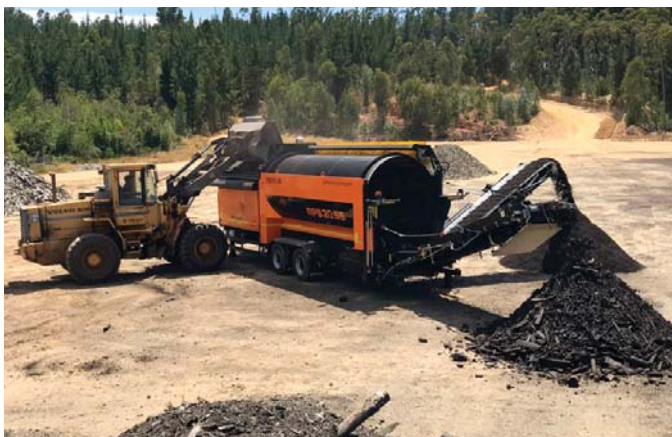
△ Przesiewacze mogą być zabudowane na podwoziu kołowym lub gąsienicowym. Solidna konstrukcja umożliwia im pracę z różnego typu materiałami
