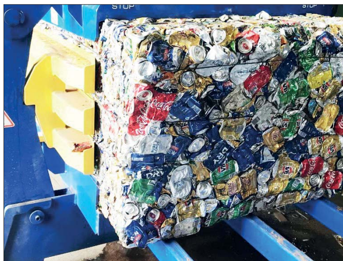
△ Urządzenia Bartontech usprawniają pracę. Cały proces formowania bali wraz z jej wiązaniem odbywa się automatycznie
