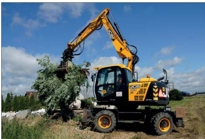
△ Koparka kołowa wyposażona w odpowiedni chwytak jest doskonałym narzędziem ułatwiającym prace związane z zagospodarowaniem terenu
