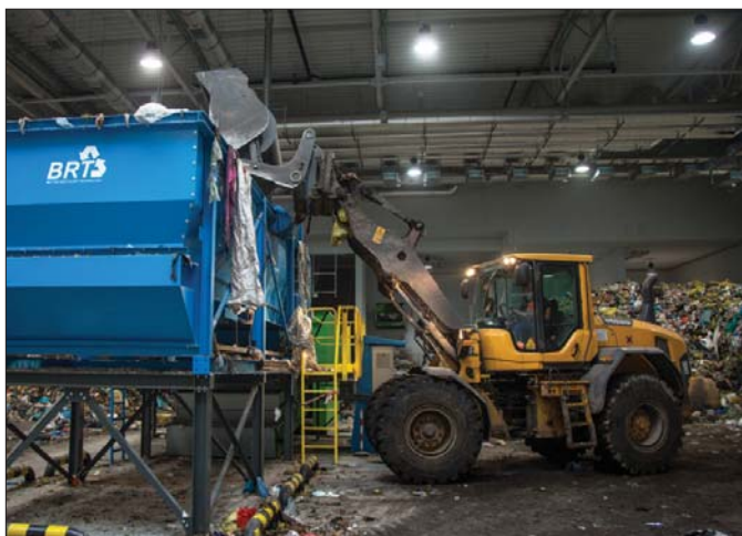
△ łyżka wysokiego wysypu na ładowarce dysponującej odpowiednią długością ramion ułatwia sprawny załadunek dowolnego kontenera i koszy zasypowych urządzeń recyklingowych
