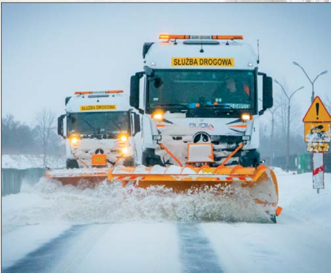
△ Lemiesz zgarniający metalowe, perforowane używa się do zdarcia lodu, a lemiesz gumowe, aby usunąć śnieg
