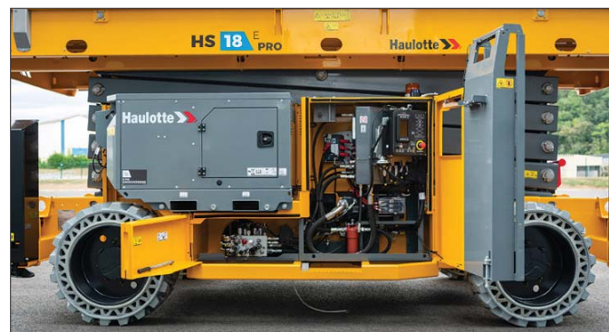
▼ Zapewnienie nieskrępowanego dostępu do wszystkich niewralgicznych podzespołów i punktów serwisowych ułatwia codzienną obsługę podnośników
