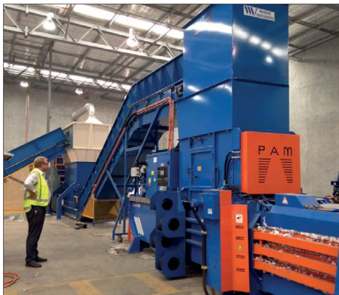
△ Automatyczne belownice serii SUPER stanowią istotny element wyposażenia nowoczesnej i wydajnej linii sortowniczej
