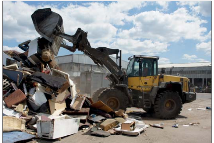
△ Inżynierowie Dekpol Steel zaprojektowali łyżkę, która optymalnie spełnia potrzeby bydgoskiej instalacji komunalnej. łyżka została dopasowana nie tylko do parametrów ładowarki, ale także właściwości materiału, który jest w niej przenoszony
