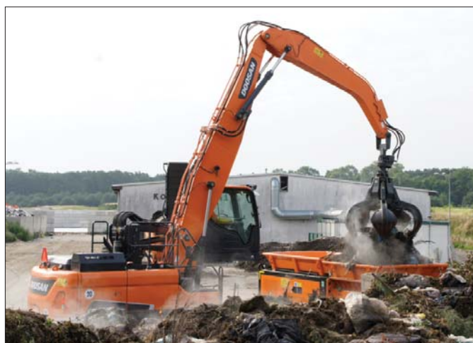
△ W Kunowicach Doosan jest wykorzystywany przede wszystkim do przeładunku frakcji biodegradowalnej oraz zmieszanej
