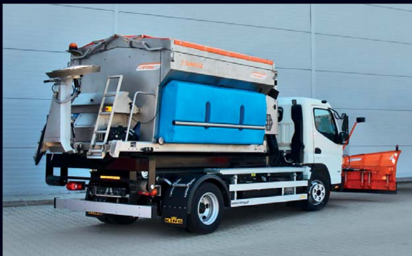
▲ Posypywarki IceSTORM przeznaczone są do stosowania z pojazdami o masie powyżej 7.500 kg
