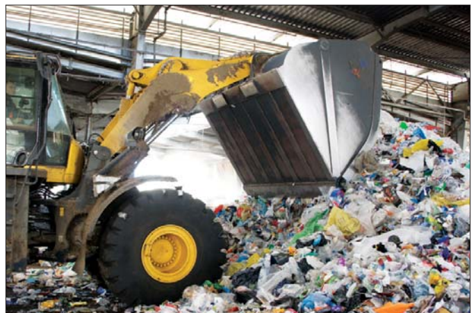
△ Dzięki łyżcei o zwiększonej pojemności do przemieszczenia takiej samej ilości odpadów potrzeba znacznie mniejszej liczby kursów. Narzędzie wykonano z materiałów najlepszej jakości, co potwierdza certyfikat Hardox In My Body
