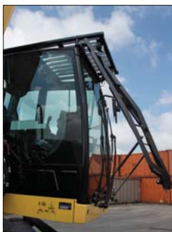
△ Kabina operatora jest podnoszona na wysokość blisko 2,5 metra, posiada wydajny układ ogrzewania i klimatyzacji, a specjalne filtry sprawiają, że do wnętrza nie dostają się szkodliwe pyły
