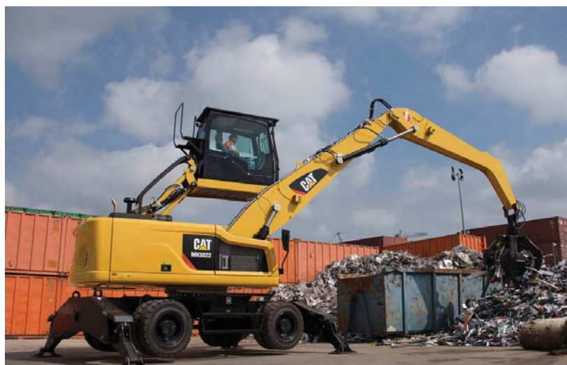
▽ Maszyny Caterpillar pracujące na złomowiskach i w sortowniach odpadów wyposażone są w zsynchronizowany z układem napędowym system hydrauliki. Dzięki temu osiągają wysokie parametry robocze, a jednocześnie zużywają mniej paliwa
