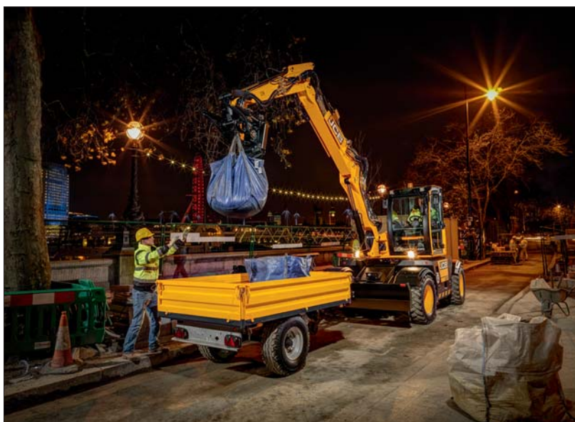
△ W zależności od zastosowanego osprzętu koparka Hydradig 110W może realizować różne zadania. Także ciągnika, gdyż mocny silnik umożliwia jazdę z prędkością 40 km/h i holowanie ładunków o masie do 3,5 tony
