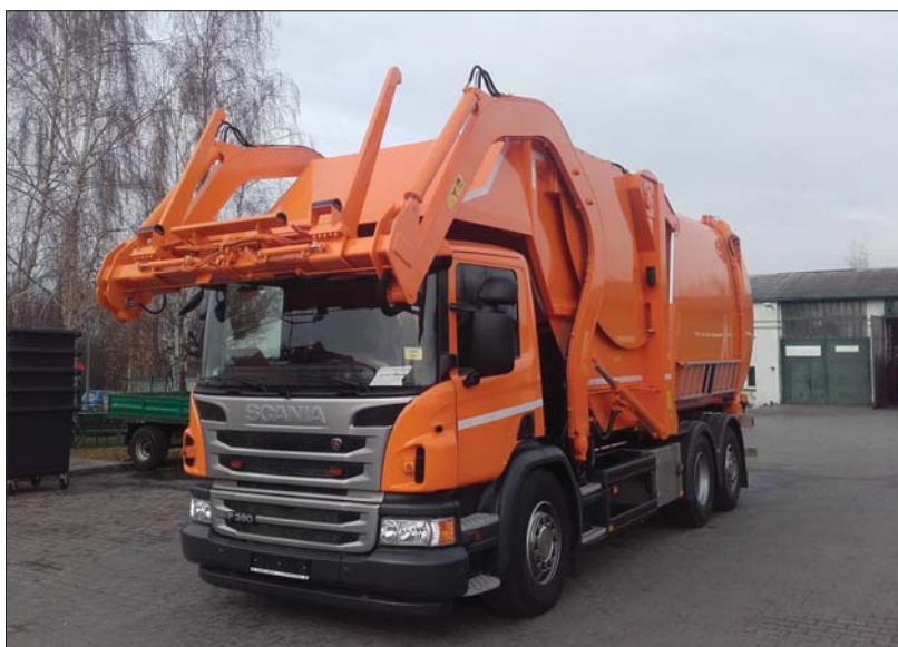
△ Śmieciarki ładowane od przodu mają duże wysięgniki, które unoszą pojemniki, a śmieci wpadają bezpośrednio do otworu znajdującego się w górze zabudowy
