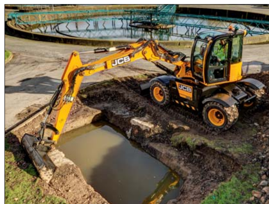
△ W zależności od zastosowanego osprzętu koparka Hydradig 110W może realizować różne zadania. Także ciągnika, gdyż mocny silnik umożliwia jazdę z prędkością 40 km/h i holowanie ładunków o masie do 3,5 tony
