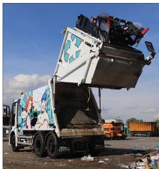
△ Śmieciarki ładowane od przodu mają duże wysięgniki, które unoszą pojemniki, a śmieci wpadają bezpośrednio do otworu znajdującego się w górze zabudowy
