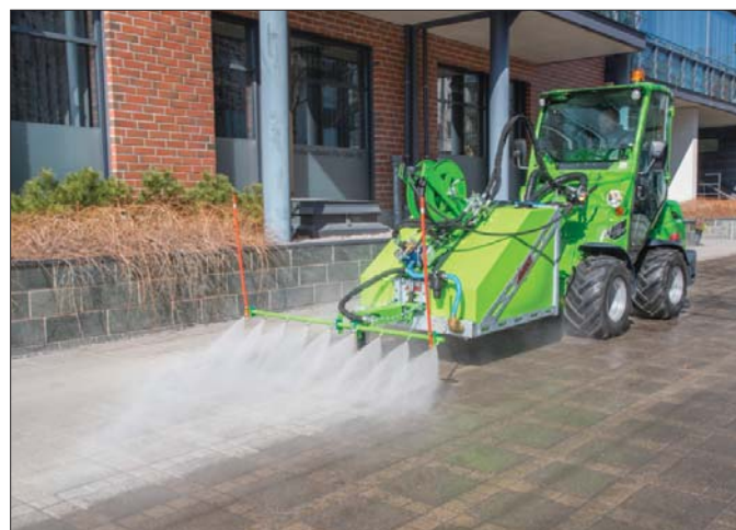
△ Ogromna liczba dodatkowego oprzyrządowania sprawia, że ładowarki Avant stają się uniwersalnymi nośnikami osprzętu roboczego
