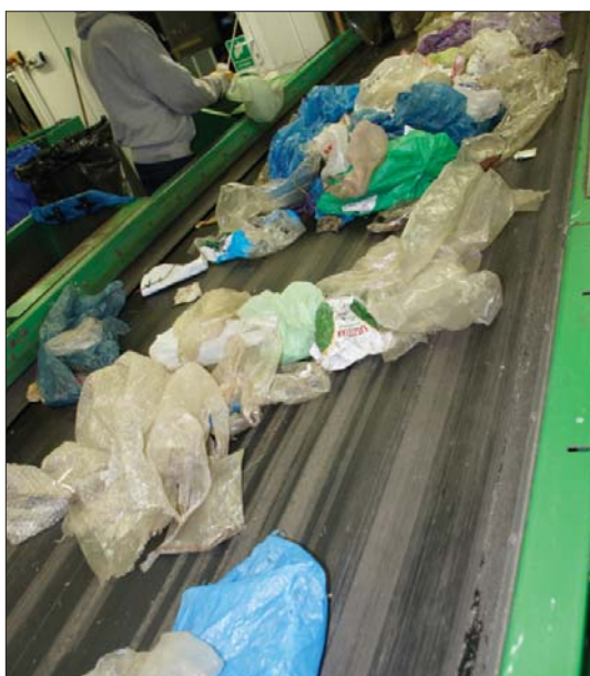
◁ Technologia użyta do produkcji taśm ContiTech umożliwia rozprzestrzenianie się ognia, gdyż pasy są samogasnące. Ta właściwość to przede wszystkim większe bezpieczeństwo pracowników, ale też pomocna cecha w uzyskaniu pozytywnej opinii straży pożarnej
