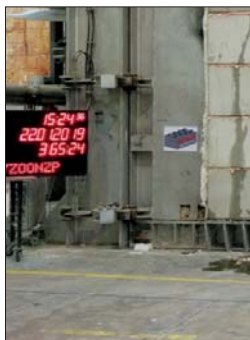
△ Certyfikat REI 360 BetBlok System uzyskał po drobiazgowym badaniu przez Instytut Techniki Budowlanej
