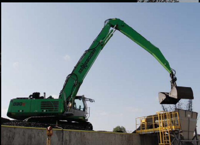
▲ Nowy nabytek pruszkowskiej elektrociepłowni imponuje niskim spalaniem. Podczas nawęglania pieców zużywa średnio 7-8 litrów oleju napędowego na godzinę
