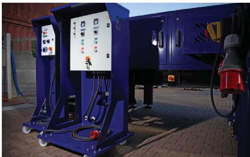
△ Rotor zamknięty jest w nieprzepuszczalnej obudowie z kompozytów włókien szklanych. Napędza go silnik elektryczny w pełni kontrolowany przez szafę sterowniczą, która umożliwia precyzyjne ustalenie prędkości rotora oraz taśmy transportowej
