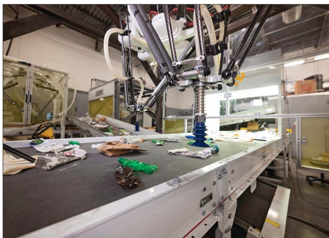
△ Roboty są w stanie skutecznie oddzielać różnorodne materiały, a do tego robią to z szybkością – 80 pobrań na minutę (w przypadku robota jednoramiennego) i 160 pobrań (dwuramienny)
