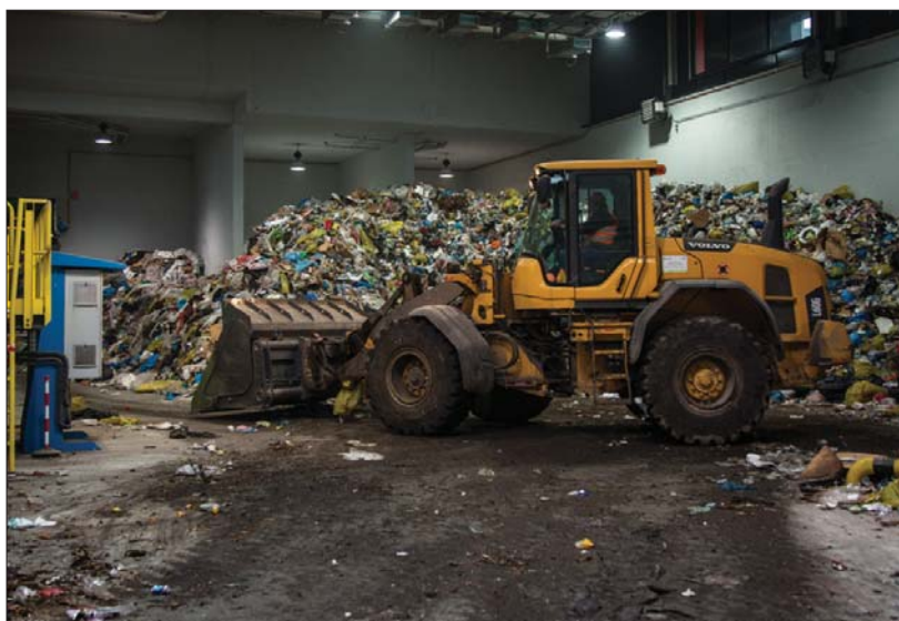
▽ Odpowiednio dobrana szerokość łyżki umożliwia nie tylko efektywną pracę, ale także chroni opony maszyny przed zniszczeniem
