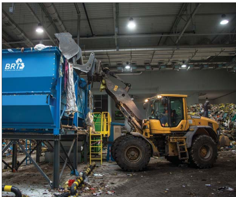
△ łyżka wysokiego wysypu na ładowarce dysponującej odpowiednią długością ramion ułatwia sprawny załadunek dowolnego kontenera i koszy zasypowych urządzeń recyklingowych
