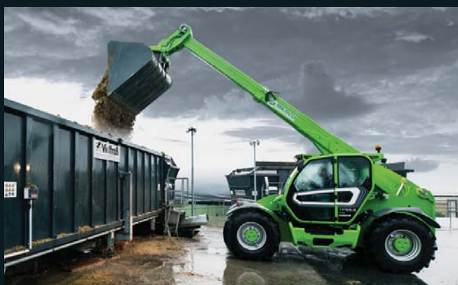
▲ Jedną z zalet ładowarek teleskopowych jest łatwość załadunku wszelkiego typu kontenerów
