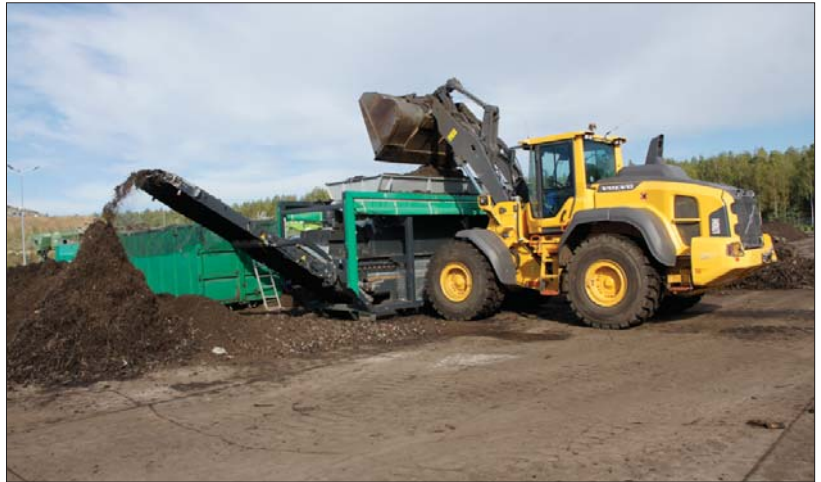
△ Wydłużone ramiona wysięgnika w połączeniu z łyżką wysokiego wysypu umożliwiają operatorowi wykonywanie różnorodnych prac
