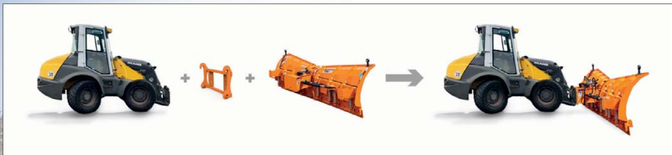
△ Pług SaMASZ to nie tylko efektywność, ale też wygoda użytkowania. Przede wszystkim trzeba zwrócić uwagę na unikatowy, opatentowany przez SaMASZ, system agregowania pługów. Otóż do łączenia produktów serii CITY, UNI, PSV, RAM, AlpS i OLIMP stosowana jest ramka, pozwalająca na szybką wymianę zaczepu po odkręceniu tylko 8 śrub. Dodajmy, że można je łączyć z wieloma pojazdami komunalnymi i maszynami budowlanymi
