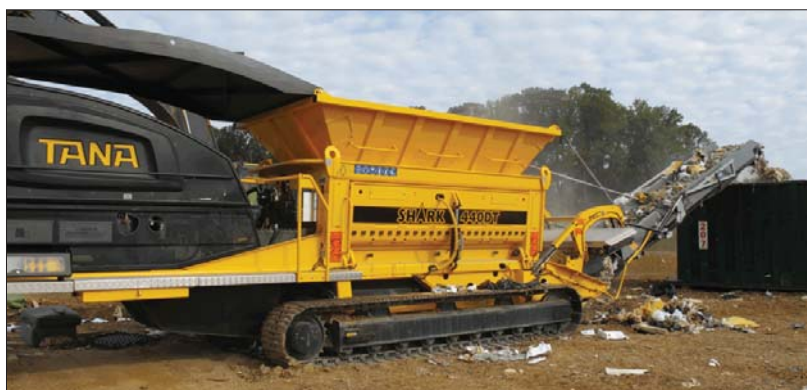
△ Rozdrabniacze TANA Shark to prawdziwe rekiny, których zęby zdolne są uporać się z dowolnym materiałem trafiającym na składowiska instalacji komunalnej
