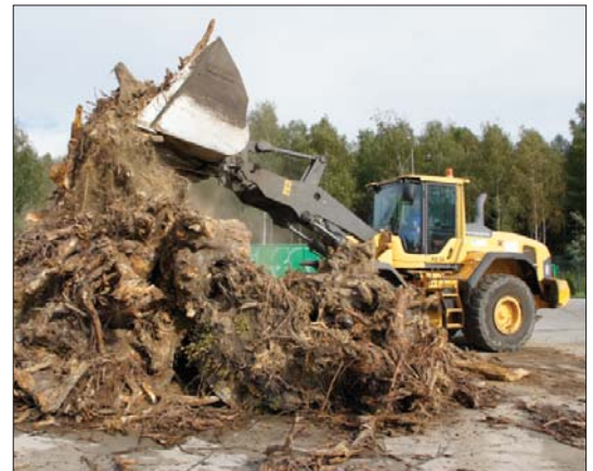
△ Wydłużone ramiona wysięgnika w połączeniu z łyżką wysokiego wysypu umożliwiają operatorowi wykonywanie różnorodnych prac
