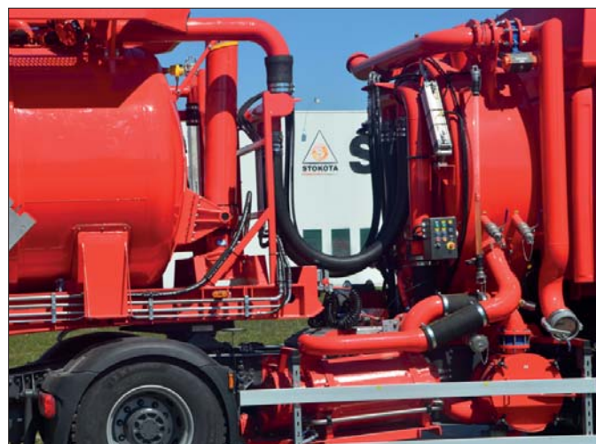
△ Naczepa asenizacyjna jest połączona z ciągnikiem siodłowym za pomocą przyłączy elektrycznych i pneumatycznych
