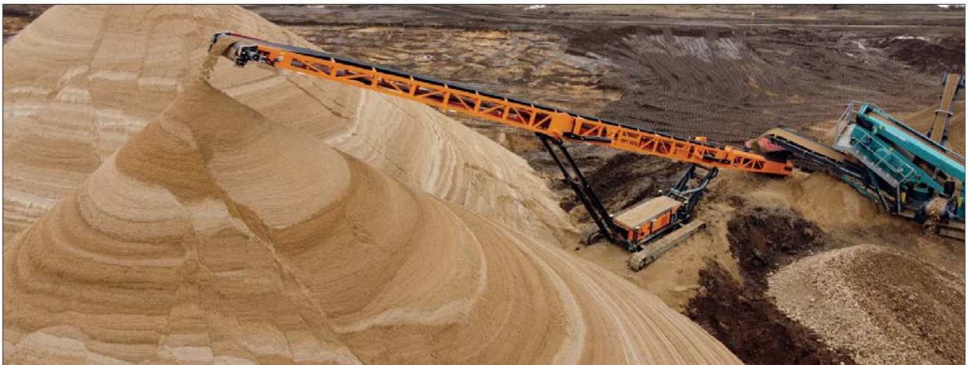
△ Model MPT 30/lg jest najdłuższym mobilnym przenośnikiem taśmowym produkowanym w fabrykach Pronaru. Umożliwia usypywanie przyzmy o wysokości maksymalnej 13 metrów
