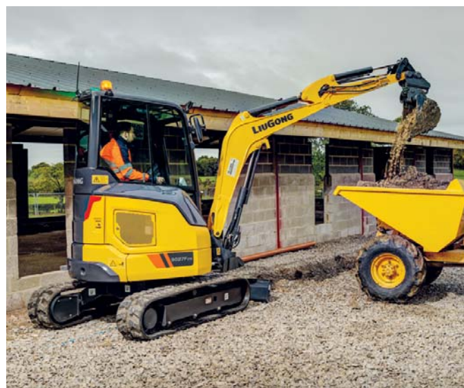
△ Podczas obrotu tylna część maszyny nie wystaje poza obris gąsienic. Dzięki temu operator może kopać tuż przy maszynie, wzdłuż muru i innych przeszkód
