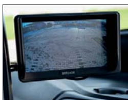
△ Bezpieczną pracę ułatwiają kamery umożliwiające monitorowanie obszaru wokół pojazdu
