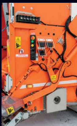
▲ Elementy sterujące opróżnieniem pojemnika oraz jego mycia są z boku zabudowy
