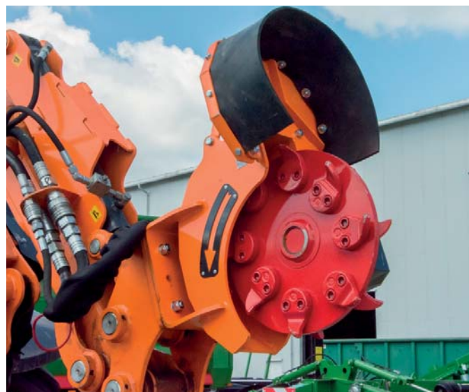
△ Po obu stronach tarczy roboczej znajduje się szesnaście wymiennych noży, umożliwiających frezowanie pni w obu kierunkach
