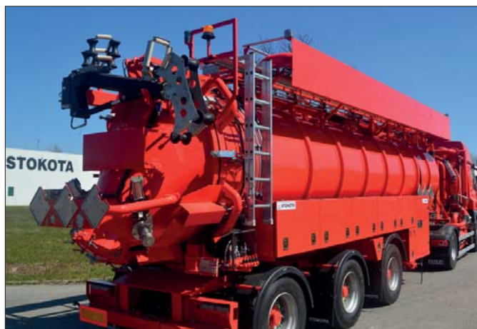
△ Na tylnej dennicy, poza zaworami, znajduje się także ruchome ramię, którym prowadzony jest wąż ssący
