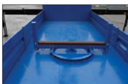
△ W „energetycznej” zabudowie skrzyniowej znalazła się także obrotnica do przewożenia słupów o nośności 5 ton
