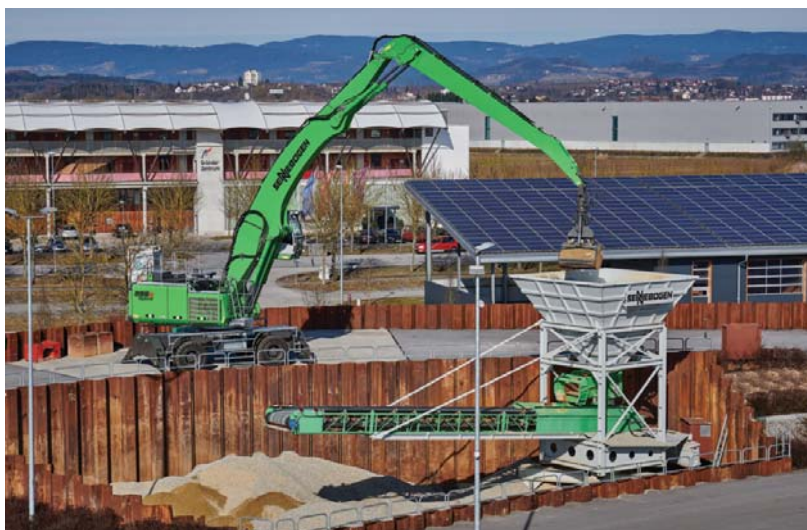
△ Duży zasięg ramienia oraz niezbyt duże wymiary umożliwiają maszynie pracę nawet w ograniczonych przestrzeniach portów i placów przeładunkowych
