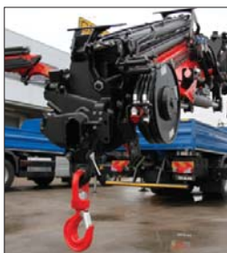
△ Podstawowy wysięgnik żurawia Palfinger PK65002-SH ma aż pięć sekcji wysuwanych hydraulicznie, co w efekcie daje zasięg 13,6 metra
