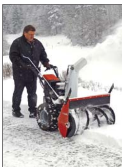
△ W zimie jednoosiowe ciągniki marki Koppl, w połączeniu z pługiem wirnikowym umożliwiają wygodne odśnieżanie chodników i innych ciągów komunikacyjnych
