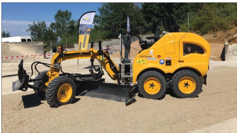
△ Równiarki Easy Grader są bardzo zwrotne i mogą pracować w miejscach niedostępnych dla większych maszyn
