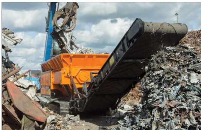
△ Rozdrabniacz MRW 2.1010 to jeden z największych i najmocniejszych maszyn na rynku. Potężny silnik oraz wytrzymały wał umożliwiają rozdrabnianie elementów metalowych, w tym karoserii samochodowych
