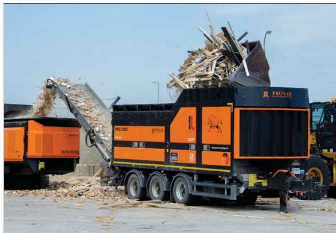
△ Najnowszym mobilnym rozdrabniaczem Pronaru jest jednowalowy MRW 1.300. Maszyna doskonale radzi sobie z wszelkimi odpadami drewnianymi
