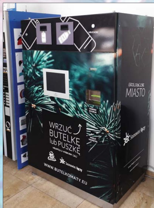
▷ Nowoczesne recyklaty to urządzenia, które potrafią posegregować opakowania pod względem koloru i rodzaju surowca. W efekcie metalowe puszki i butelki PET trafiają do oddzielnych pojemników
