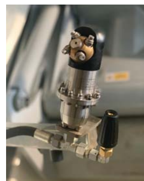
△ Ramiona z głowicami myjącymi ▽ oraz dyszami „Turbo”
