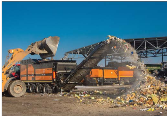
△ Zaletą wszystkich mobilnych rozdrabniaczy jest łatwość ich transportu. Dzięki temu można szybko je ustawiać w różnych miejscach składowiska i przewozić do innych lokalizacji
