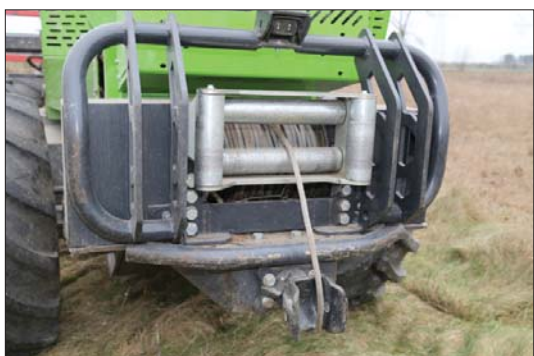
◁ W tylnej części maszyny zainstalowano wciągarkę hydrauliczną o udźwigu wynoszącym dwanaście ton
