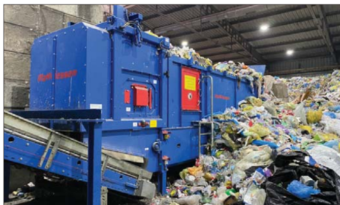
△ Zestaw Matthiessena składający się z rozrywarki worków oraz separatora folii zwiększa stopień odzysku wartościowych surowców przy jednoczesnym ograniczeniu bieżących kosztów eksploatacyjnych
