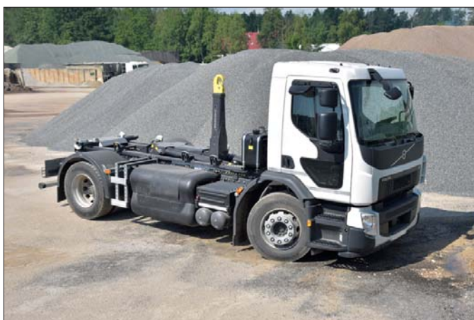
△ Ładowność 8 i 12 ton urządzeń hakowych produkowanych przez KH-KIPPER umożliwia stosowanie ich w różnorodnych zastosowaniach komunalnych
