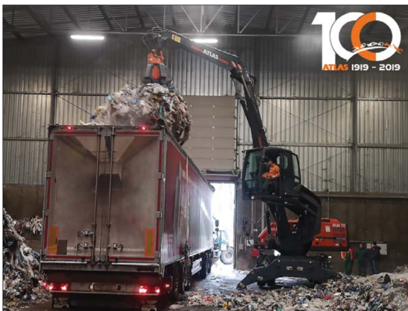
△ Dużą zaletą w maszynach przeładunkowych ATLAS jest unoszona kabina. Ułatwia ona operatorowi załadunek oraz transport materiałów. Zwiększa też bezpieczeństwo, gdyż daje lepszą widoczność na cały obszar wokół maszyny
