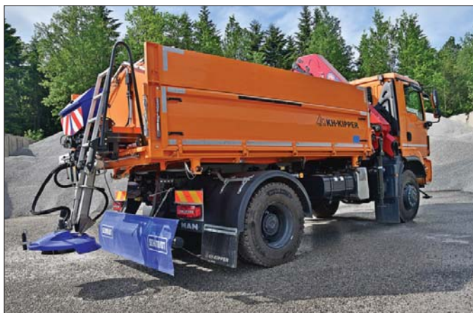
△ Trójboczne zabudowy samowyładowcze można wykorzystywać zarówno do zimowego, jak i letniego utrzymania dróg
