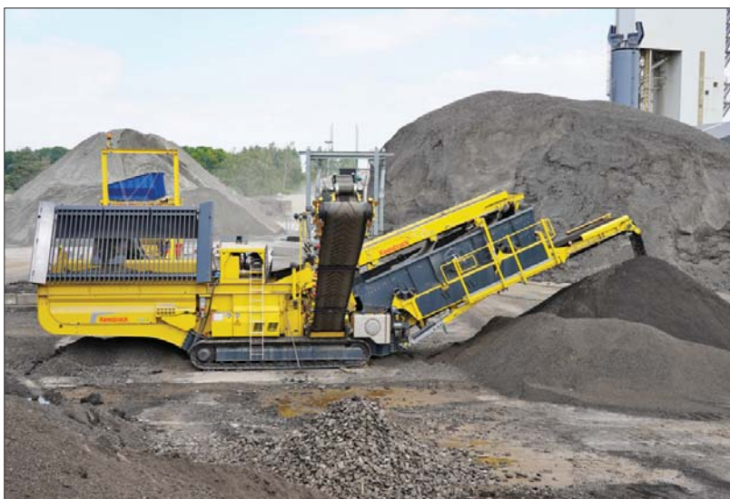
△ Do obróbki destruktu asfaltowego używa się trójpokładowego przesiewacza Keestrack C6e z napędem elektrycznym
