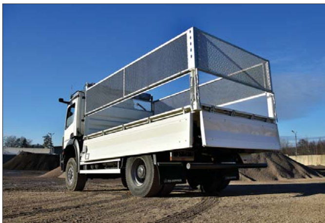
△ Ciekawą propozycją w ofercie KH-KIPPER jest zabudowa do transportu odpadów pochodzących z selektywnej zbiórki, na przykład makulatury, tworzyw sztucznych, szkła czy liści
