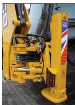
△ Dostępne w modelach z serwomechanizmem stabilizatory mają teraz funkcję automatycznego podnoszenia
