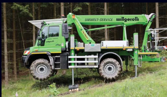
▲ Oprócz stosunkowo małej masy system teleskopowy podestu P 250BK zapewnia największy wysięg w tej klasie urządzeń
