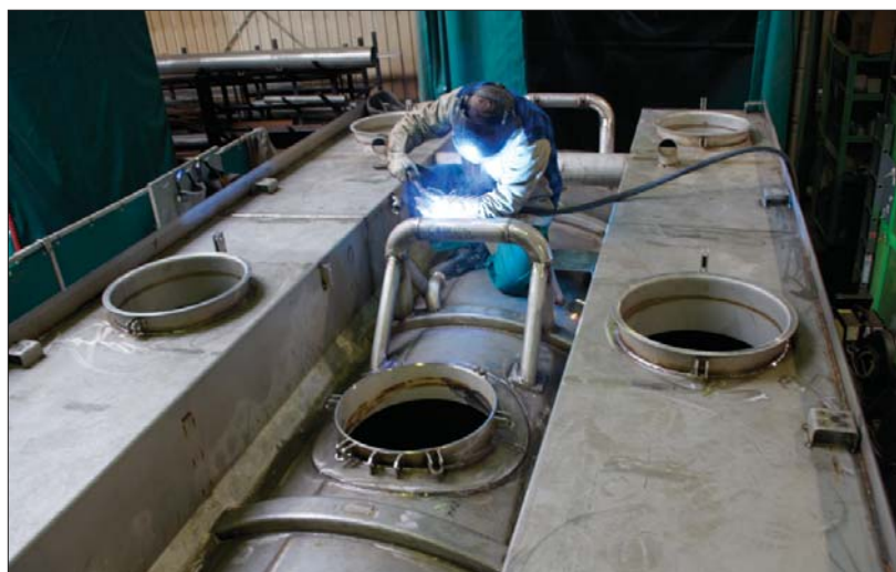
▽ Montaż osprzętu armatury, włączy rewizyjne i kołnierze, do których przyjdą zawory lub przepustnice
