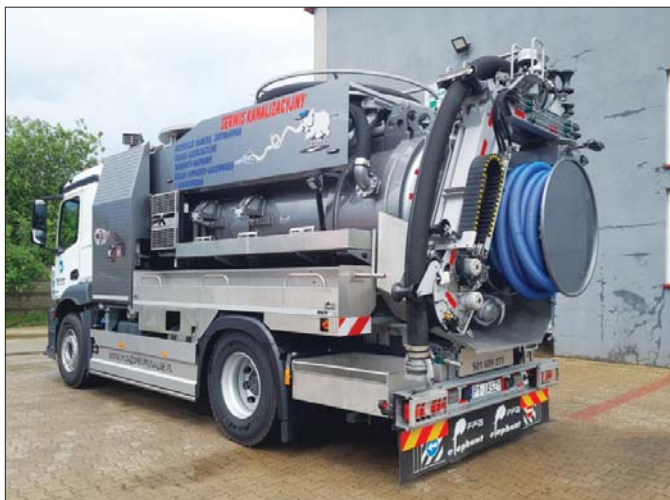
△ Usytuowanie kołowrotu na szczycie cysterny w tylnej jej części, pozwala uzyskać optymalne rozłożenie masy. Poprawia to bezpieczeństwo jazdy i wydłuża czas eksploatacji pojazdu
