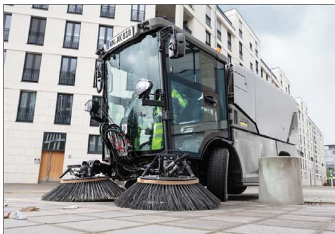
△ Mimo kompaktowych wymiarów model MC 250 ma zbiornik o pojemności aż 2,2 m 3 , co znacznie zwiększa interwały zmiatania
