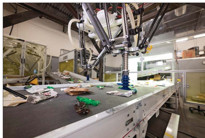
△ Roboty sortownicze AMP Robotics bez trudu wydodrębniają ze strumienia odpadów między innymi butelki PET z podziałem na różne kolory, brązowy i biały papier, opakowania foliowe, plastik i wiele innych
