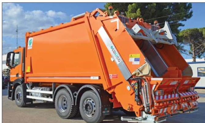
△ Dwukomorowa śmieciarka COSECO wyróżnia się zabudową z równym podziałem komór na poszczególne frakcje odpadów. Dzięki temu możliwe jest jednoczesne opróżnianie dwóch pojemników o pojemności 1.100 litrów
