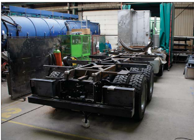
△ W pierwszym etapie powstawania specjalistycznej zabudowy odbywa się przygotowanie podwozia
