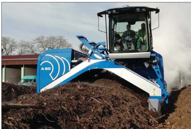
△ Backhus A50 przystosowany jest do pracy z przymami o maksymalnej wysokości 2,4 metra oraz szerokości 5 metrów. Natomiast jego maksymalna wydajność wynosi 4.000 m³ na godzinę
