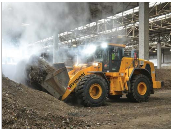
△ Praca w trudnych warunkach sortowni odpadów powodowanych dużym zapyleniem wymaga stosowania dodatkowej ochrony systemu wentylacji kabiny i układu chłodzenia
