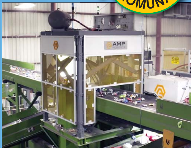
△ Roboty firmy AMP Robotics wyręczają ludzi w sortowniach, nie męczą się i mogą pracować z tą samą wydajnością cały czas
