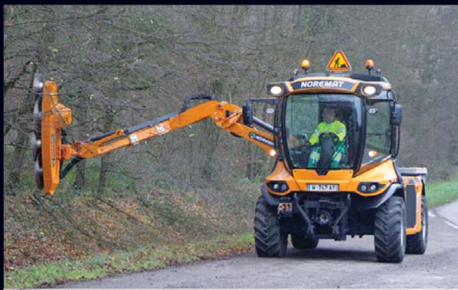
△ Różnorodność osprzętu roboczego umożliwia maszynie wykonanie wielu czynności związanych z utrzymaniem zieleni
