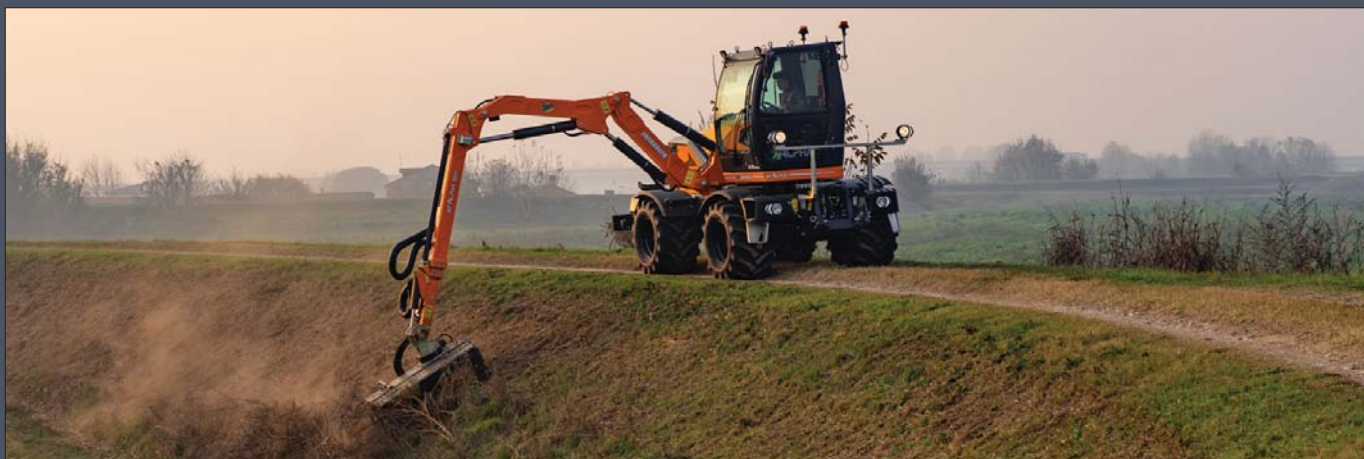
▲ Dwunastometrowe ramię wysięgnika umożliwia koszenie skarp o dużym stopniu nachylenia i długości
